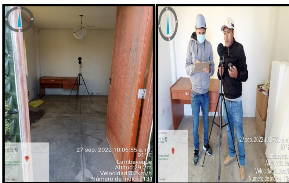
Figura 12: Medición de ruido con la cubierta vegetal instalado
