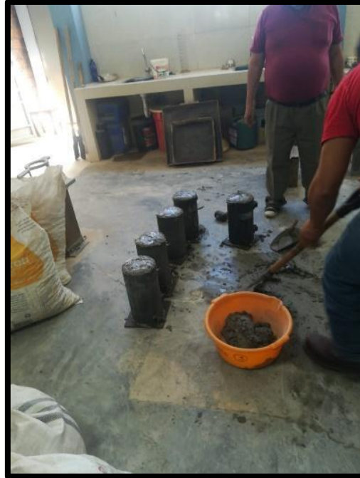
Preparación del concreto en los moldes cilíndricos.
