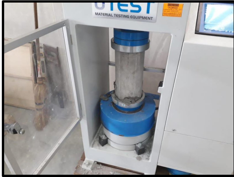
Rotura de probetas
