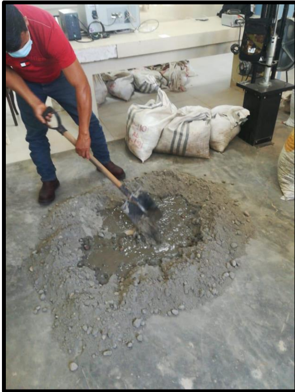
Preparación de la mezcla patrón para determinar la consistencia o fluidez (Slump)
