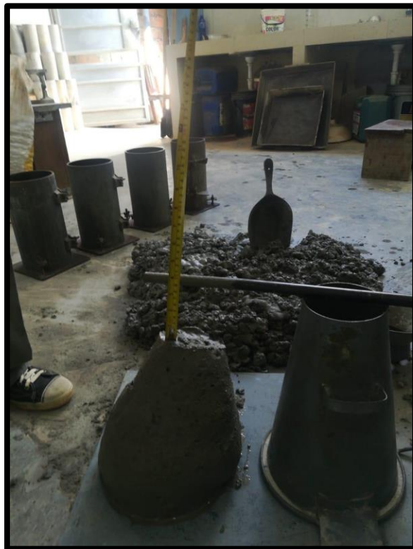
Determinación del SLUMP del diseño de mezcla patrón
