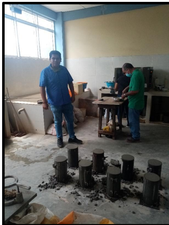
Empezando a elaborar las probetas, en los moldes cilíndricos.
