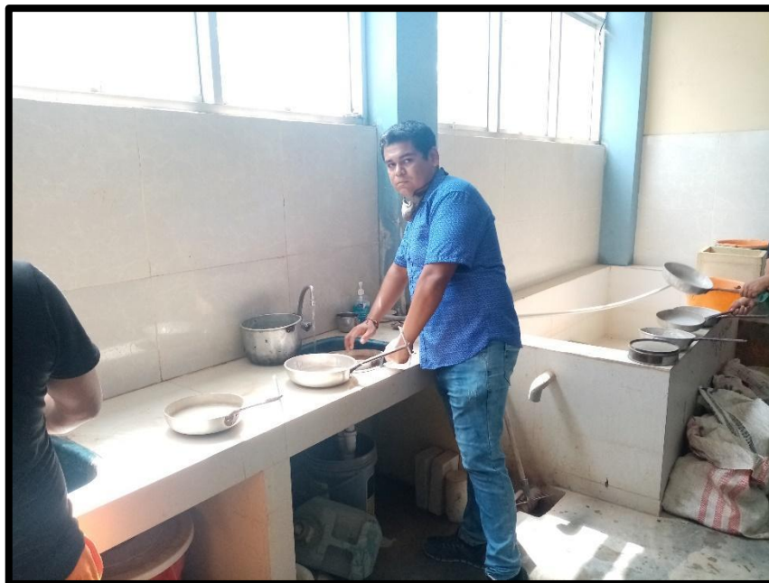
Lavado de los agregados tanto el fino como el grueso.
