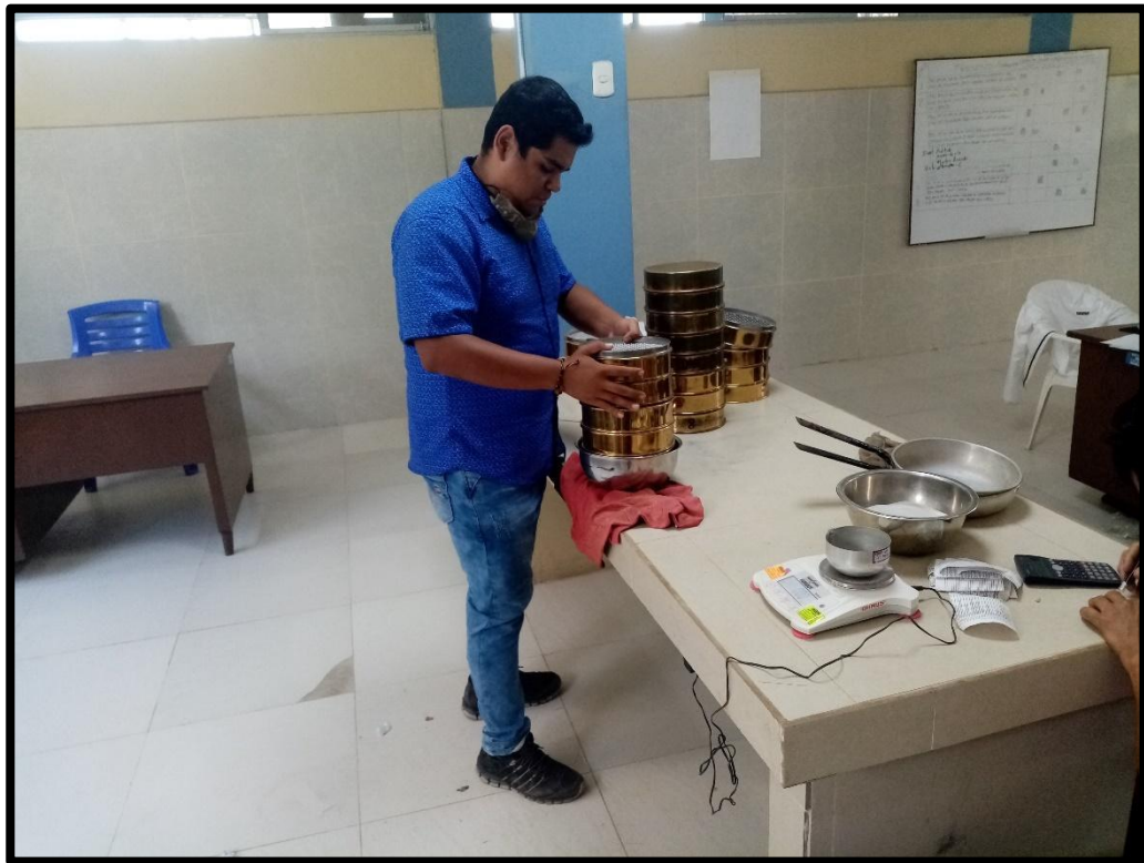
Tamizado del agregado grueso para ensayar la granulometría.
