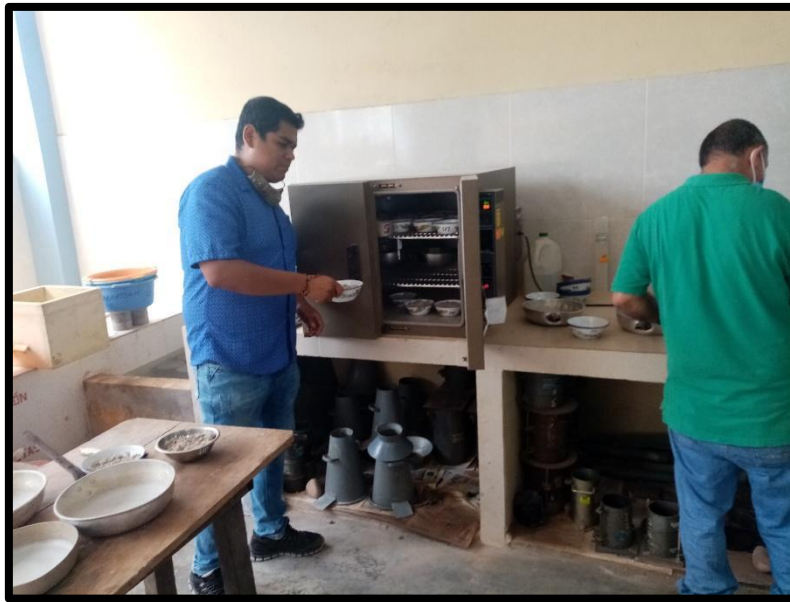
Selección de agregado grueso y agregado fino para ubicarlos al horno a una temperatura de 110°C
