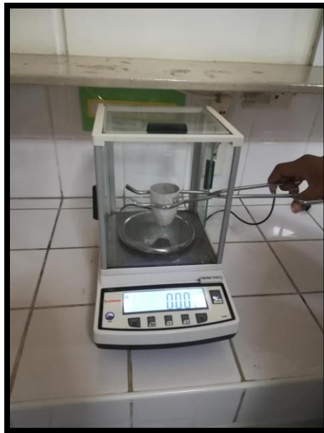
Figura 15. Peso de la muestra a 550°C. Fuente: Elaboración Propia.
