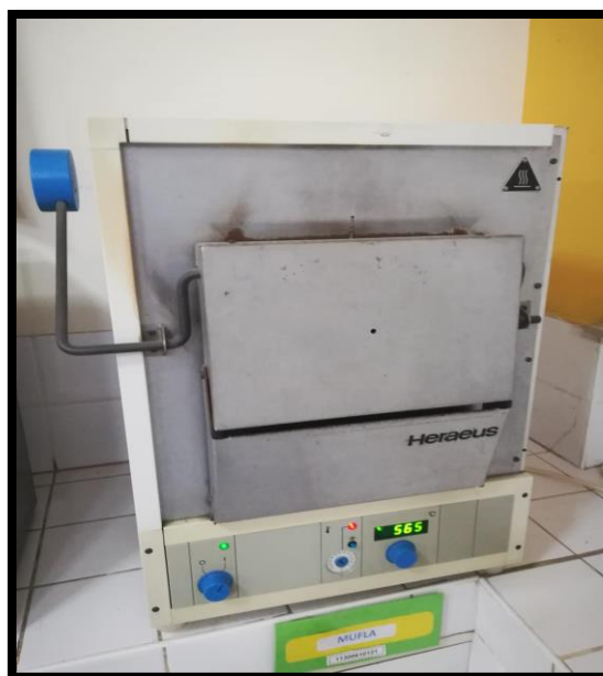
Figura 13. Mufla programada a 550°C. Fuente: Elaboración Propia.
