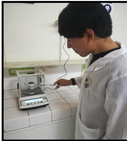
Figura 11. Pesaje de la muestra después de 1 hora en el horno eléctrico. Fuente: Elaboración Propia.
