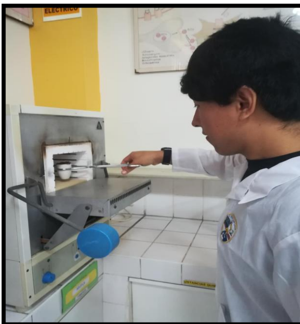
Figura 12. Ingreso de la muestra a la mufla (para el proceso de calcinación). Fuente: Elaboración Propia.
