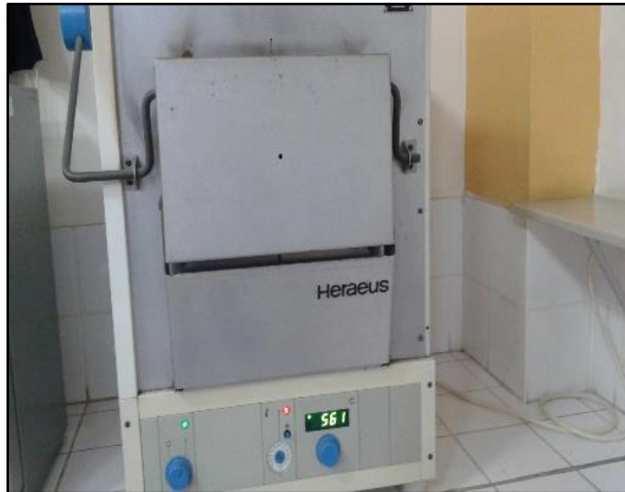
Figura 36 Mufla del laboratorio de bioquímica
