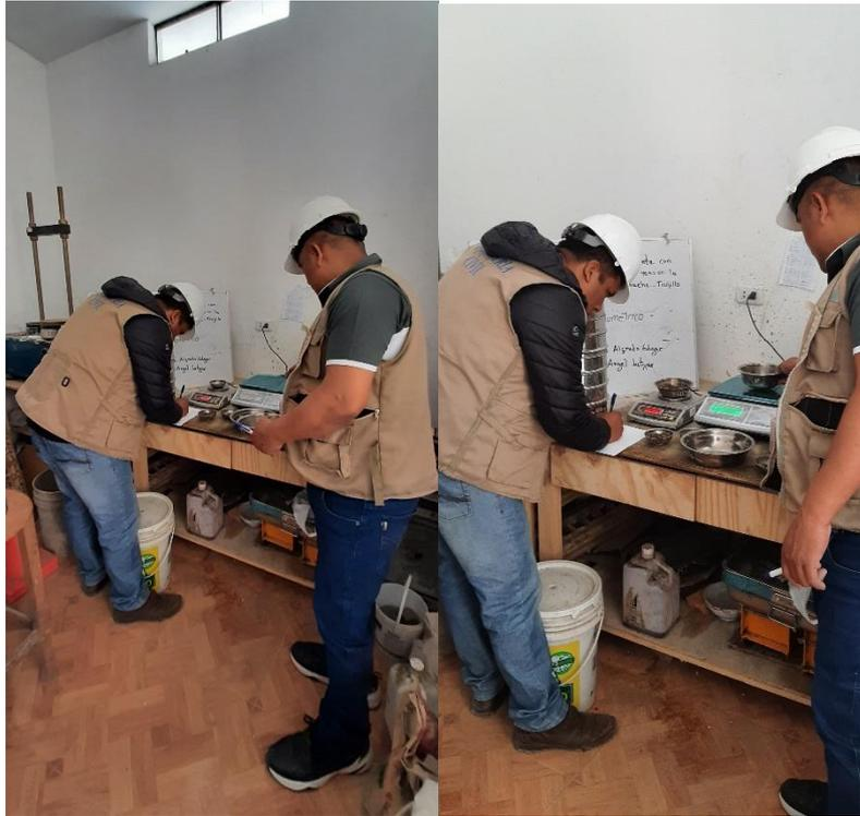
*Toma de pesos del ensayo de granulometría muestra natural de suelo sin tratamiento, Laboratorio LEMS W&C EIRL., distrito de Pimentel, Chiclayo*
