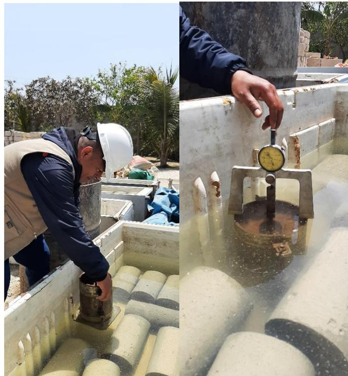
*Análisis de Capacidad de soporte de California CBR sumergido de la muestra de suelo con tratamiento, Laboratorio LEMS W&C EIRL., distrito de Pimentel, Chiclayo*
