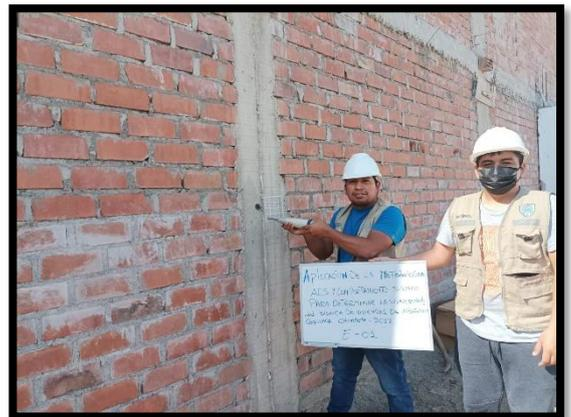
EN LAS TOMAS FOTOGRÁFICAS SE APRECIA EL ENSAYO DE ESCLEROMETRIA METODO A PARA COLUMNAS DE CONFINAMIENTO.
