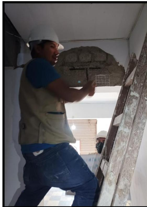
EN LAS TOMAS FOTOGRÁFICAS SE APRECIA EL ENSAYO DE ESCLEROMETRIA METODO A PARA VIGAS Y LOSAS.
