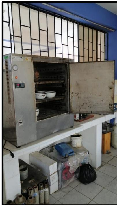
EN LAS TOMAS FOTOGRÁFICAS SE APRECIA EL ENSAYO DE GRANULOMETRIA Y CONTENIDO DE HUMEDAD
