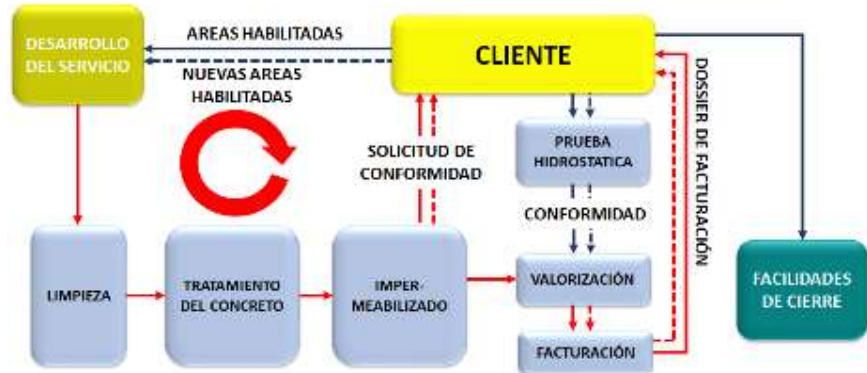
Figura 32- Procesos del Desarrollo del Servicio de la empresa ASCLA Soluciones y Servicios
