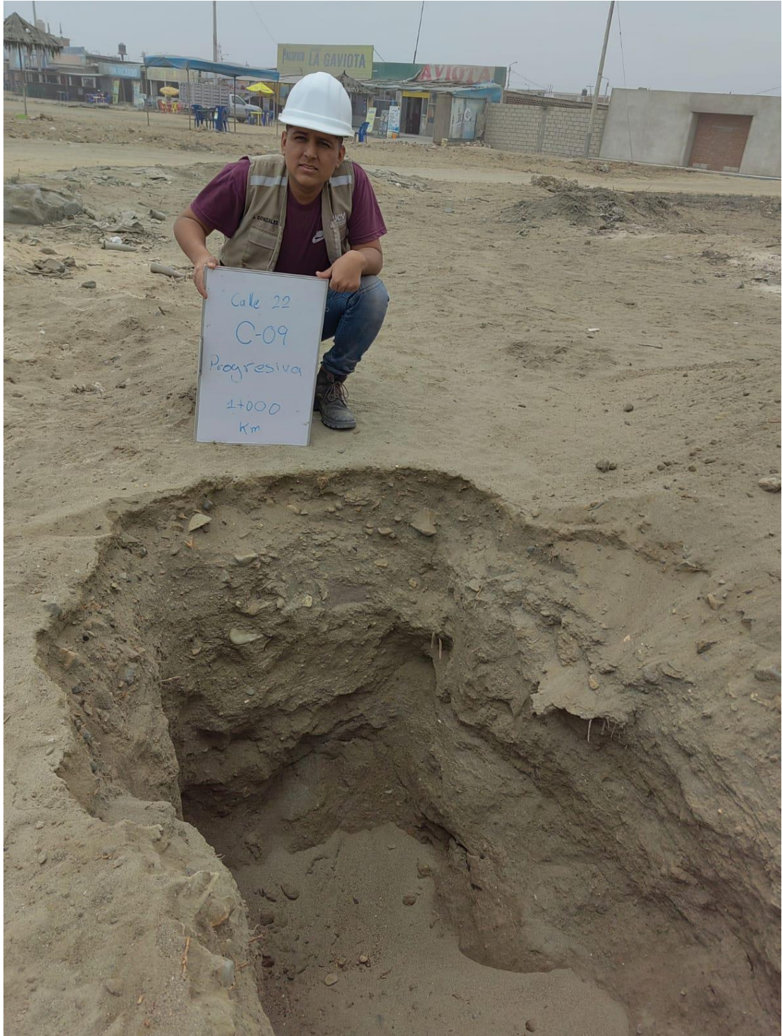
Imagen 34. Calicata - 09, progresiva 1+000 Km
