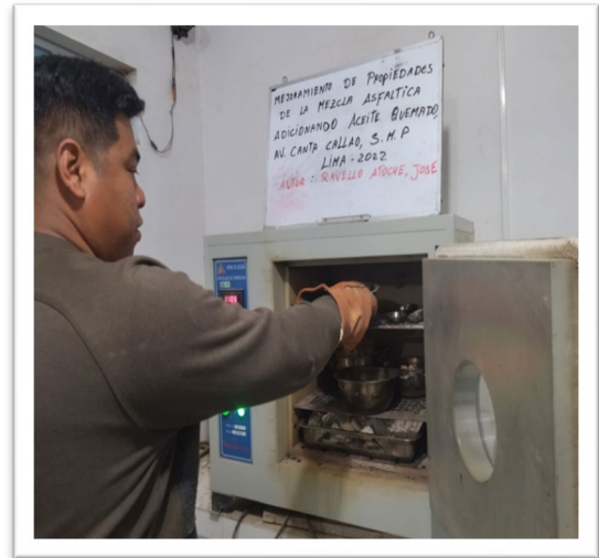
Figura 28. Mezcla asfáltica a temperatura de 145°C a 150°C. Fuente: Elaboración propia
