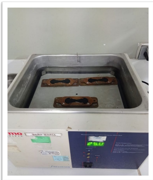
Fotografía 31. Control de calidad del asfalto con el aceite quemado.
