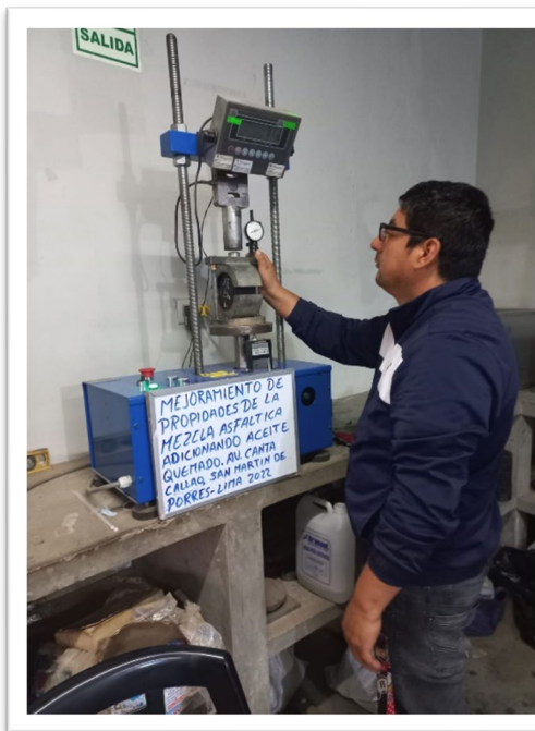
Fotografía 41. Ensayos para hallar la estabilidad y flujos.
