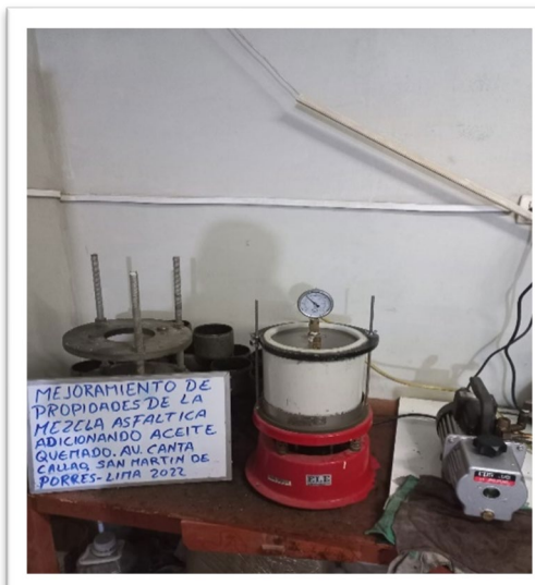
Fotografía 43. Determinación de gravedad específica y densidad en materiales asfálticos.
