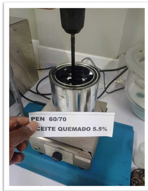
Fotografía 28. Mezclado de asfaltó modificado con aceite quemado 5.5%.
