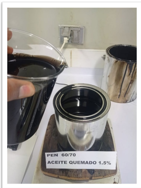
Fotografía 23. Asfaltó modificado con aceite quemado 1.5%
