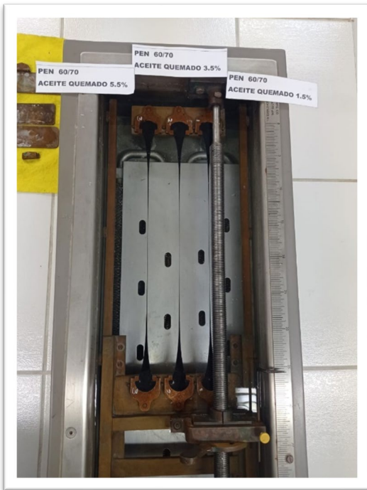
Fotografía 33. Control de calidad del asfalto con el aceite quemado.
