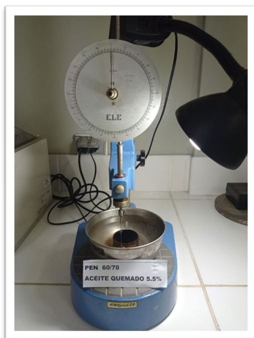
Fotografía 36. Control de calidad del asfalto con el aceite quemado.
