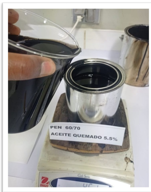
Fotografía 27. Asfaltó modificado con aceite quemado 5.5%.
