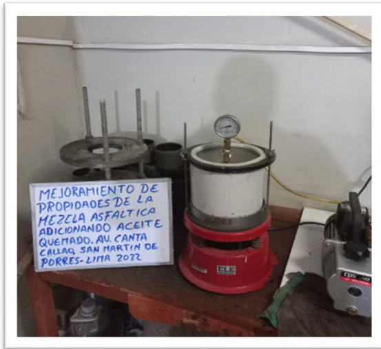
Figura 27. Determinación de Gravedad específica y densidad en materiales asfálticos Fuente: Elaboración propia
