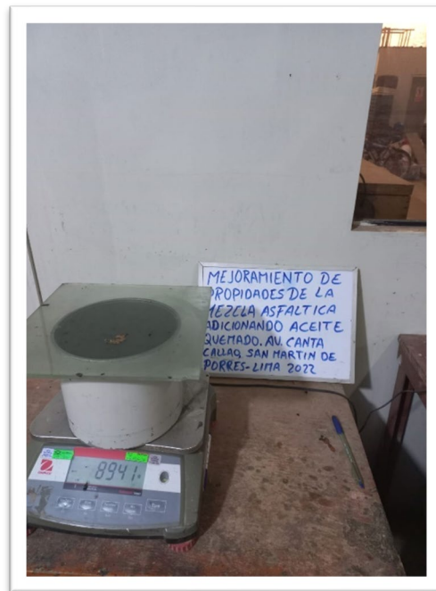
Fotografía 42. Determinación de gravedad específica y densidad en materiales asfálticos.
