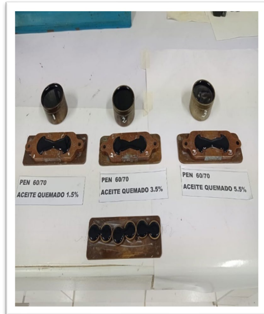
Fotografía 30. Control de calidad del asfalto con el aceite quemado.
