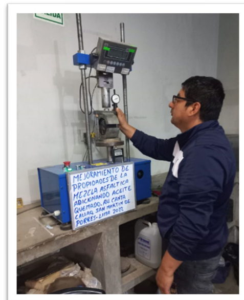
Figura 25. Ensayo para hallar la estabilidad.
