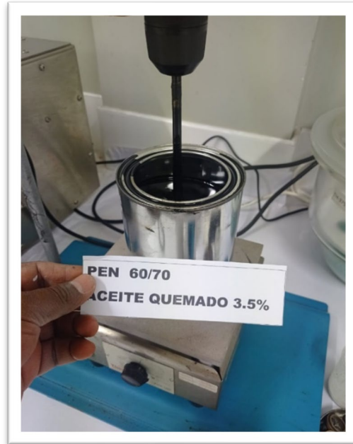
Fotografía 26. Mezclado de asfaltó modificado con aceite quemado 3.5%.
