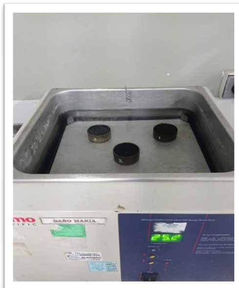
Fotografía 32. Control de calidad del asfalto con el aceite quemado.
