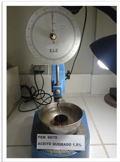
Fotografía 34. Control de calidad del asfalto con el aceite quemado.
