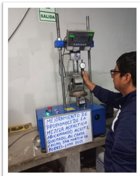
Figura 24. Ensayo para hallar el flujo.
