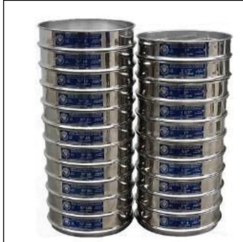
*Figura 9. Tamices según la norma ASTM D422.*
