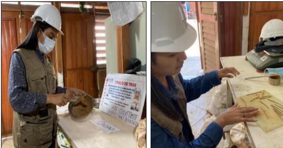
*Figura 29. procedimiento del ensayo de límite plástico.*
