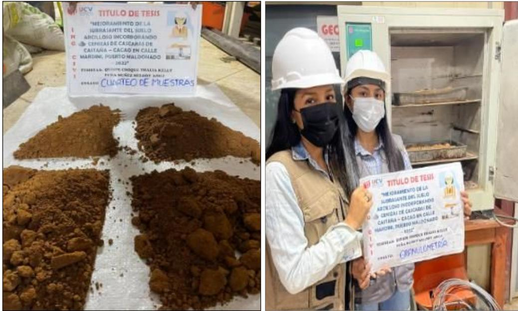
Figura 41. Cuarteo de las muestras extraídas de las calicatas para realizar el ensayo de granulometría
