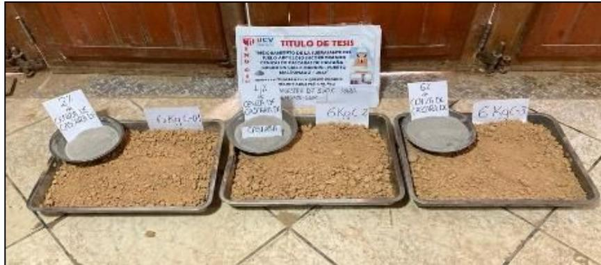
Figura 153. Mezcla del suelo natural con las adiciones de cenizas de cascara de cacao.
