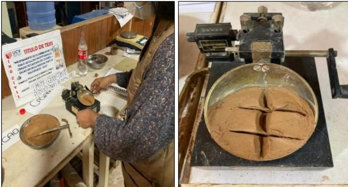
*Figura 28.* procedimiento del ensayo de limite liquido (Casagrande).
