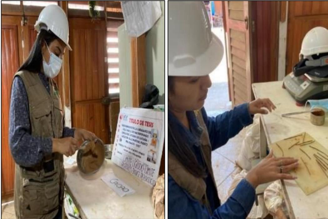
Figura 73. procedimiento del ensayo de limite plástico
