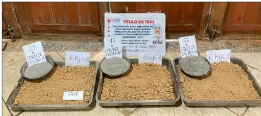
Figura 154. Compactación del suelo natural con las adiciones de cenizas de cascara de cacao - castaña.
