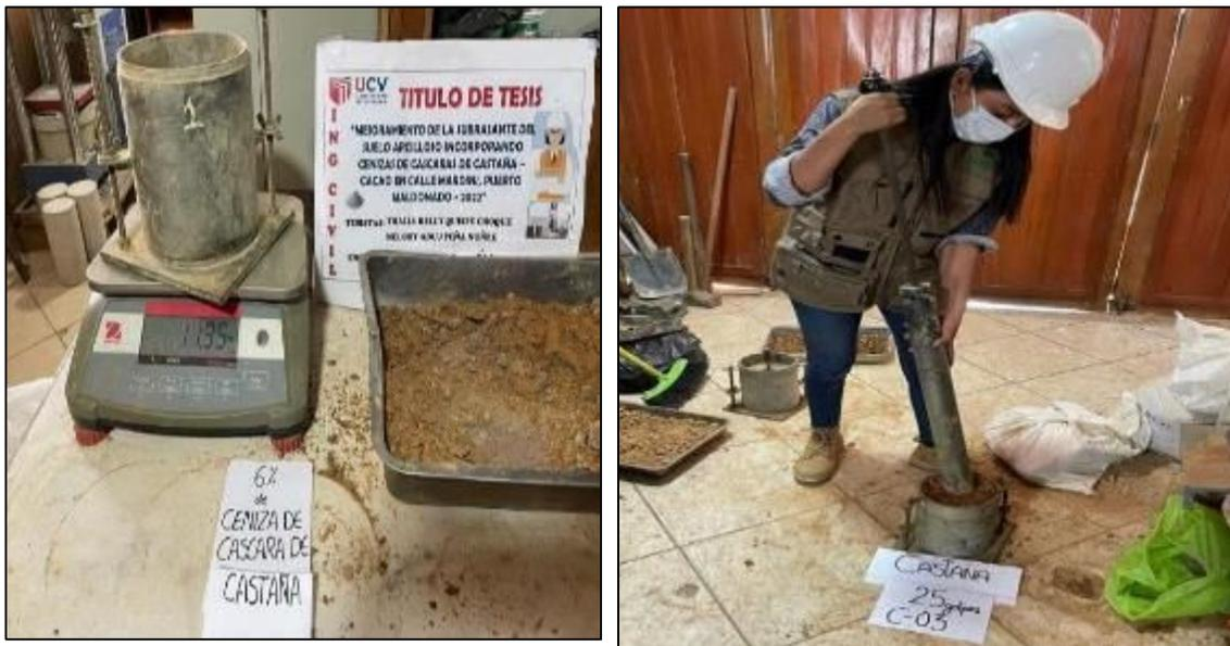
Figura 30. Compactación y pesado del ensayo de Proctor Modificado.
