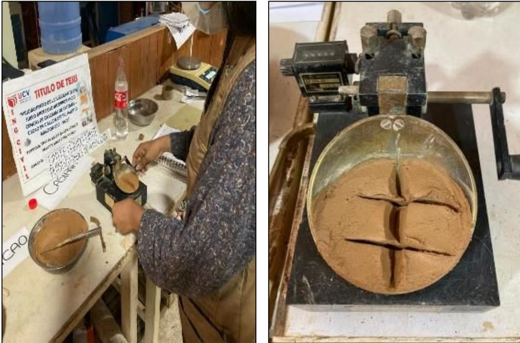
*Figura 72. procedimiento del ensayo de limite liquido (Casagrande).*
