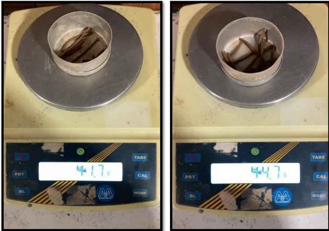
Ensayo para la determinación del contenido de humedad natural.
