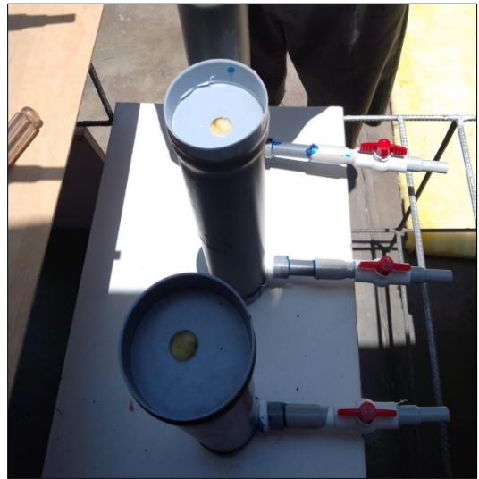
Armado de filtros más llaves de paso
