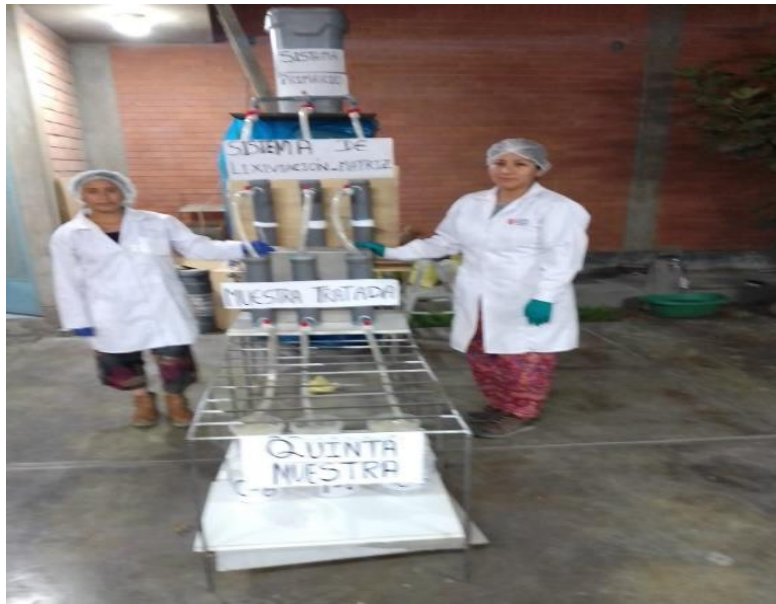
Armado del sistema de columnas de lixiviación con matrices
