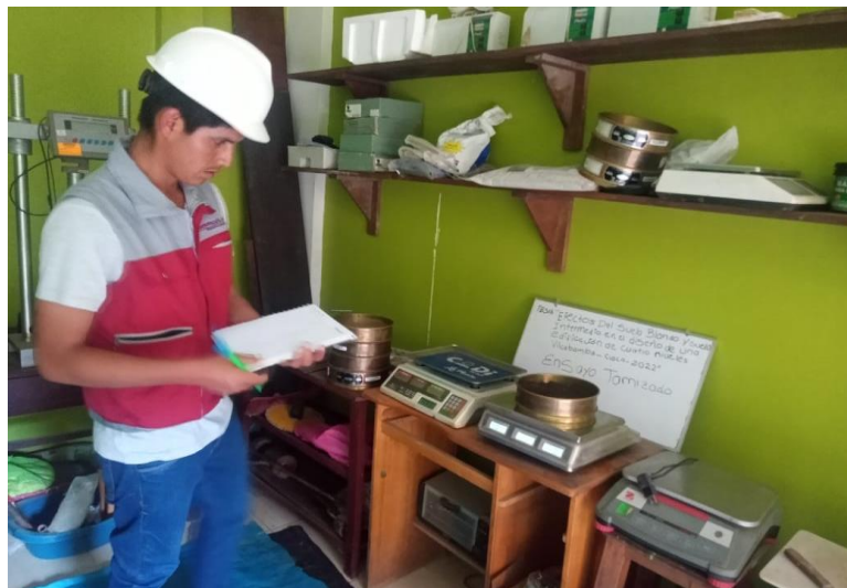
Figura 11. Toma de datos del material tamizado.
