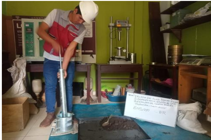
Figura 12. Compactación del material para poder ver la humedad y densidad del material
