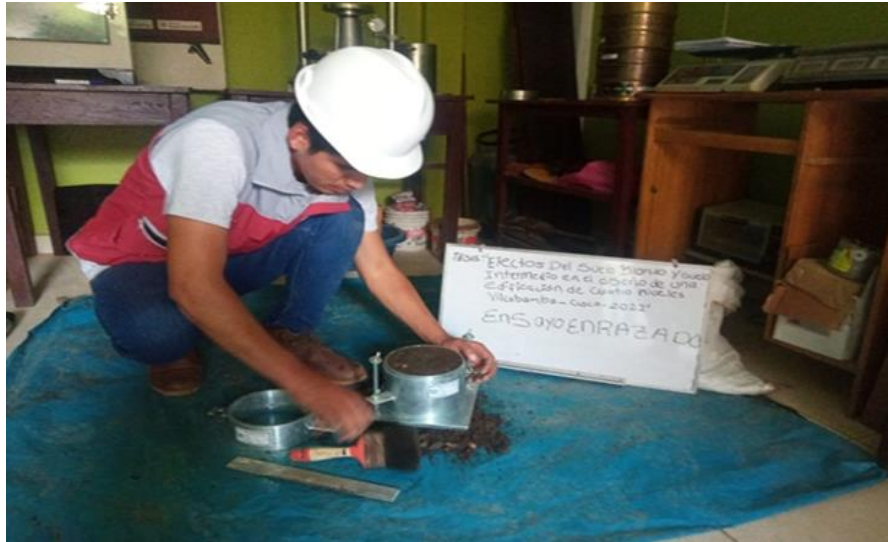
Figura 14. contenido de humedad y curva de compactación.
