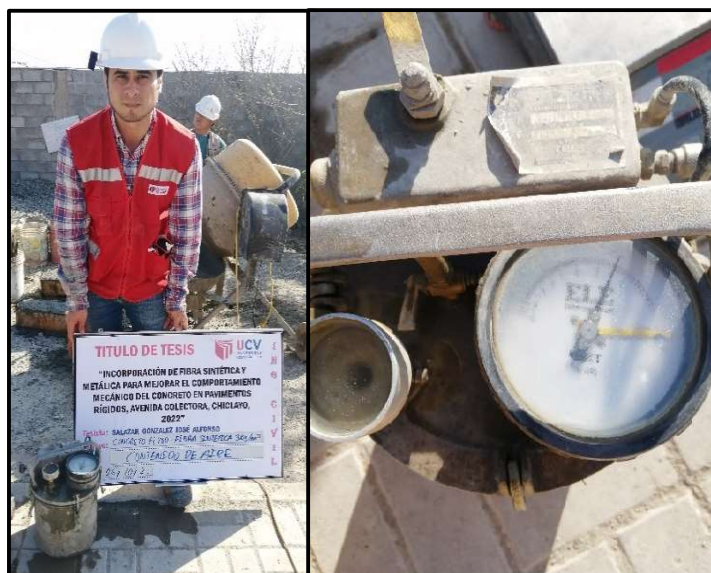
Figura 28. Ensayo contenido de aire del concreto
