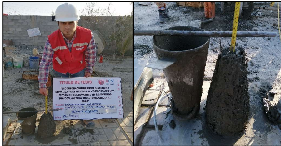
Figura 26. Ensayo del asentamiento del concreto.
