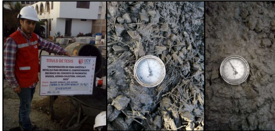
Figura 30. Ensayo de temperatura del concreto fresco.
