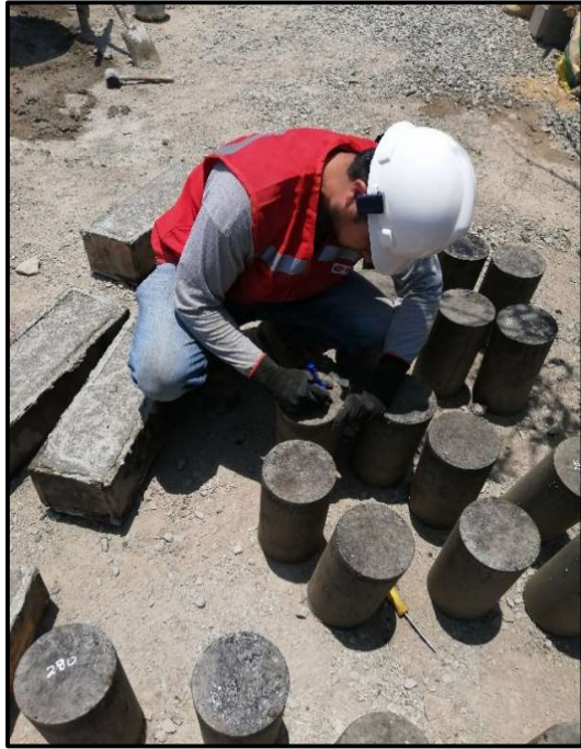
Desencofrado de probetas.
