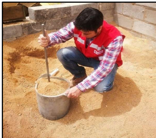
Figura 21. Compactación del AF para ensayo de Peso unitario compactado
