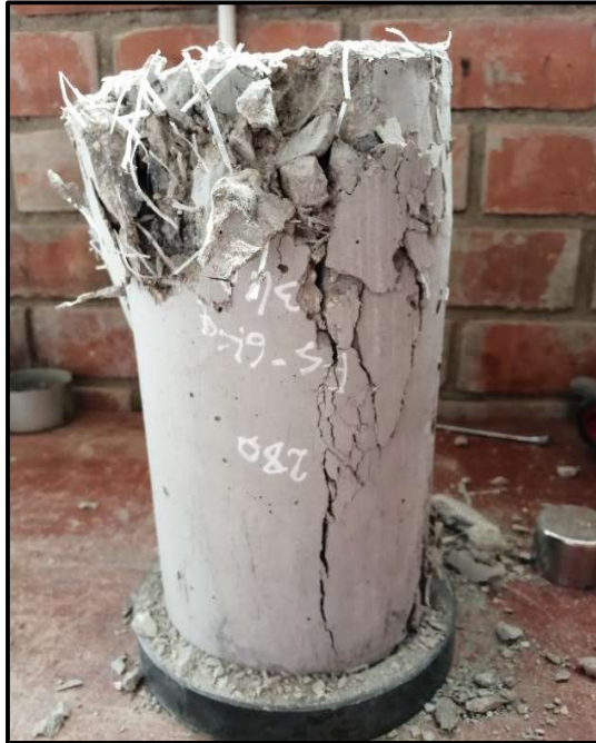
Rotura de Probeta FS-6KG F'C=280 Falla tipo III
