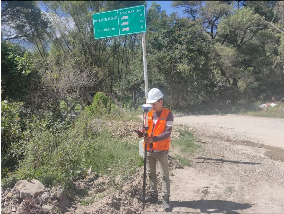
Figura 8. Levantamiento topográfico con GPS diferencial
