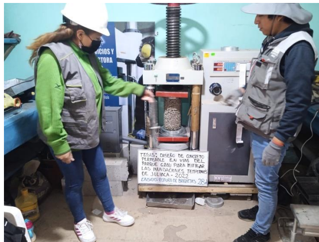
Fotografía 20: Ensayo de rotura de briquetas de concreto permeable para la determinación del ensayo a la compresión, con un tiempo de 28 días de su moldeado
