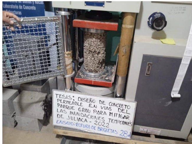
Fotografía 21: En la Fotografía se muestra la briqueta después de la exposición en el equipo de rotura al esfuerzo a la compresión a los 28 días después del moldeado de la briqueta de concreto permeable
