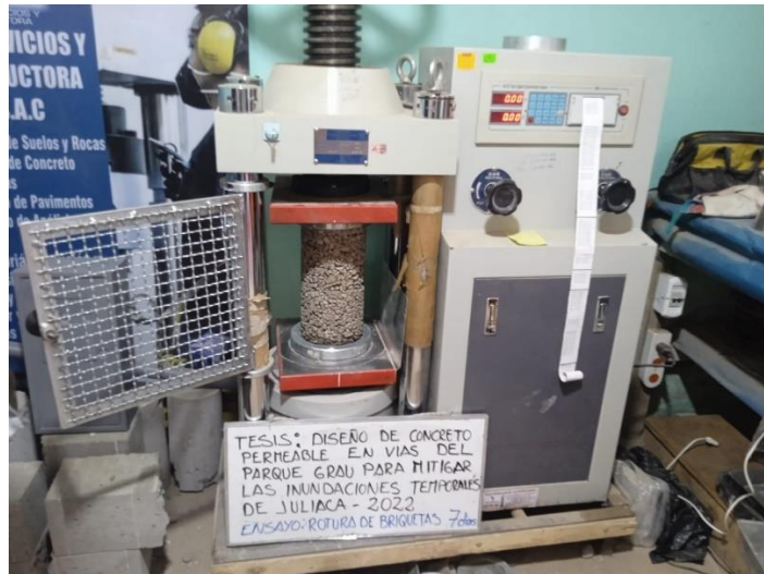
Fotografía 19: Equipo para la determinación de los ensayos de rotura de briquetas sometidas a compresión del concreto permeable
