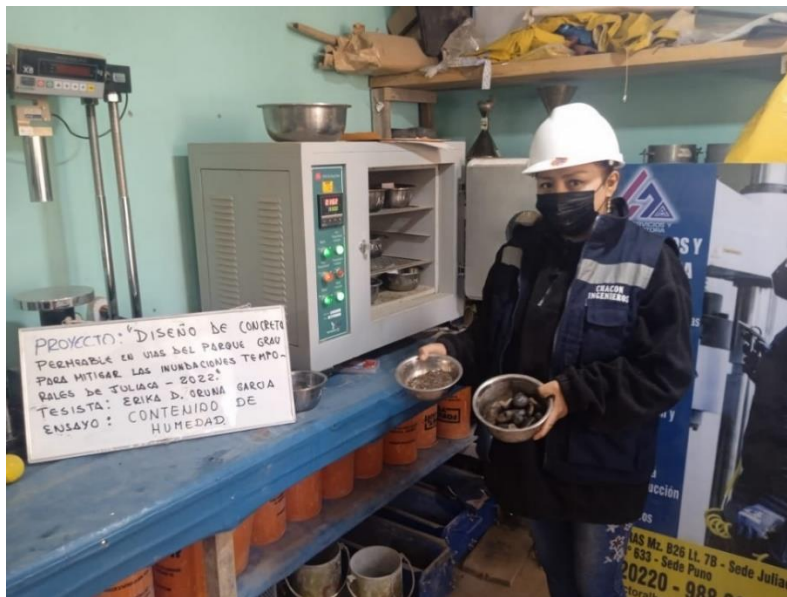
Fotografía 8: Muestras clasificadas para la determinación del contenido de humedad en el horno con ventilación según lo normado.
