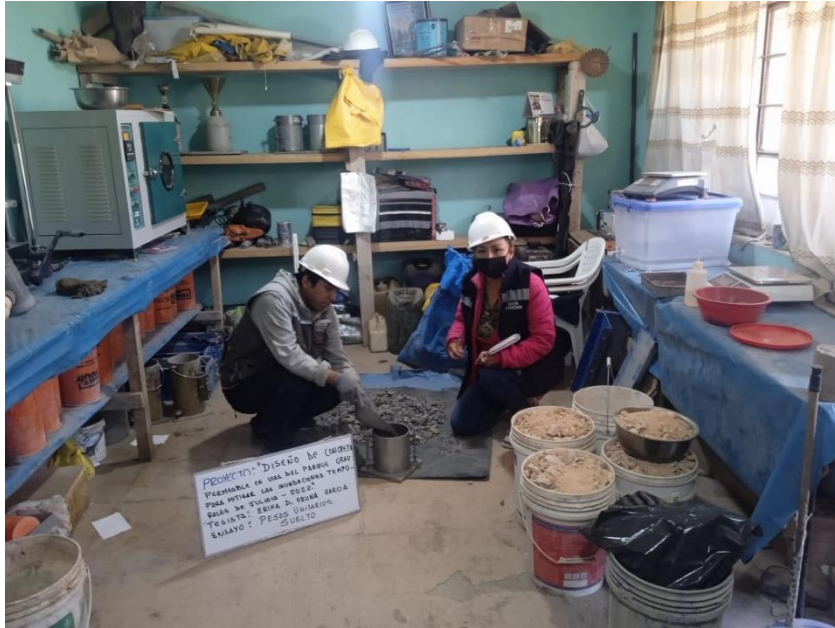
Fotografía 11: Ensayos de Determinación de pesos unitarios sueltos de los agregados.
