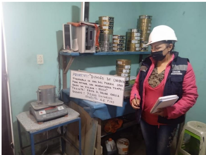
Fotografía 14: Ensayos de Determinación de pesos unitarios de los agregados.
