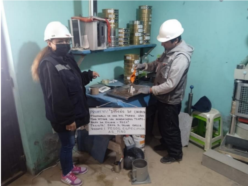
Fotografía 13: Ensayos de Determinación de pesos específicos de los agregados.
