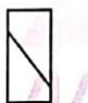
Tipo 4 Fractura diagonal en fisuras a través de los extremos, golpeo suavemente con un martillo para distinguirla del tipo 1.
