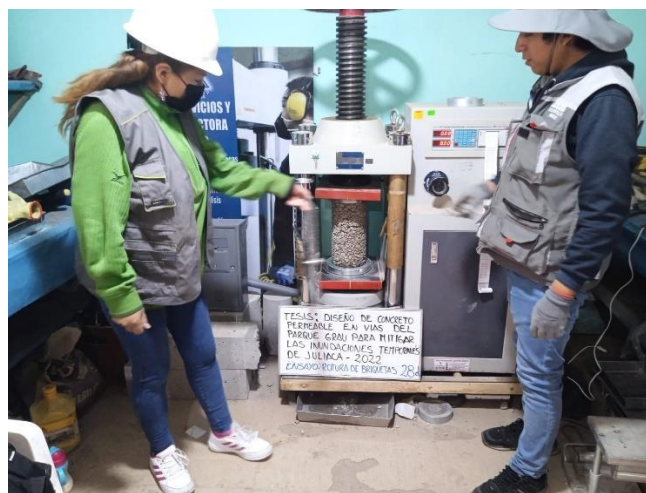
Fotografía 20: Ensayo de rotura de briquetas de concreto permeable para la determinación del ensayo a la compresión, con un tiempo de 28 días de su moldeado
