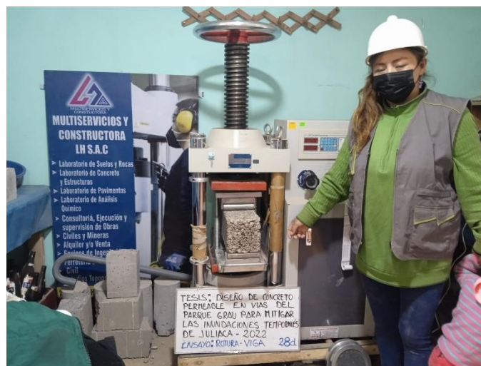
Fotografía 22: Ensayo de rotura de los testigos (prisma de concreto endurecido) de concreto permeable para la determinación del ensayo a la flexión, con un tiempo de 28 días de su moldeado
