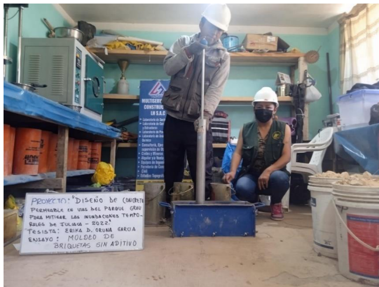
Fotografía 16: Moldeado y obtención de los testigos (vigas) para determinar la resistencia a la flexión del concreto permeable.
