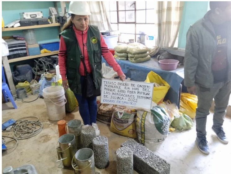
Fotografía 17: Desmoldeado de los testigos (vigas y briquetas) para determinar la resistencia a la flexión del concreto permeable.
