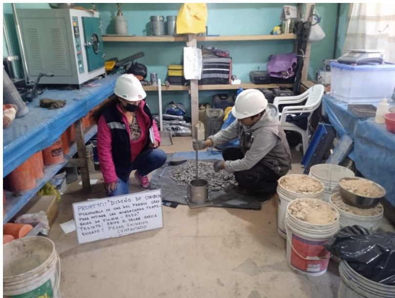
Fotografía 12: Ensayos de Determinación de pesos unitarios compactados de los agregados.
