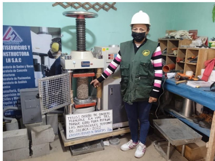
Fotografía 18: Ensayo de rotura de briquetas de concreto permeable para la determinación del ensayo a la compresión, con un tiempo de siete días de su moldeado
