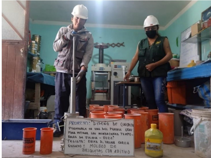
Fotografía 15: Moldeado y obtención de los testigos (briquetas) para determinar la resistencia a la compresión del concreto permeable.
