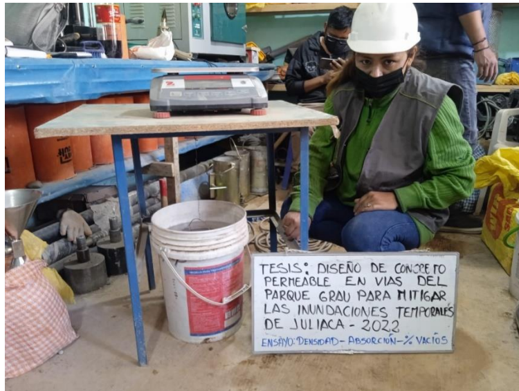
Fotografía 23: Ensayo de densidad – Absorción y porcentaje de vacíos. Para la determinación y cálculos de la porosidad
