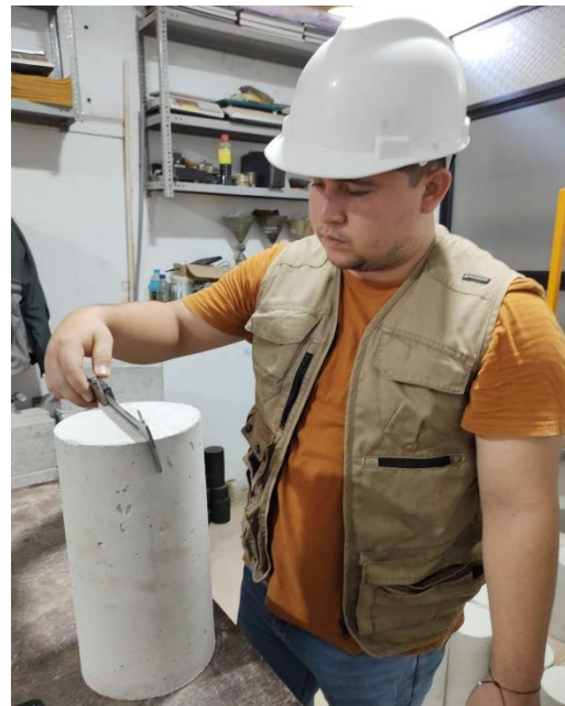
Efecto de la incorporación de los residuos de mampostería en la probeta de concreto
