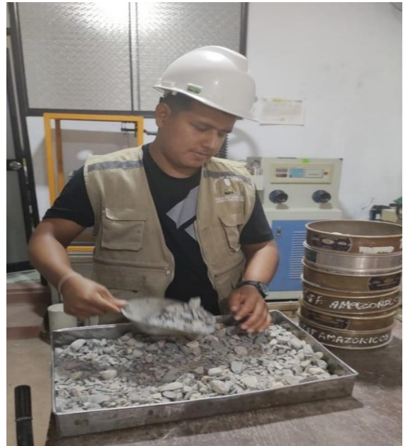
Evaluación y tamizaje de la grava teniendo en cuenta el peso de los agregados y los porcentajes que se retiene y los porcentajes que pasa por cada malla
