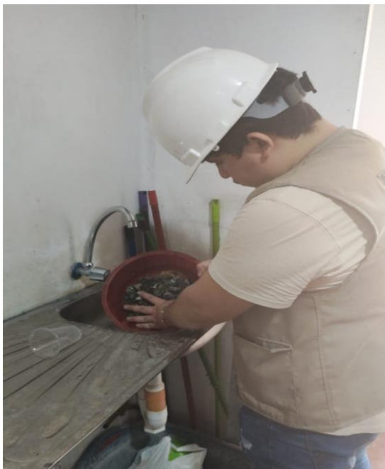
Lavado del agregado para posteriormente pasar por un proceso de eliminación de impurezas
