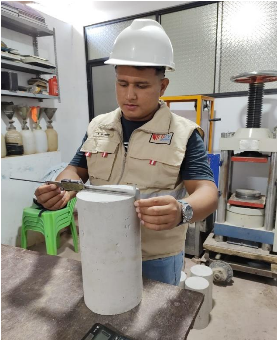
Mediadas del radio de las probetas y apunte de cada unidad para ver su comportamiento en la resistencia a la compresión.
