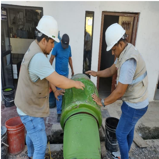
Dosificación del diseño de mezcla convencional sin adición de residuos de mampostería, diseño para 9 probetas
