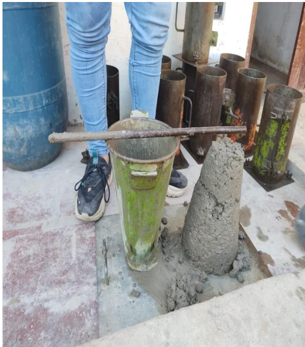
Realización de cada diseño de mezcla con el ensayo de slum para ver el grado de trabajabilidad con la incorporación de los residuos de mampostería
