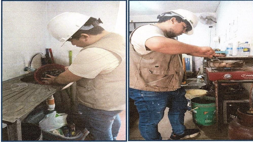
REALIZANDO EL LAVADO Y SECADO DE LOS AGREGADOS
