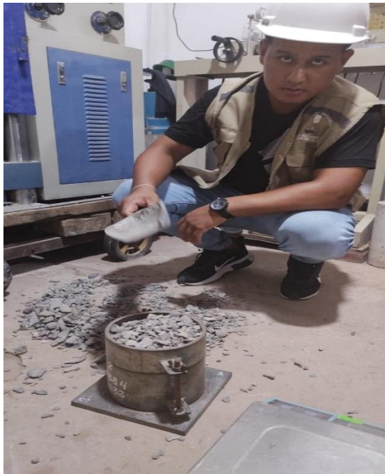
Ensayo de peso específico suelto de la grava de \frac{1}{2} y de la grava de \frac{3}{4} para el encaje de la curva granulométrica
