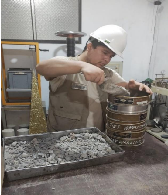
Evaluación del agregado grueso, grava de \frac{1}{2} y grava de \frac{3}{4} en el respectivo tamizaje de las mallas
