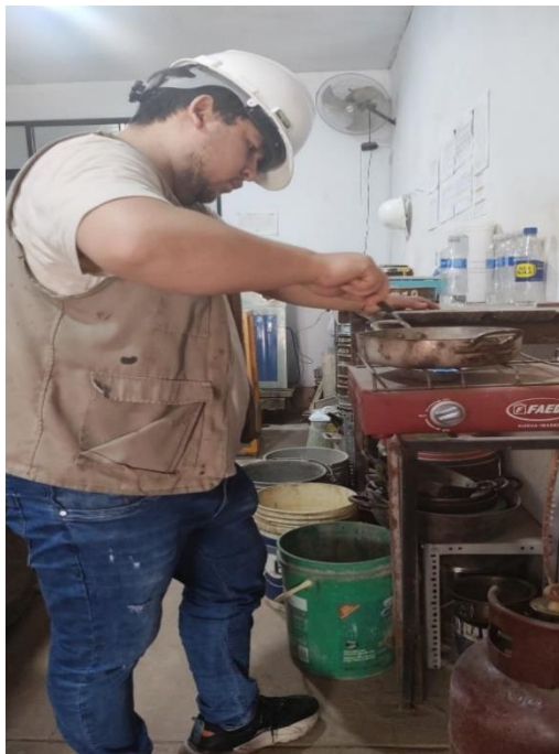
Proceso de calentamiento del material con la utilización una cocina para posteriormente ver el contenido de humedad
