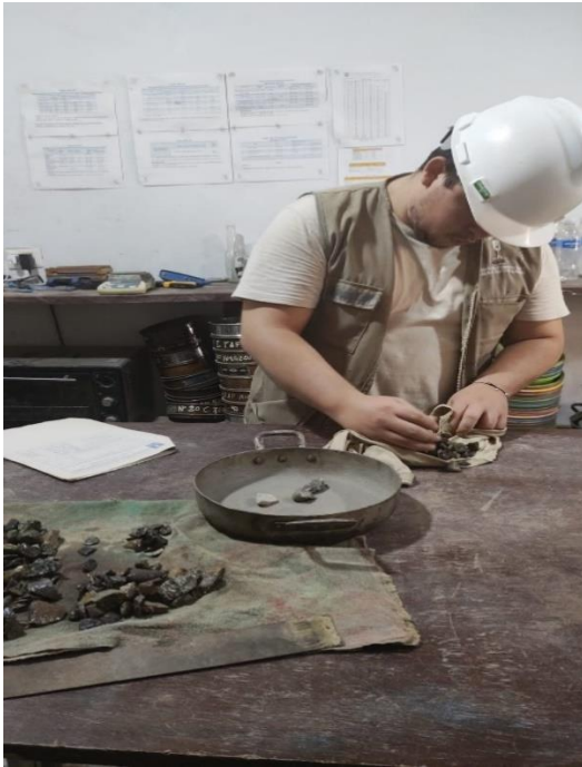
Secado del material grueso para posteriormente pasar a la selección de encaje de la curva granulométrica con los parámetros
