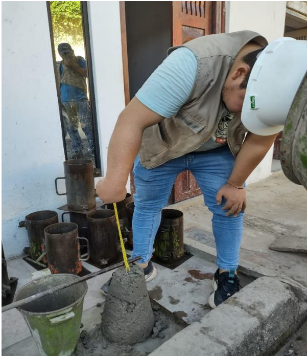
Se trabajo un slum de 2 a 4 para ver la trabajabilidad del concreto en el molde de las probetas
