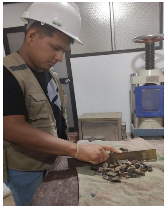
Cuarteo del agregado para trabajar de forma transeccional o forma de x para sacar el porcentaje de cada material seleccionado
