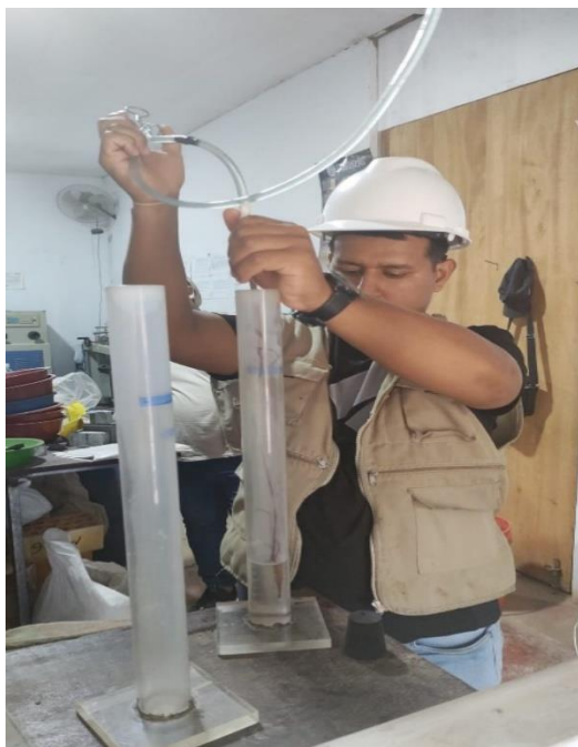
Ensayo de equivalente de arena para ver el porcentaje de fino y el grado de asentamiento del material
