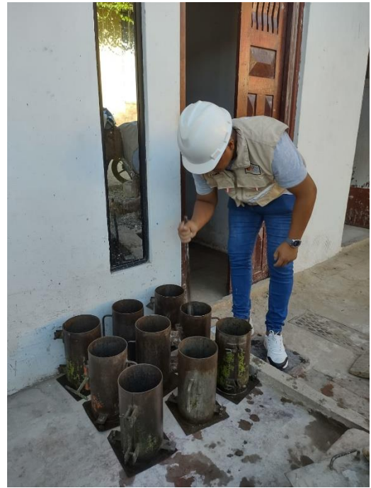
Llenado de la mezcla en los moldes de las probetas con sus respectivo chuseado de 25 golpes por 3 capas
