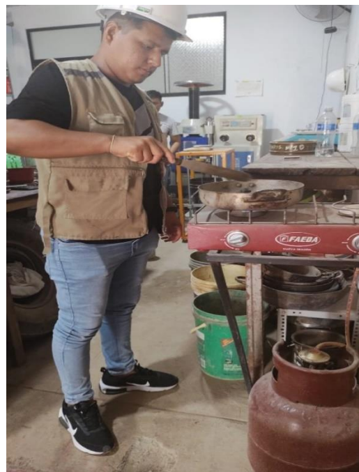
Ensayo de contenido de humedad del agregado fino para encajar en los parámetros de la norma
