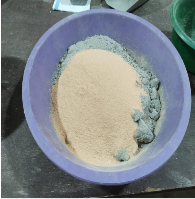
Recopilación del aditivo, residuo de mampostería para ver su efecto en el concreto mediante su resistencia a la compresión
