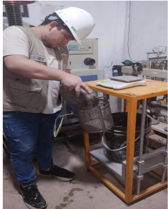
Peso específico del agregado fino para obtener el encaje de la curva granulométrica y ver el porcentaje que pasa y retiene
