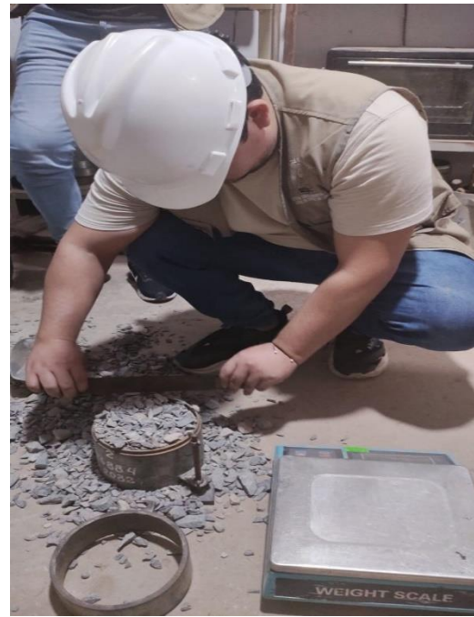
Ensayo de peso específico varillado de los agregados gruesos especificando de la grava con su respectivo procedimiento.
