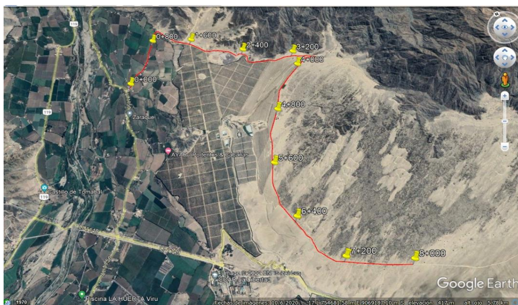
Figura 1. Trazo y colocación de puntos de extracción de calicatas tomadas en la vía de estudio
