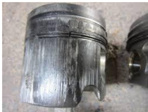
Figura 2. Puntos de contacto en pistones por altas temperaturas.
