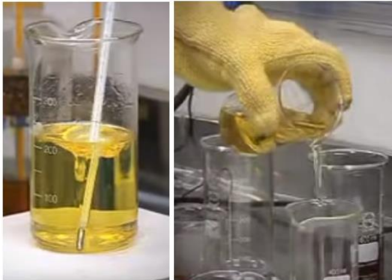
Figura N°13. Fluidez de aceite mineral a 100°C.
