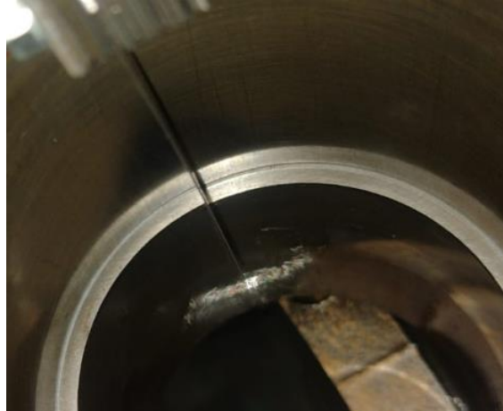
Figura 67. Verificación de luz de anillos.
