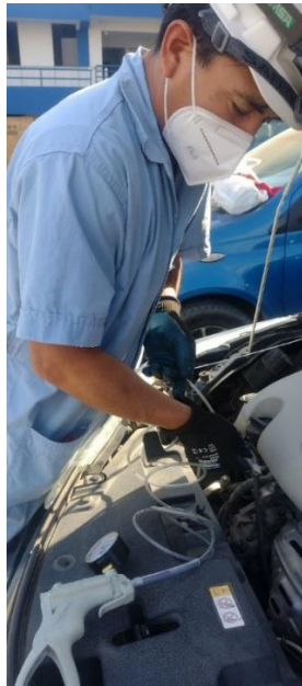
Figura 49. Ingreso de manguera para extracción de aceite de motor.
