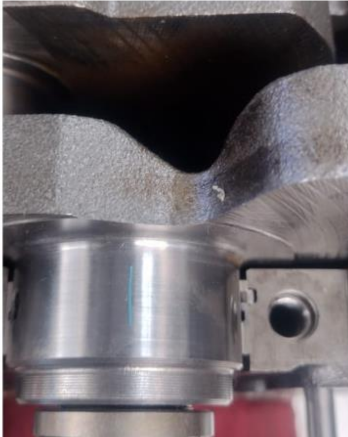
Figura 71. Verificación de luz de aceite usando el plastigey, en el conjunto móvil del motor 1NR-FE Toyota.
