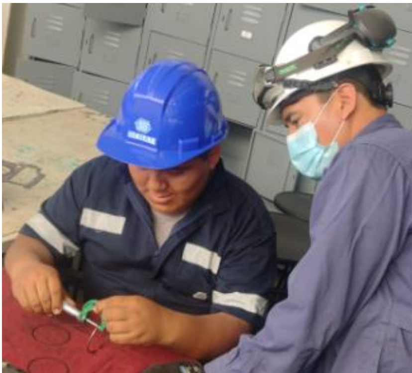
Figura 66. Verificación de espesor de anillos
