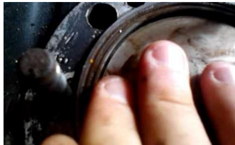
Figura 4. Desgaste de los cilindros por ludimientos del pistón.
