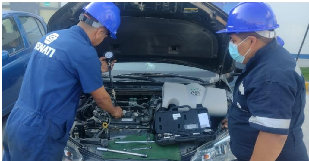
Figura 73. Instalación de equipo compresimetro con rango de 300 PSI.
