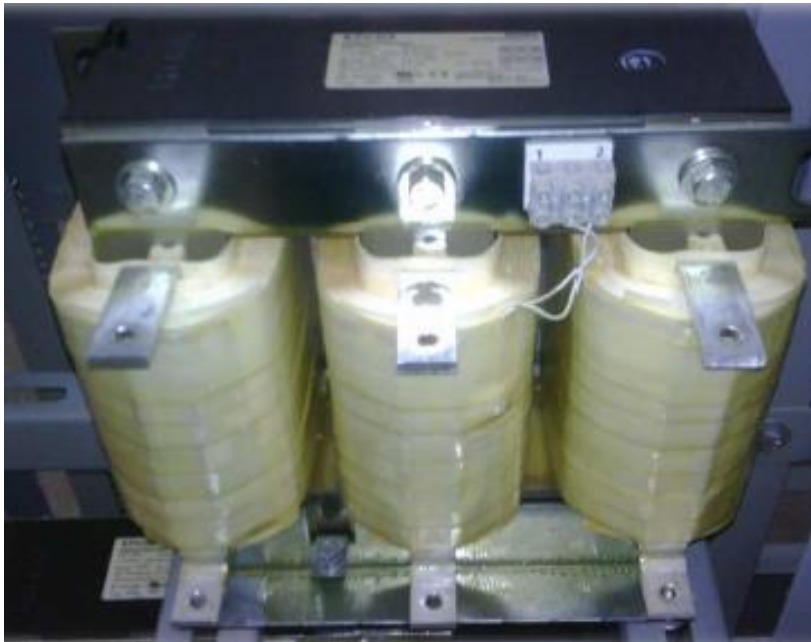
Figura 30: reactor inductivo trifásico
