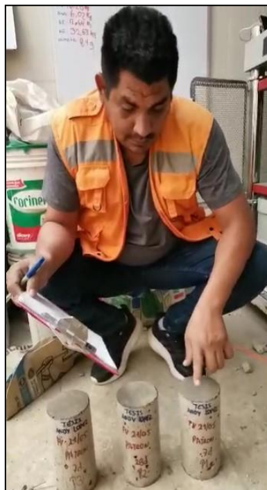
Figura9. Sacando las medidas antes de ser metida a la máquina para ver la compresión
