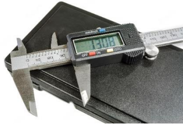
Figura 14: Vernier digital que es utilizado para medir las yemas maduras y turiones de esparrago.
