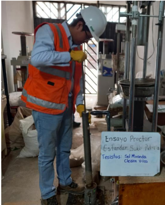
Fotografía 33. Ensayo de Proctor estándar: compactación con el martillo en suelo natural.
