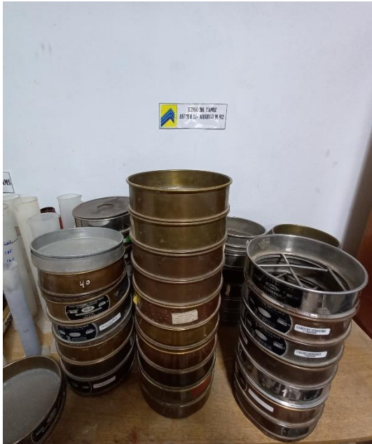
Fotografía 29. Juego de Tamices del laboratorio.
