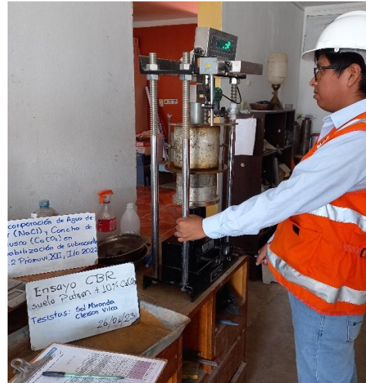
Fotografía 61: Colocación del espécimen de Suelo patrón + 10% \text{CaCO}_3 sobre la prensa de CBR para su lectura.
