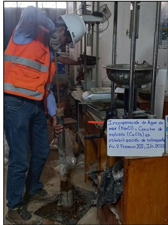
Figura 27. Compactación con el martillo en la muestra adicionada de NaCl.
