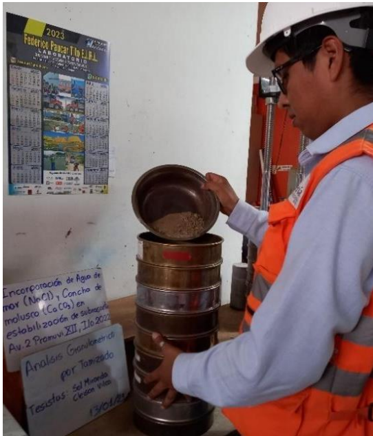
Fotografía 31. Ensayo de análisis granulométrico por tamizado de la muestra patrón.
