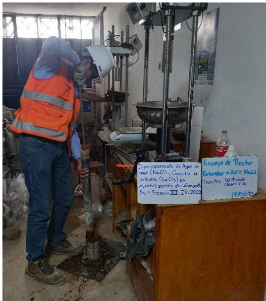
Fotografía 39. Golpes con el martillo, ensayo de Proctor estándar en el espécimen suelo natural + 2.50% NaCl
