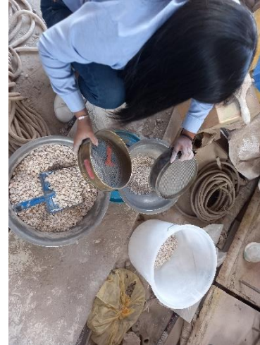
Figura 10. Tamizado de conchas trituradas.
