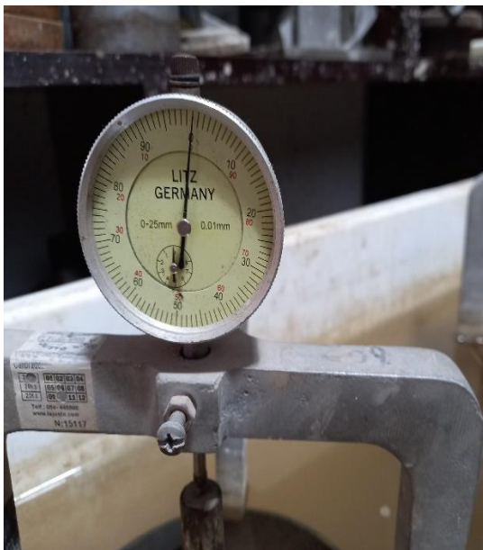
Figura 43: Manómetro leyendo que no tuvo expansión el suelo.
