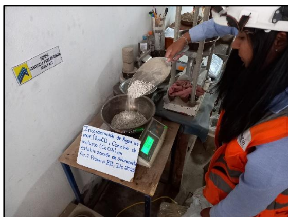
Figura 20. Pesado de las adiciones para combinar con el suelo patrón.
