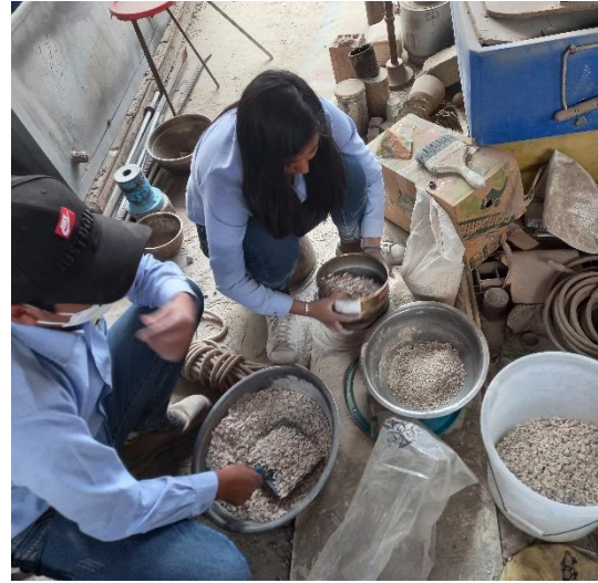
Fotografía 18. 2do tamizado de las conchas de molusco triturada con uso de las mallas n°3/8, n° 4 y n°16.
