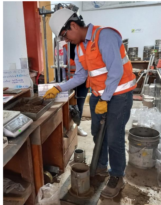
Figura 52: Colocación de la muestra combinada al 7.50% NaCl sobre el molde metálico.
