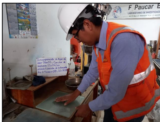
Figura 21. Enrollado de muestra representativa - limite plástico.
