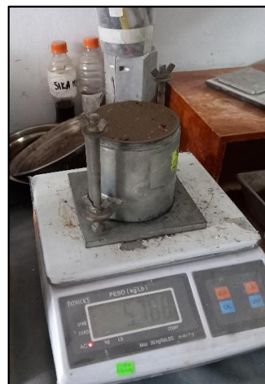
Figura 24. Peso del material adicionado con las conchas de molusco + el molde cilíndrico.
