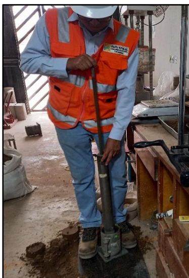
Figura 23. Compactado del material haciendo uso del martillo pistón.
