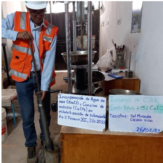
Fotografía 64: Compactación de la muestra de suelo + 15% de \text{CaCO}_3 sobre molde cilíndrico para ensayo de CBR
