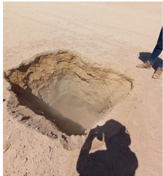
Fotografía 24: Excavación de la Calicata 01
