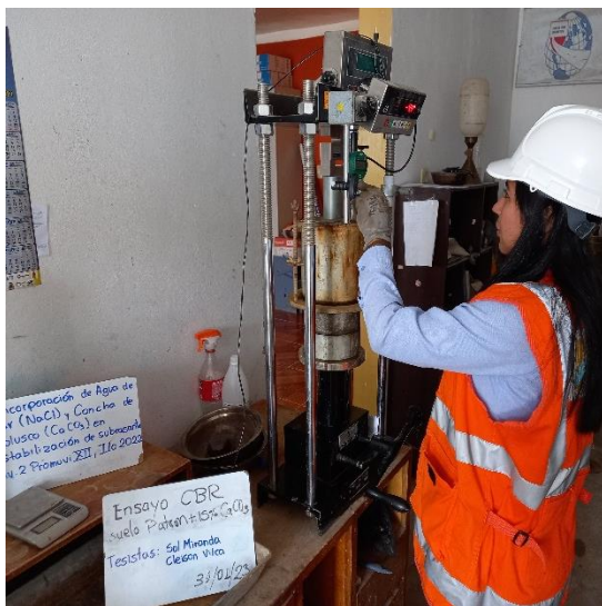
Figura 66: Preparación de la prensa de CBR para lecturar la penetración sobre el espécimen.
