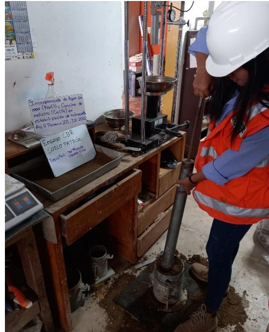
Fotografía 34. Compactación del espécimen para ensayo de CBR.
