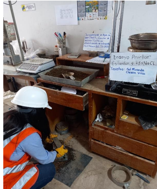
Fotografía 50: Enrasado de material sobre el molde cilíndrico de Proctor Estándar.
