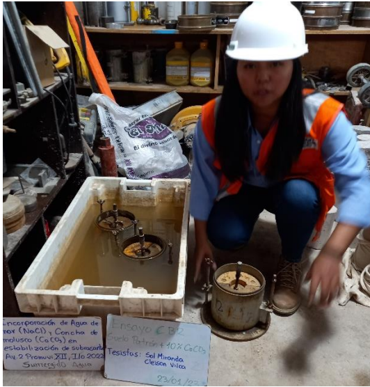
Fotografía 60: Inmersión de los especímenes en agua.
