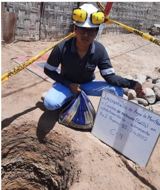
Fotografía 27. Excavación de la Calicata 04.
