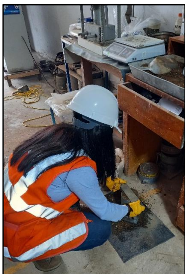
Figura 22. Enrasado del suelo combinado con las conchas trituradas.
