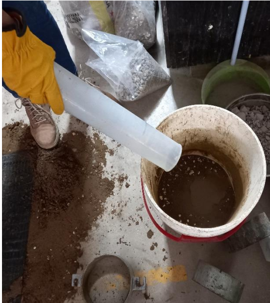
Fotografía 56: Vertido de agua sobre la muestra combinada de suelo patrón + 10% CaCO 3 para ensayo de Proctor estándar.
