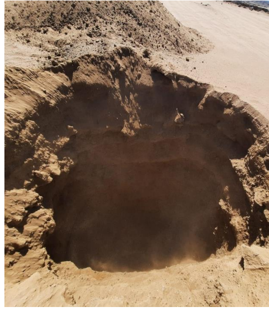
Fotografía 26. Excavación de la Calicata 03
