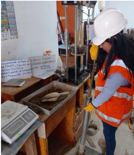
Fotografía 45: Compactación de suelo natural + 5% NaCl.
