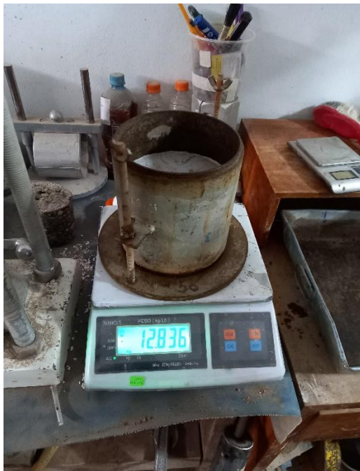
Figura 51: Peso del molde metálico cilíndrico para ensayo de CBR.
