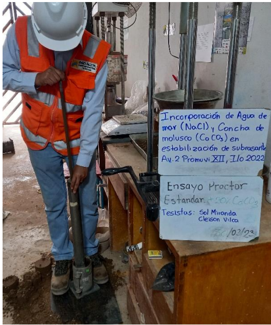
Fotografía 68: Compactación de la muestra, espécimen de suelo natural + 20% CaCO 3 . (Proctor Estandar)
