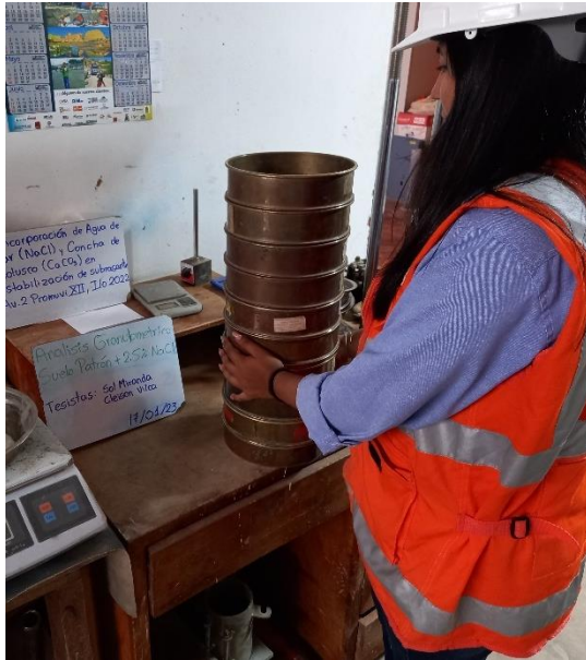
Fotografía 37. Análisis granulométrico por tamizado para el suelo natural con la adición de 2.50% NaCl.
