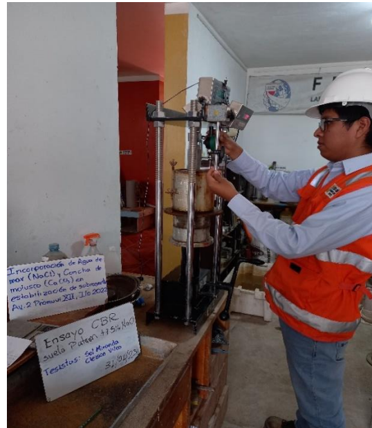
Fotografía 53: Preparación de la prensa de CBR para realización de la penetración del ensayo de CBR del espécimen suelo patrón + 7.5% NaCl.
