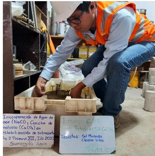
Fotografía 65: Sumergido de especímenes (Suelo patrón + 15% \text{CaCO}_3 ) sobre agua para medir el hinchamiento del suelo.
