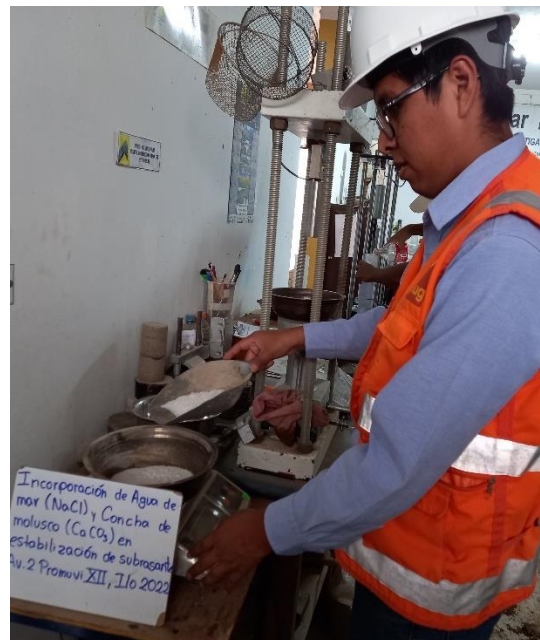
Figura 36: Pesado de NaCl en balanza electrónica.
