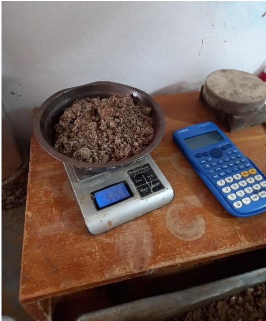
Fotografía 49: Peso del suelo seco cuando se adiciona 7.50% NaCl para Proctor Estándar.
