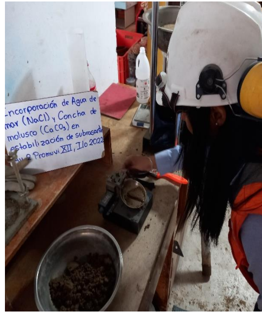
Figura 32. Determinación de límites de atterberg, uso copa Casagrande
