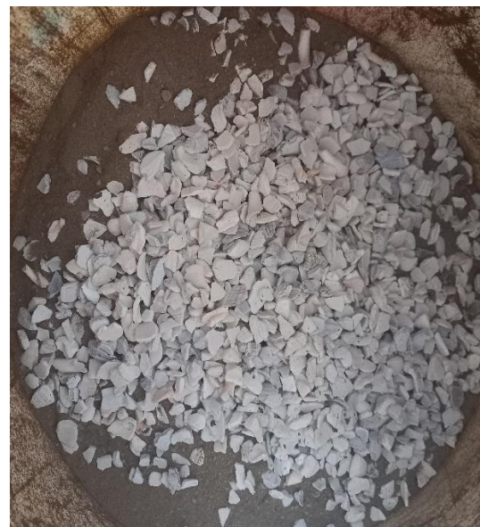
Figura 55: Incorporación de las conchas de molusco triturada al suelo patrón.
