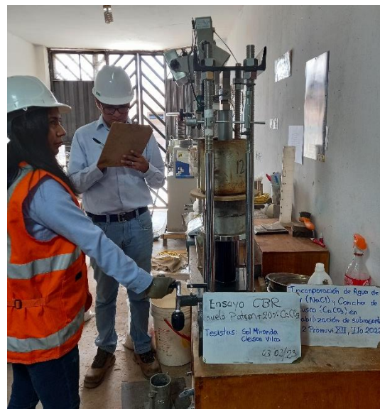
Figura 28: Lecturando la penetración de la prensa de CBR en el espécimen de Suelo natural + 20% CaCO 3 .
