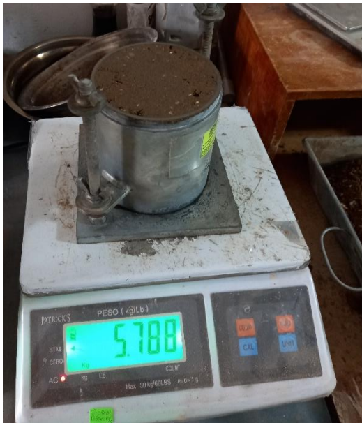
Figura 58: Peso del espécimen húmedo + el molde cilíndrico (Proctor Estándar)
