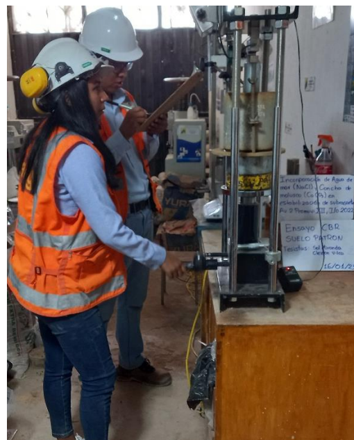
Figura 30. Lecturando y haciendo uso de la prensa CBR.
