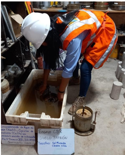
Figura 35. Sumergido de especímenes en agua (expansión).
