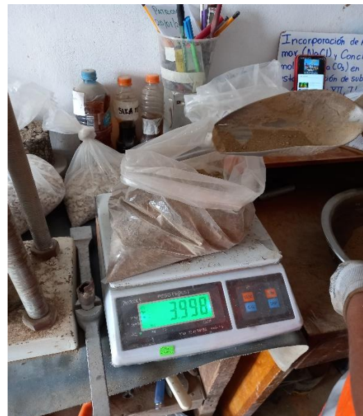
Figura 44: Embolsando la cantidad de suelo natural para los ensayos de correspondientes a realizar.
