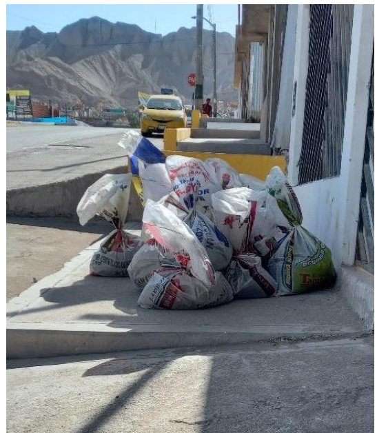
Fotografía 28. Traslado de las muestras de la calicata n°03 distribuidos en 14 sacos hacia laboratorio.
