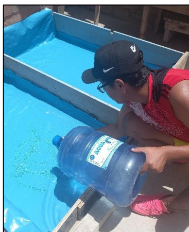
Figura 6. Dispersión de agua de mar sobre plástico reforzado.
