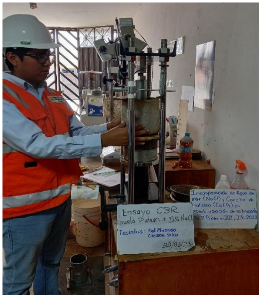
Figura 47: Colocando la muestra cilíndrica de suelo natural + 5% de NaCl en la prensa de CBR.
