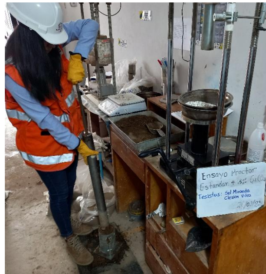
Figura 63: Compactación de la muestra en 5 capas dentro del molde cilíndrico (Ensayo Proctor Estándar)
