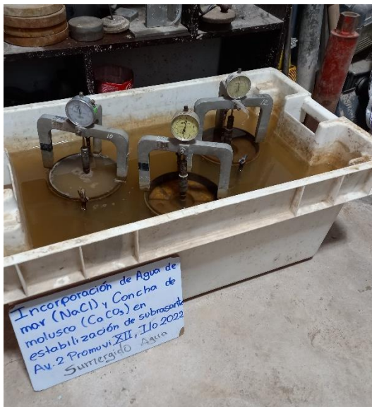
Figura 27: Sumergido en agua del espécimen luego de haber compactado la muestra adicionada de 20% CaCO 3 .
