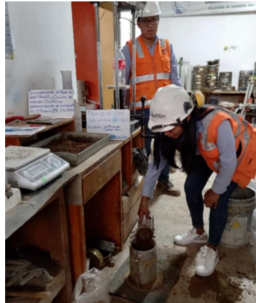
Fotografía 46: Preparación de muestra para compactación – CBR del suelo natural + 5% de NaCl.
