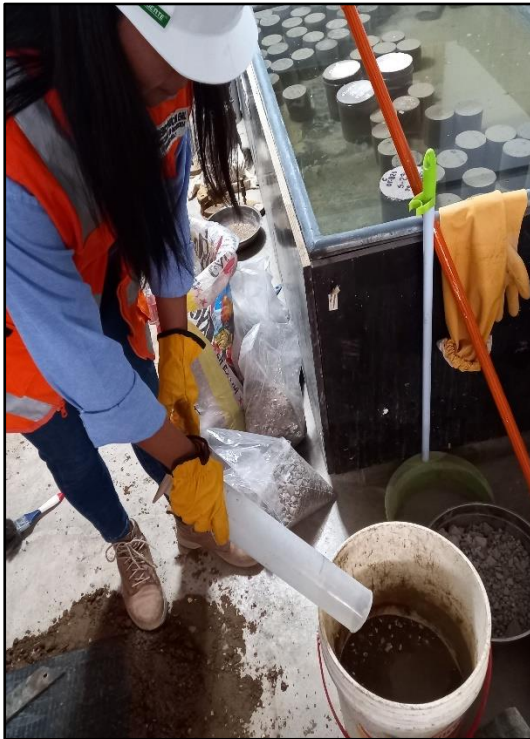
Figura 26. Colocación de agua a la adición de Suelo patrón + 2.5% de NaCl.
