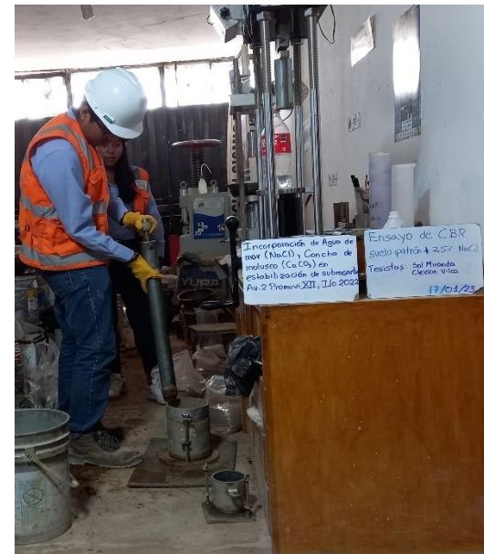
Fotografía 40. Compactación de suelo natural + 2.50% de NaCl para especímenes del ensayo de CBR.
