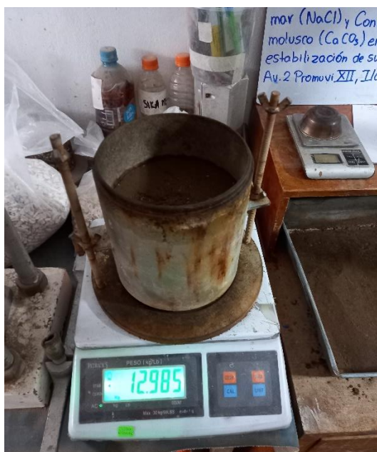
Figura 29. Peso de la muestra con el molde.
