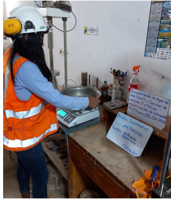
Fotografía 30. Pesado de las muestras representativa para el análisis granulométrico
