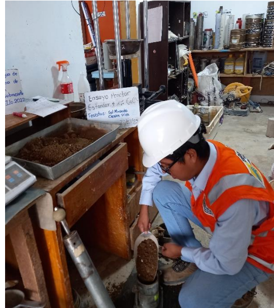
Fotografía 57: Colocación de muestra del espécimen húmedo sobre el molde cilíndrico para su compactación.
