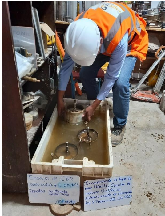
Fotografía 41: Colocación en agua de los especímenes de suelo patrón + 2.50% NaCl.
