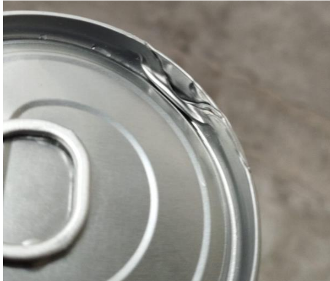
Figura 02. Defecto de abertura en cierre
