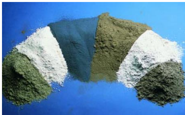
Figura 16. Cenizas: CV (Clase C), arcilla calcinada, humo de sílice, CV (Clase F), escoria y esquisto. De derecha a izquierda. Fuente: Kosmatka et al. (2004, p. 77).
