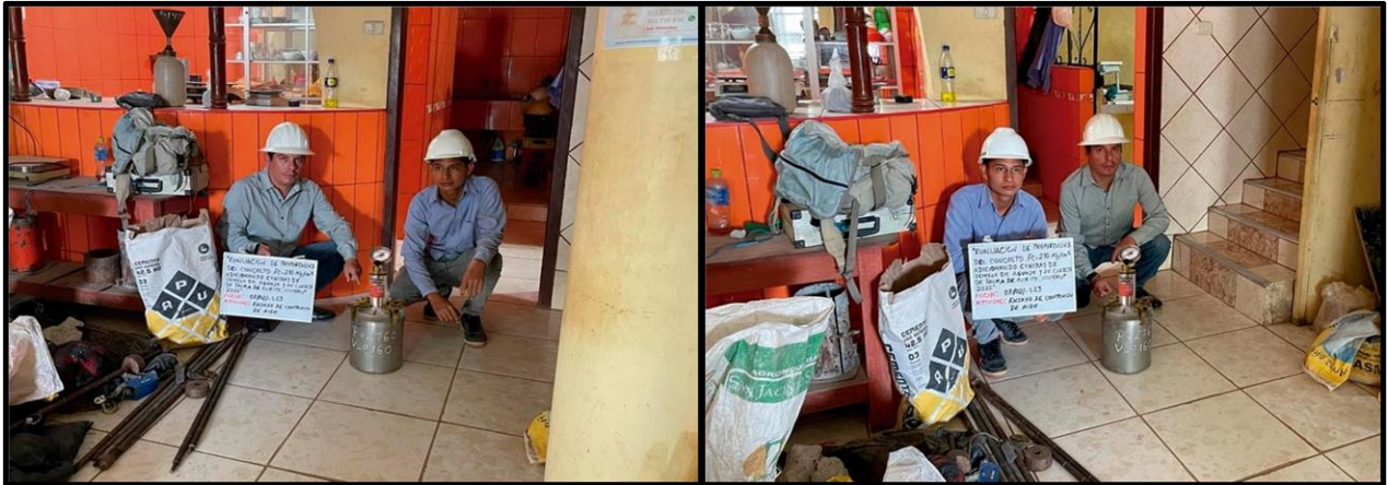
Figura 42. Tomas fotográficas de ensayos de contenido de aire.
