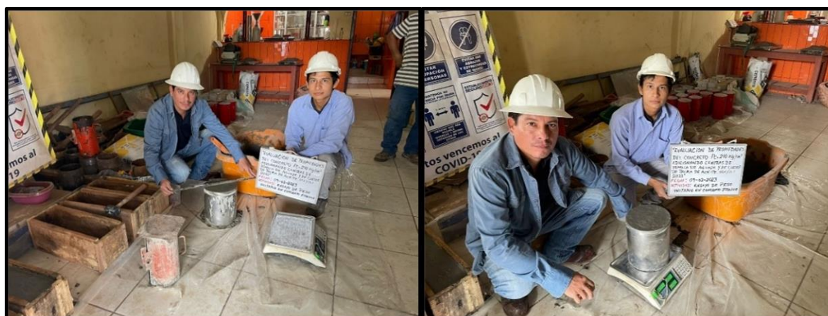
Figura 44. Fotografías de ensayos de peso unitario del concreto fresco.
