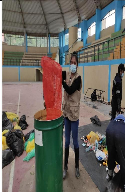
Introducción de las muestras en el cilindro para calcular densidad
