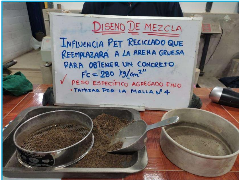
Figura N° 28 Pesado de arena gruesa para diseño patrón
