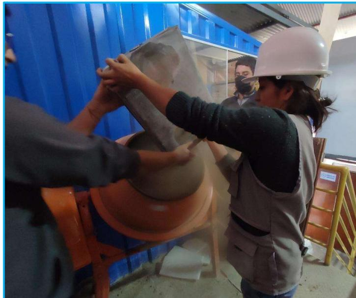
**Figura N° 15** Incorporación del cemento a la mezcla
