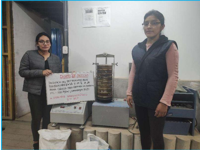
Figura N° 8 Análisis Granulométrico agregado fino (10% PET)
