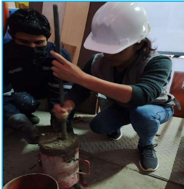
Figura N° 17 Probetas de concreto
