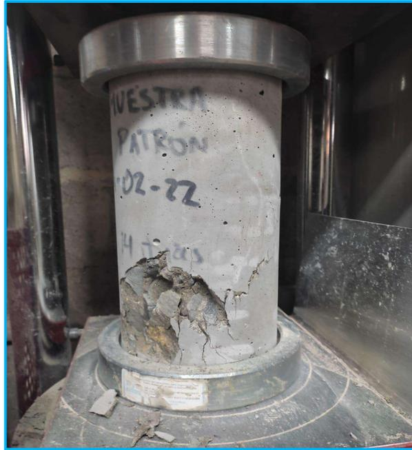
**Figura N° 34** Rotura de probeta de concreto experimental – 21 días
