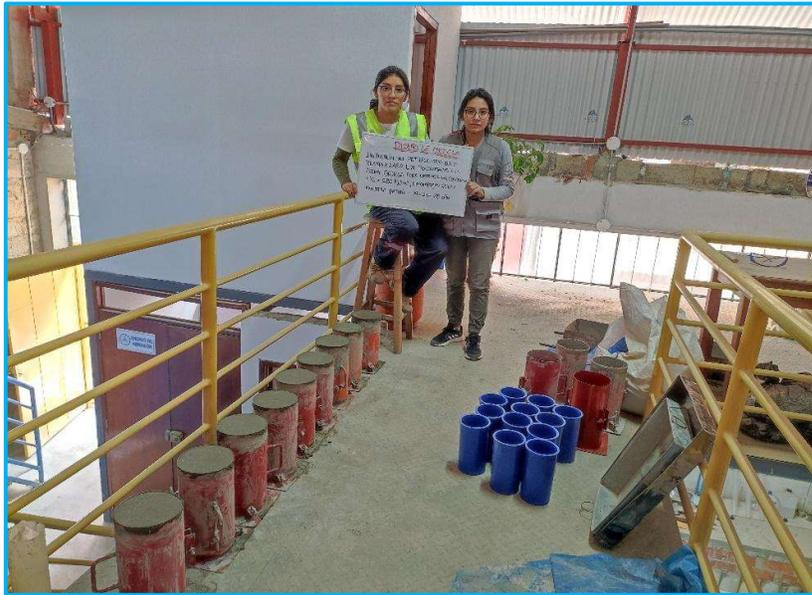
Figura N° 32 Probetas de concreto experimental (10% PET)
