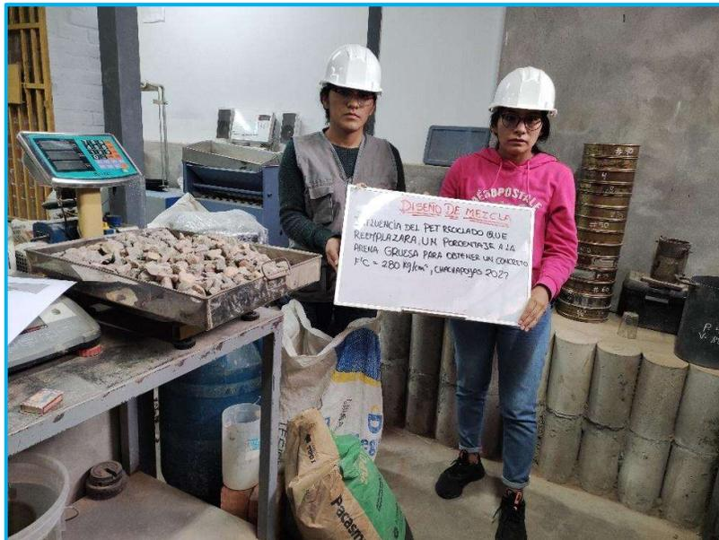
Figura N° 31 Probetas de concreto Patrón (rotura de 14, 21 y 28 días)
