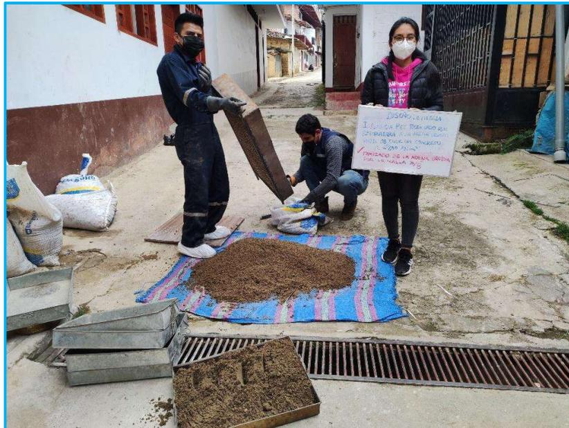
Figura N° 27 Peso específico del agregado fino
