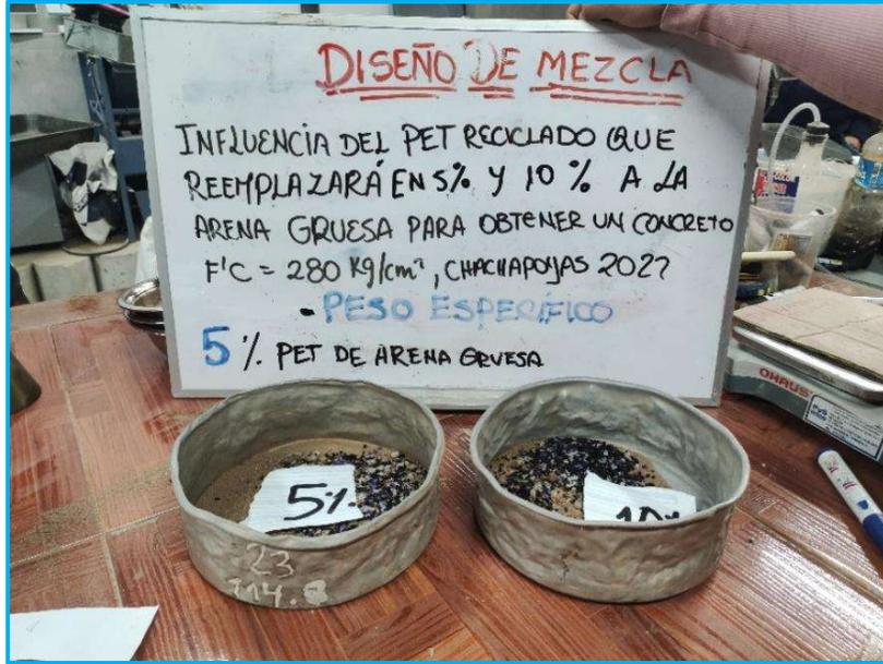
Figura N° 10 Peso unitario suelto del agregado fino (5% PET)
