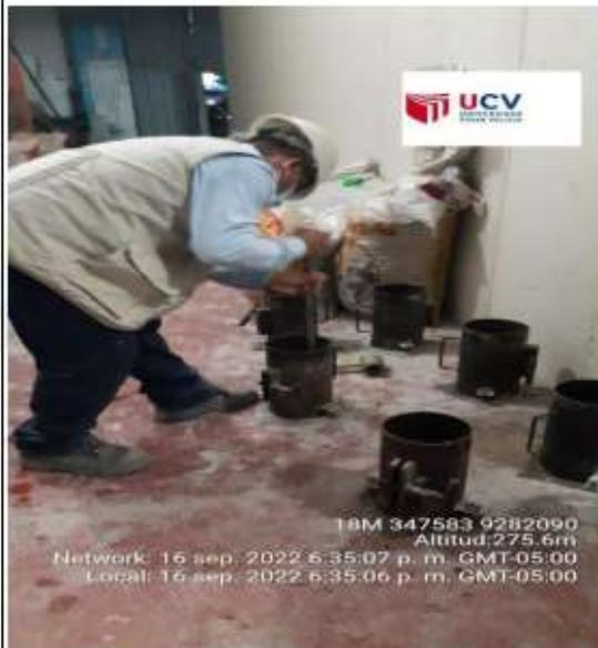
Fotos nº 13-14: En las imágenes podemos observar al personal realizando la prueba de asentamiento para los diseños de Mezclas.
