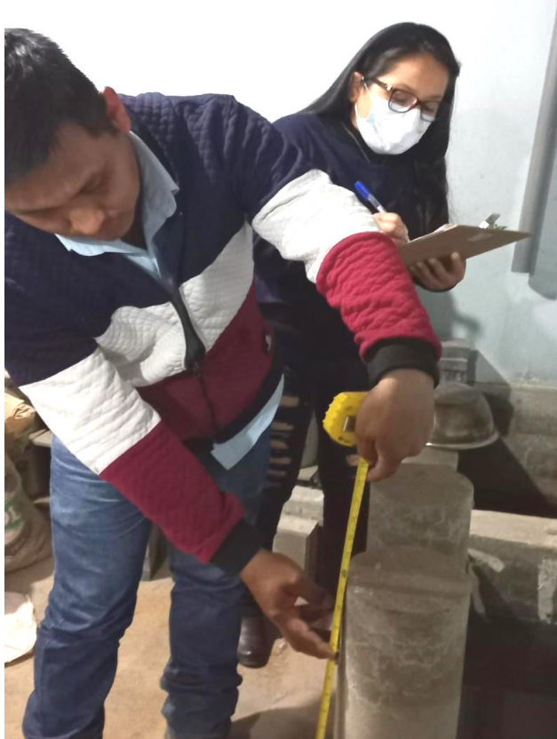
Desmoldado y medición de las probetas
