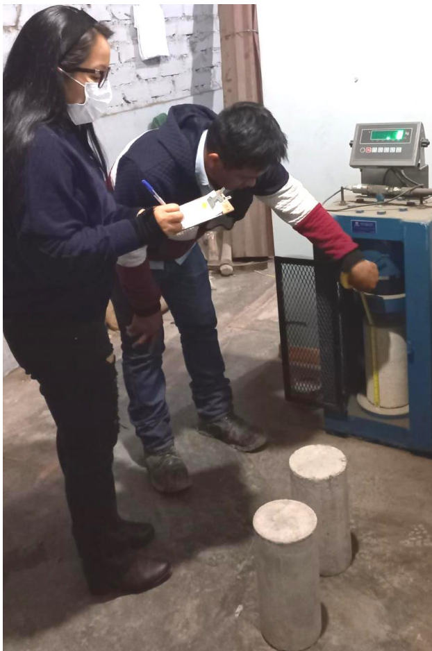
Ensayo de rotura de las probetas
