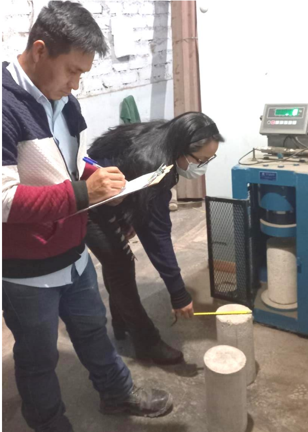
Ensayo de rotura de las probetas
