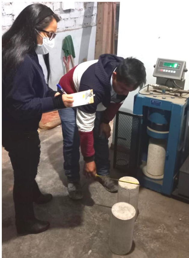
Ensayo de rotura de las probetas
