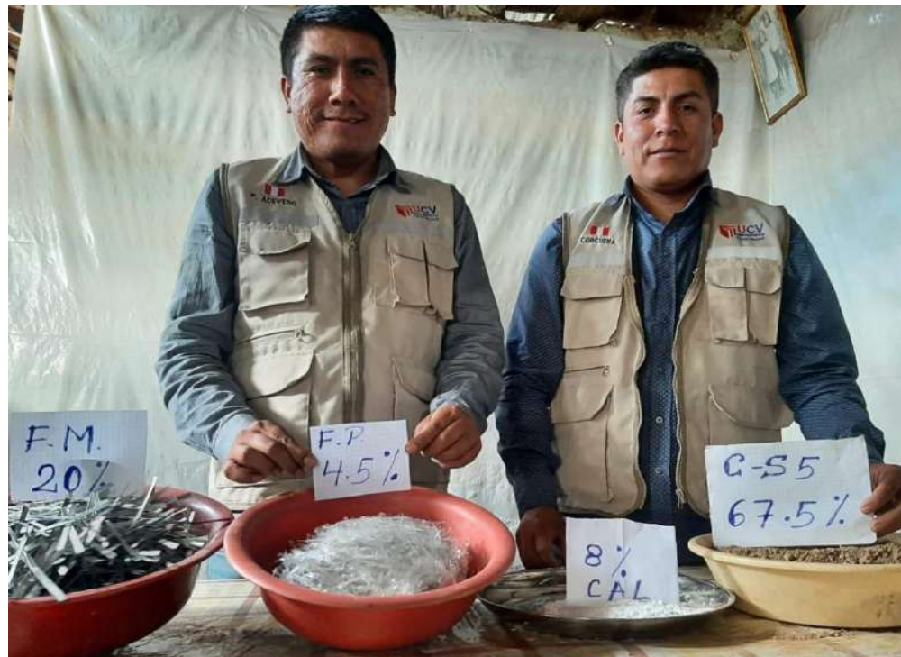
Dosificación S5 (Muestra de suelo con tratamiento + cal natural+ fibras plásticas + fibras metálicas)
