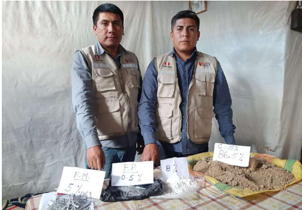
Dosificación S2 (Muestra de suelo con tratamiento + cal natural+ fibras plásticas + fibras metálicas)
