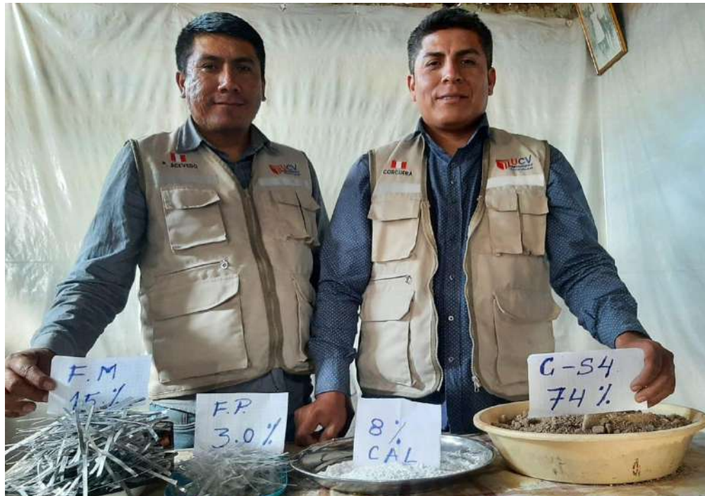
Dosificación S4 (Muestra de suelo con tratamiento + cal natural+ fibras plásticas + fibras metálicas)
