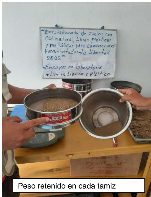
Tamizaje de la muestra de suelos
