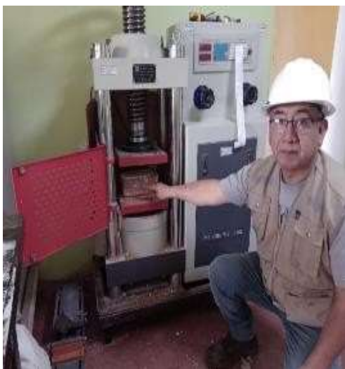
Figura N° 23. Ensayos de resistencia a la compresión del ladrillo.
