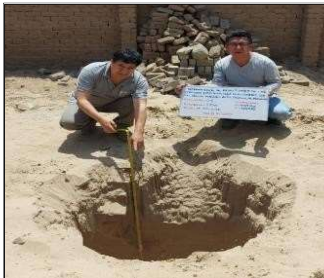
Figura N° 08. Calicata para verificación del tipo de suelo.
