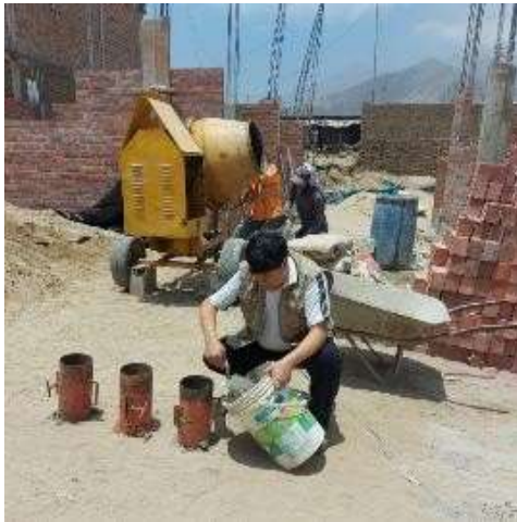
Figura N°22. Elaboración y ensayo de probetas cilíndricas.
