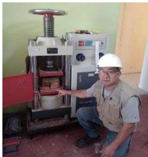
Figura N° 23. Ensayos de resistencia a la compresión del ladrillo.
