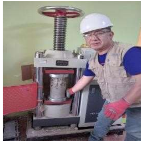
Figura N°22. Elaboración y ensayo de probetas cilíndricas.
