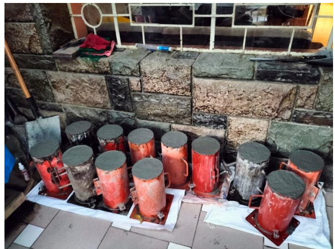
Fotografía N°8: Probetas totalmente vaciadas
