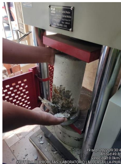
Fotografía N°11: Resultado de las probetas sometidas a compresión
