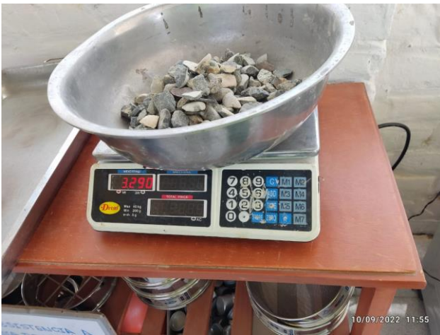
Fotografía N°5: Ensayo del peso unitario varillado
