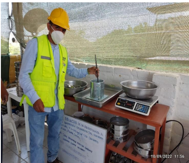
Fotografía N°5: Ensayo del peso unitario varillado
