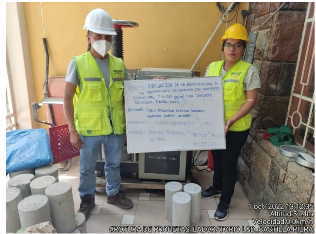
Fotografía N°11: Resultado de las probetas sometidas a compresión
