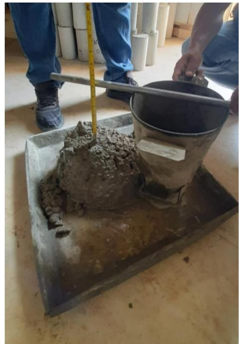
**Ensayo de revenimiento para determinar la trabajabilidad del concreto
