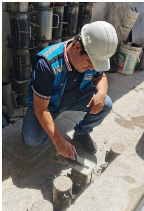
**Elaboración de probetas de concreto (NTP 339.033)**
