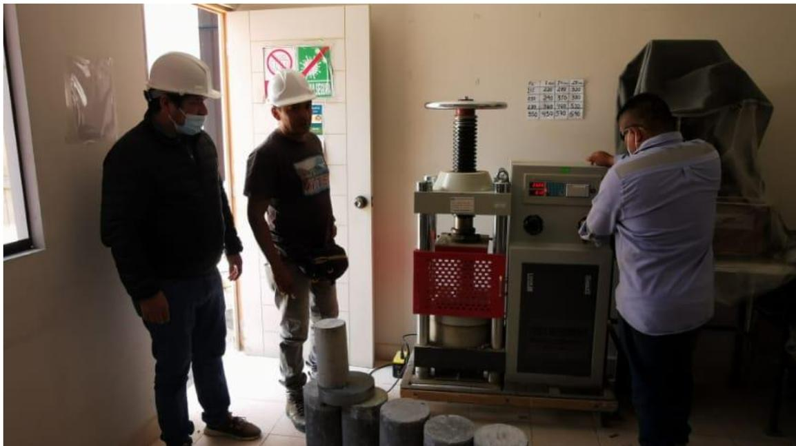
**Rotura de probetas de concreto en porcentajes de 5%, 15% y 30% de conchas de abanico**
