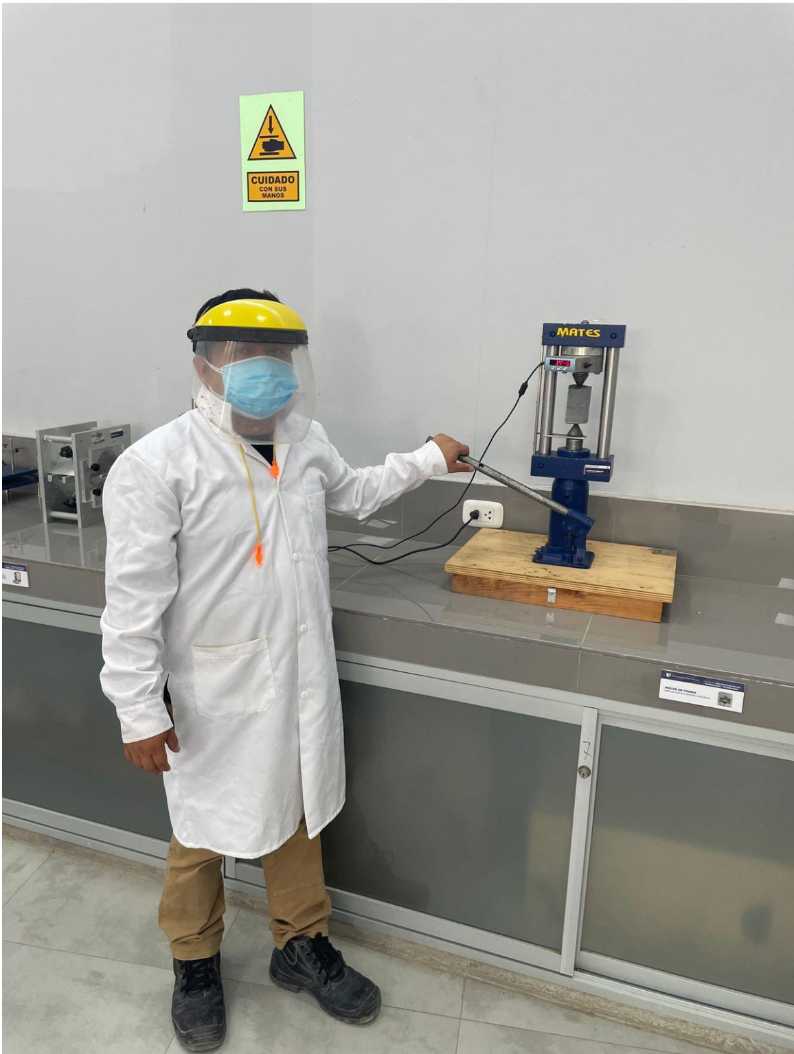
Figura 8: Ensayo de Carga Puntual
