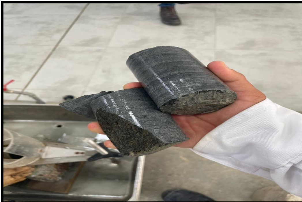
Figura 7: Testigos obtenidos producto de la perforación diamantina
