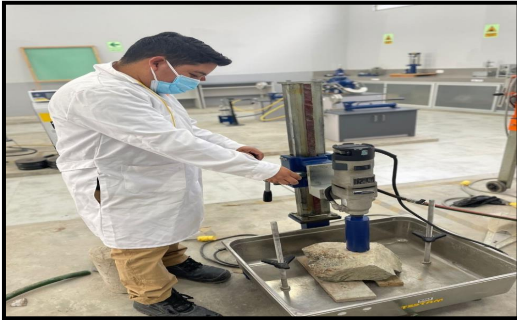
Figura 6: Perforación diamantina y extracción de testigos
