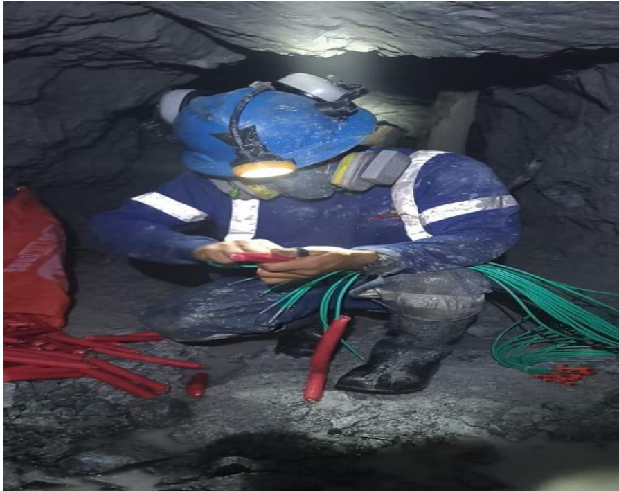
Figura 12: Unión de explosivo Emulnor 3000 con Carmex de 1.8 metros
