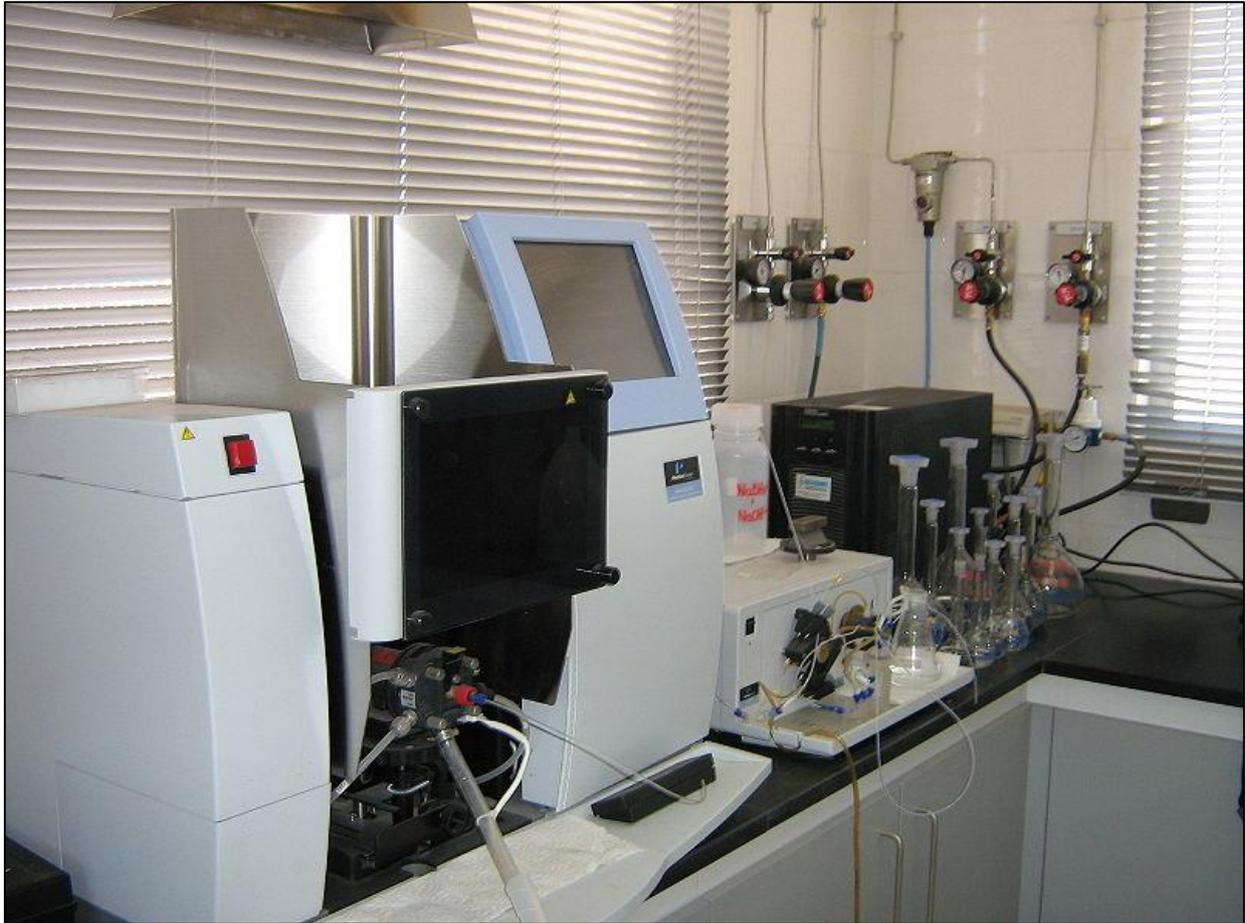
Figura 4: Espectrofotómetro de absorción atómica modelo SHIMADZU AA-7000 con generador de hidruros modelo SHIMADZU HVG-1
