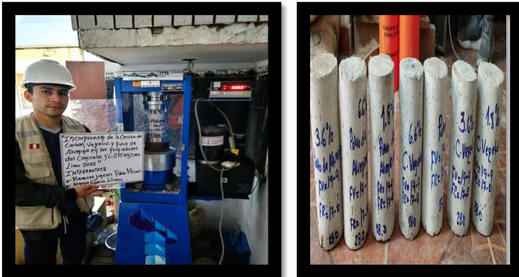
Figura 11: Ensayo de resistencia a la compresión
