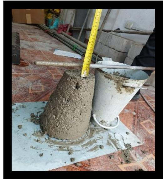
Figura9.ensayo de la trabajabilidad
