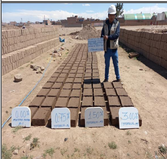
SECADO DE LAS UNIDADES DE ADOBE A TEMPERATURA AMBIENTE
