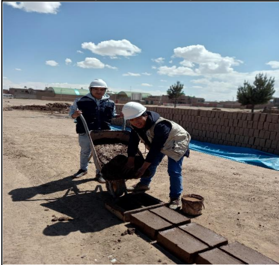
ELABORACION DE UNIDADES DE ADOBE, MP, MP+0.75%, MP+1.50%, MP+3.00% DE FIBRA RESPECTIVAMENTE
