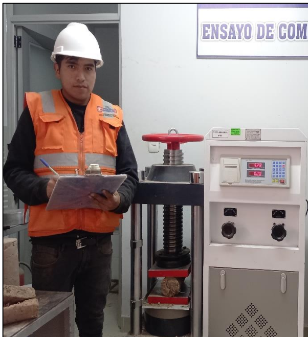
FIGURA 19 / Ensayo de resistencia a la tracción diametral en adobes
