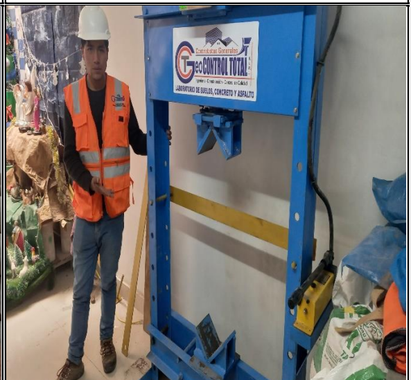
EQUIPO DE LABORATORIO DE COMPRESION DIAGONAL PARA MUERTES
