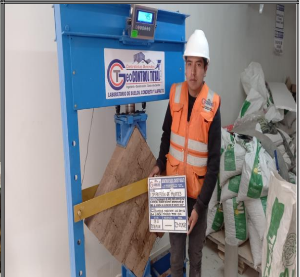
ENSAYO DE CORTE EN MURETES - ENSAYO DE COMPRESION DIAGONAL - MP+ADICIONAMIENTO
