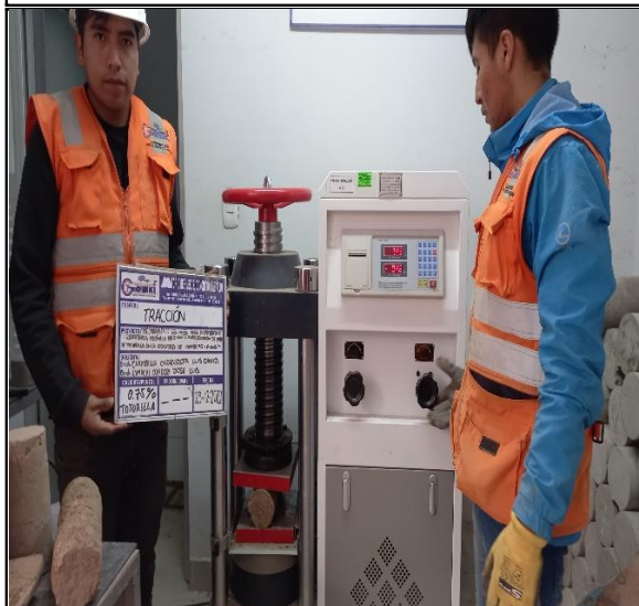
ENSAYO A LA TRACCION EN UNIDADES CILINDRICAS - MUESTRA PATRON + ADICIONAMIENTO DE FIBRA DE TOTORILLA
