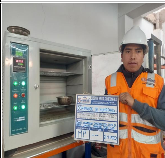
ENSAYOS DE LABORATORIO - CONTENIDO DE HUMEDAD
