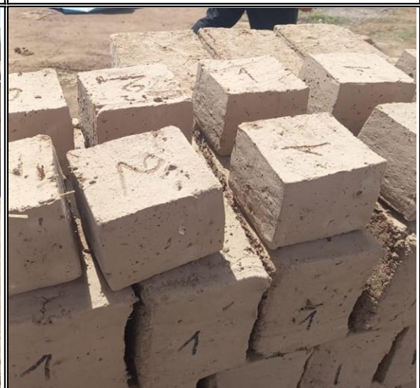
CUBOS DE ADOBE, SECADO A TEMPERATURA AMBIENTE, EN EL PUNTO DE ELABORACION
