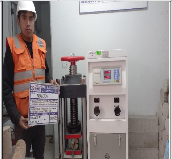
ENSAYO A LA TRACCION EN UNIDADES CILINDRICAS - MUESTRA PATRON
