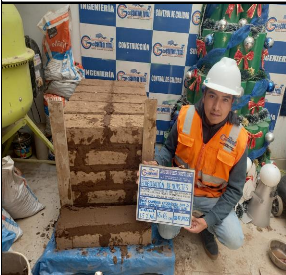
ELABORACION DE MURETES DE ALBAÑILERIA EN LABORATORIO DE DIFERENTES MUESTRAS
