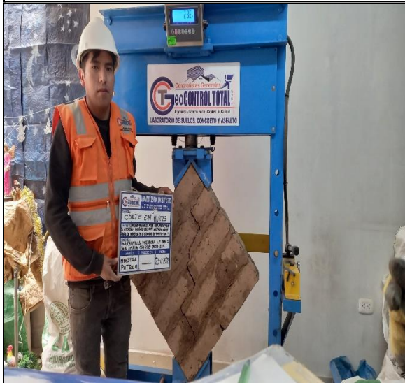
ENSAYO DE CORTE EN MURETES - ENSAYO DE COMPRESION DIAGONAL - MUESTRA PATRON
