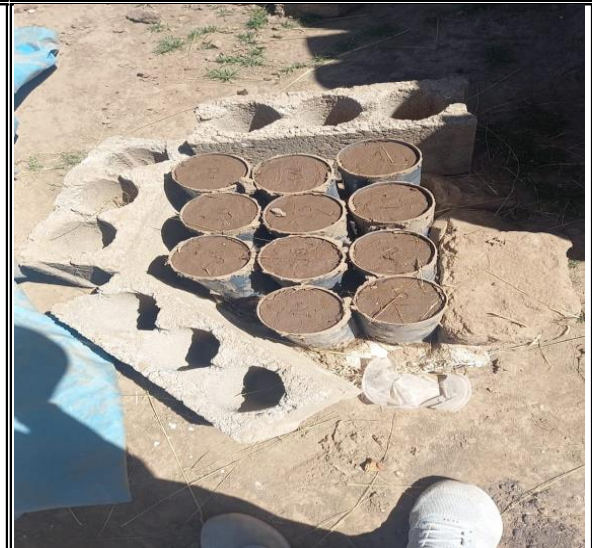
ELABORACION DE UNIDADES CILINDRICAS DE ADOBE CON , MP, MP+0.75%, MP+1.50%, MP+3.00% DE FIBRA RESPECTIVAMENTE
