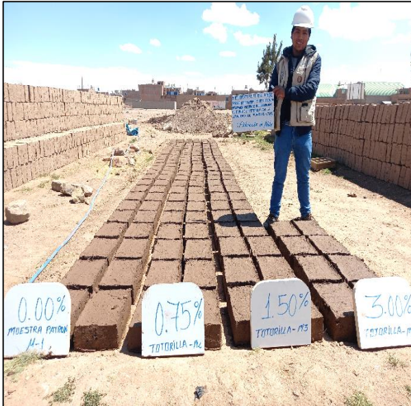
FIGURA 17 / Secado de la unidad de adobe a temperatura ambiente
