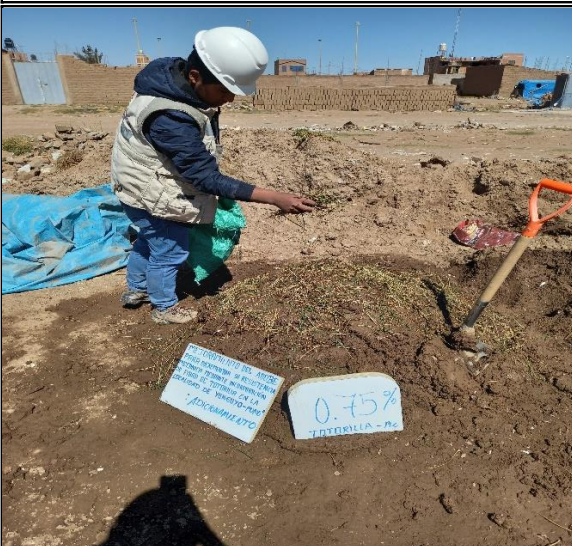
ADICIONAMIENTO DE FIBRA DE TOTORILLA - MP, MP+0.75%, MP+1.50%, MP+3.00%
