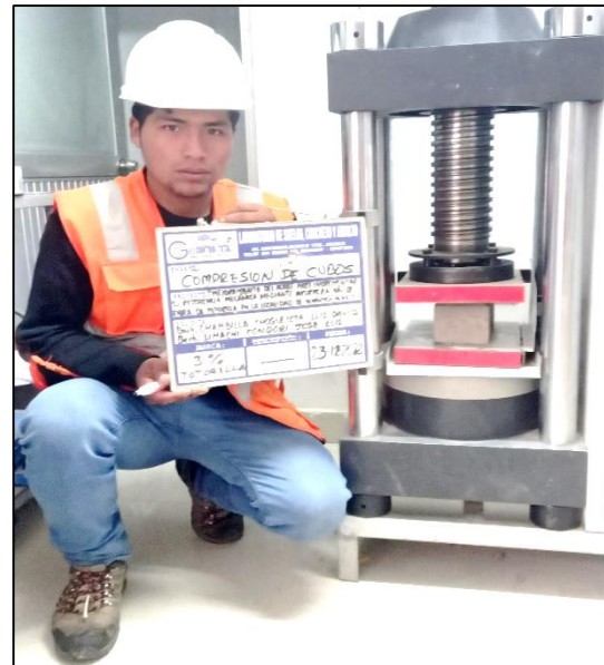
FIGURA 16 / Ensayo de compresión en cubos
