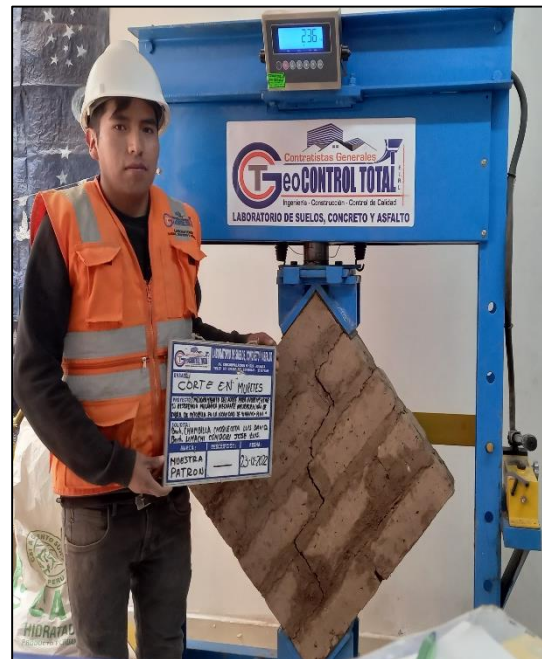
FIGURA 18 / Ensayo de compresión diagonal en muretes de albañilería
