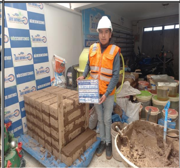
MURETES DE ALBAÑILERIA SECADO A TEMPERATURA AMBIENTE LIBRE DE LA RADIACION SOLAR
