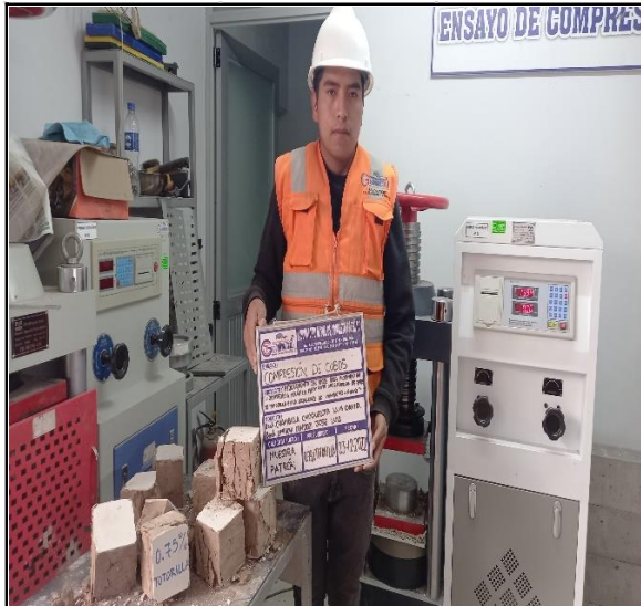
ENSAYO A COMPRESION EN UNIDADES CON ADICIONAMIENTO DE FIBRA
