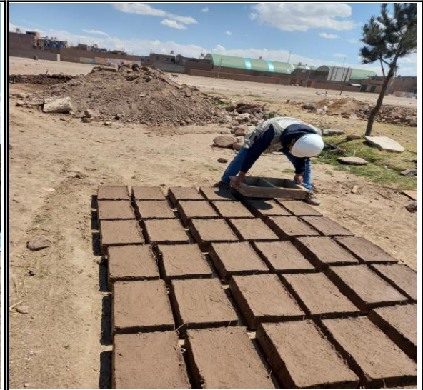
ELABORACION DE UNIDADES DE ADOBE, MP, MP+0.75%, MP+1.50%, MP+3.00% DE FIBRA RESPECTIVAMENTE
