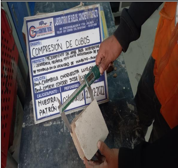
MEDICION DE DIMIENCIONES DEL CUBO DE ADOBE PARA EL ENSAYO A COMPRESION
