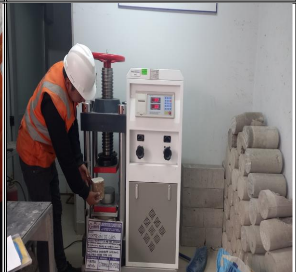
ENSAYO A COMPRESION EN CUBOS - MUESTRA PATRON
