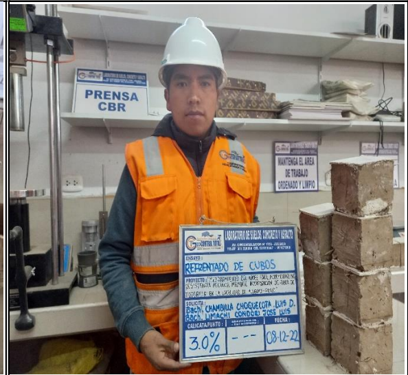
REFRENTADO EN CUBOS PARA REALIZAR EL ENSAYO A COMPRESION EN LABORATORIO
