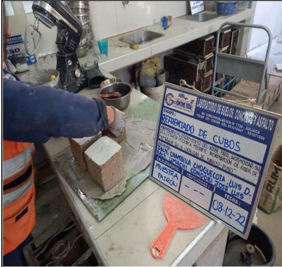
REFRENTADO EN CUBOS PARA REALIZAR EL ENSAYO A COMPRESION EN LABORATORIO
