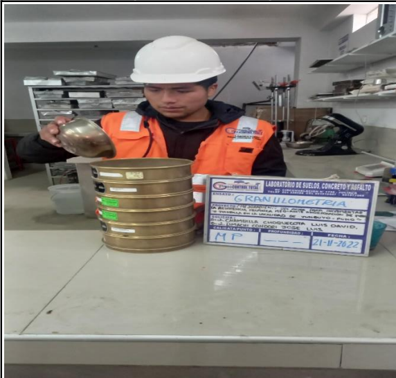
ENSAYOS DE LABORATORIO - GRANULOMETRIA Y CLASIFICACION DE SUELOS
