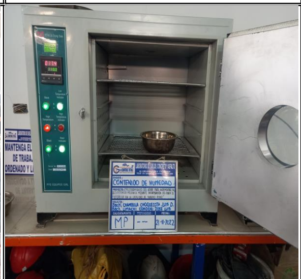
ENSAYOS DE LABORATORIO - CONTENIDO DE HUMEDAD
