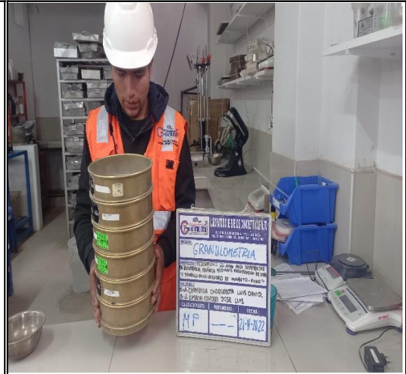
ENSAYOS DE LABORATORIO - GRANULOMETRIA Y CLASIFICACION DE SUELOS
