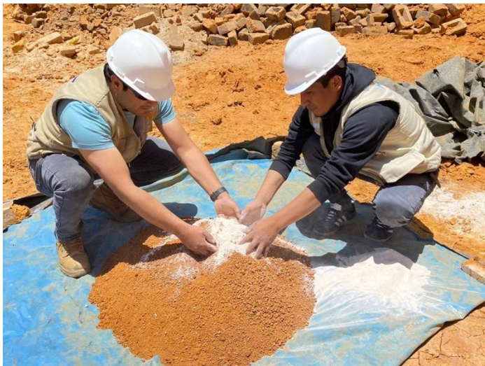
Foto 07: Mezclando el polvo de caparazón de cangrejo con la arcilla.
