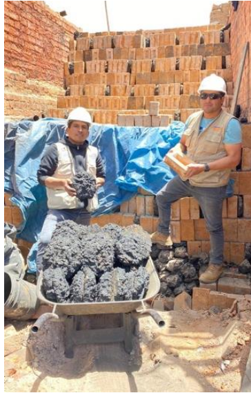
Figura 18: Trenzado del ladrillo con carbón para el quemado.
