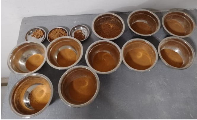
Figura 23: Granulometría de arcilla acorde al tamiz.
