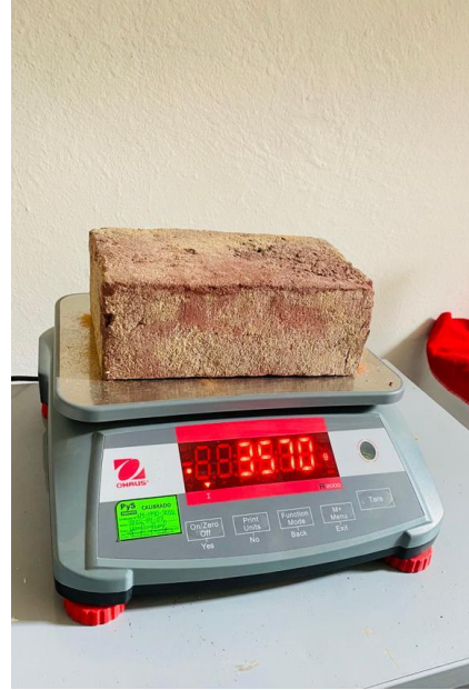
Foto 25: Comprobando el peso del ladrillo.
