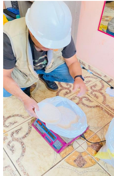
Foto 04: Pesando el polvo de cangrejo en los diferentes porcentajes de adición, 3%, 5% y 7%.
