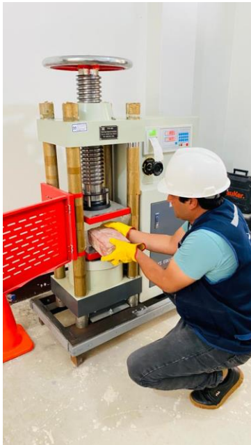
Foto 26: Colocando el ladrillo a la prensa para ensayos de compresión.
