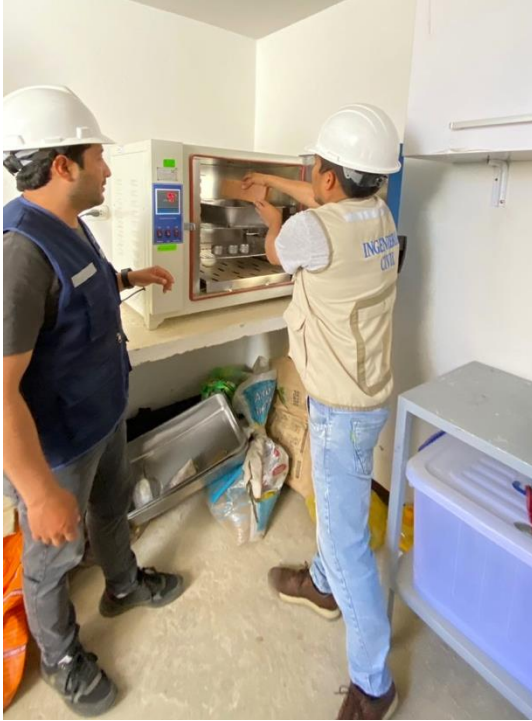
Foto 20: Secado del ladrillo en horno para luego hacer ensayo de absorción.
