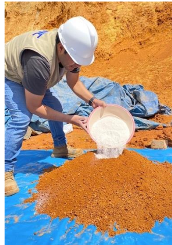
Foto 06: Adicionando el 5% del polvo de caparazón de cangrejo.
