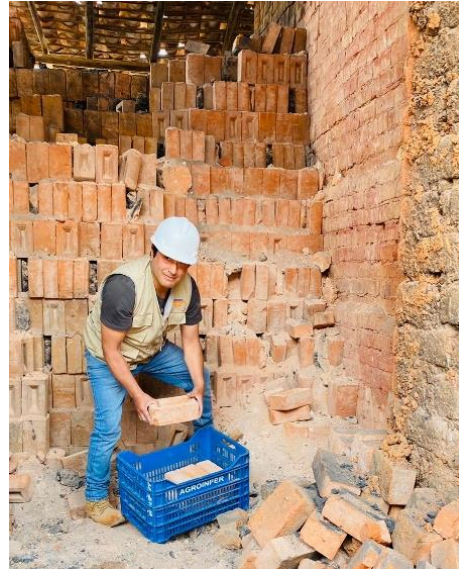
Figura 18: Trenzado del ladrillo con carbón para el quemado.
