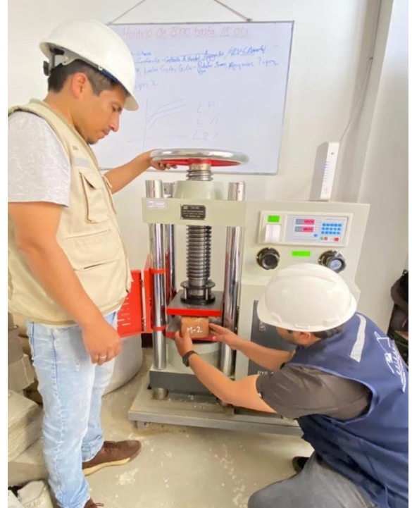
Foto 21: Realizando la prueba de resistencia a la compresión.
