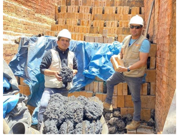
Foto 14: Apilando (Trenzado) del ladrillo al horno con carbón de piedra para la cocción.
