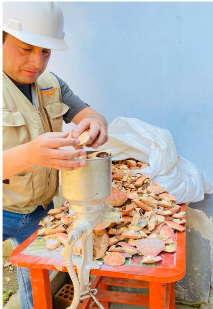
Foto 03: Proceso de la molienda del caparazón del cangrejo mediante un molino manual.
