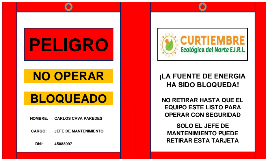
Figura 39: Tarjeta de boqueo de seguridad.
