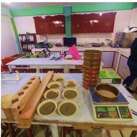
Figura 20: Tamizado de arena gruesa
