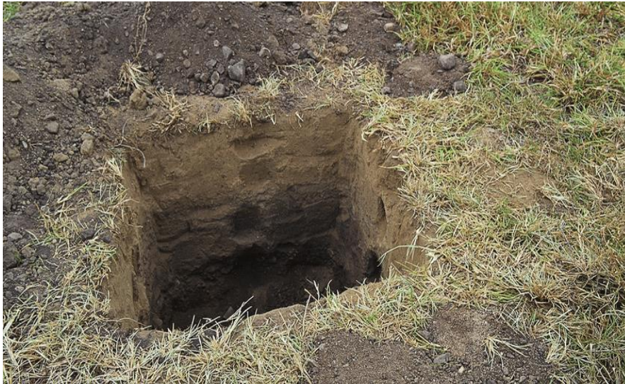
Figura 8: Calicata de muestras en distinta profundidad.
