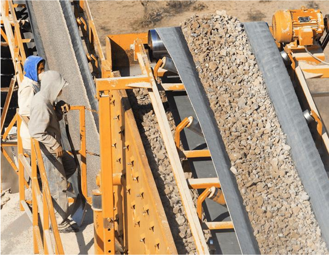
Chancado primario (Uniformidad)
