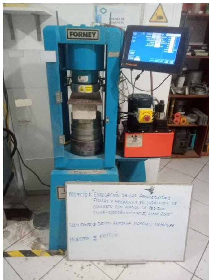
Figura 50: Ensayo de resistencia a la compresión de ladrillo patrón
