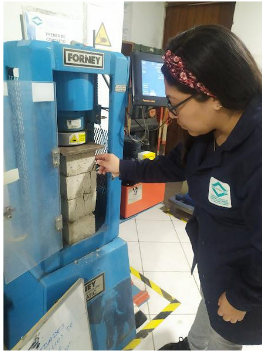
Figura 55: Ensayo de resistencia a la compresión de ladrillos en pilas de ladrillo patrón
