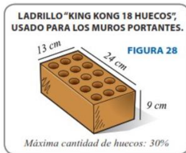
Figura 8: Dimensiones del ladrillo King Kong 18 huecos para muros portantes
