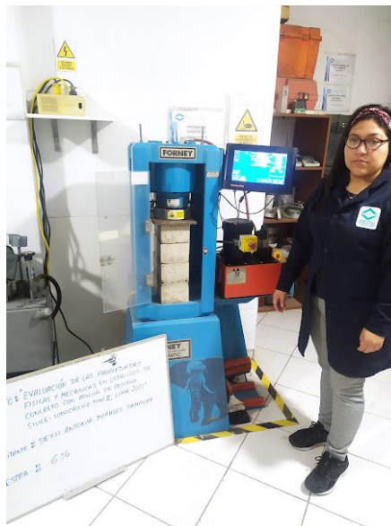
Figura 63: Ensayo de resistencia a la compresión de ladrillos en pilas con 6% de adición
