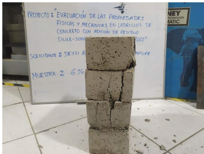
Figura 64: Falla tipo 1 para ladrillo con 6% de adición
