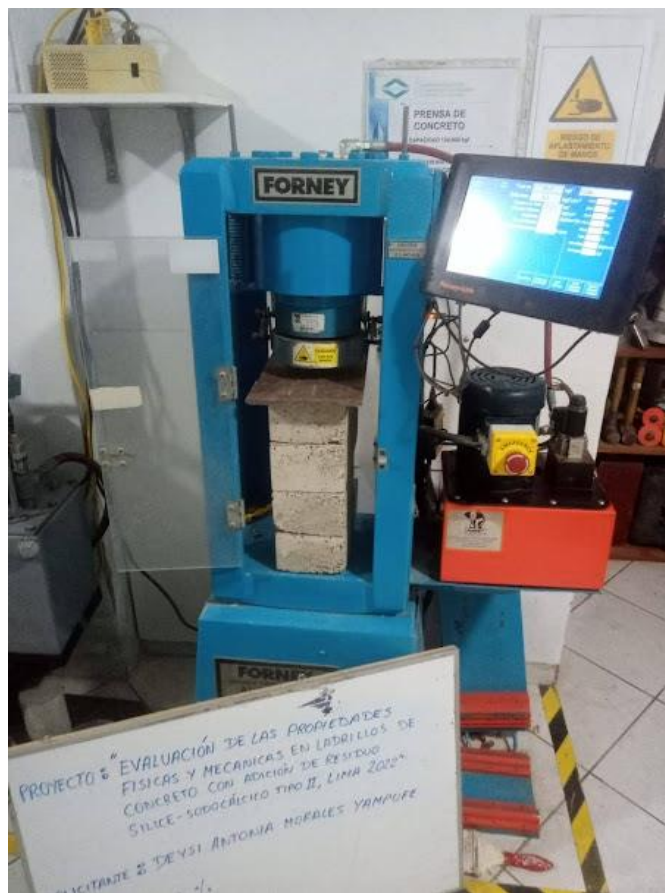
Figura 60: Ensayo de resistencia a la compresión de ladrillos en pilas con 4% de adición
