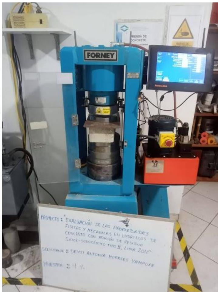
Figura 53: Ensayo de resistencia a la compresión de ladrillo con 6% de adición
