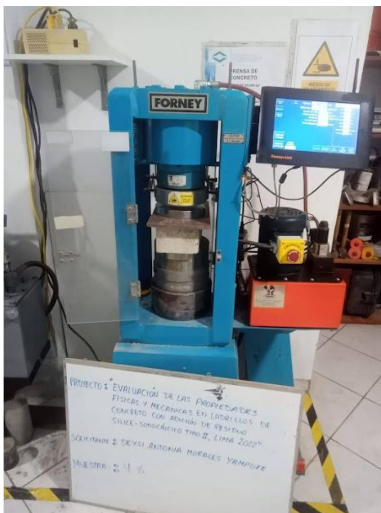
Figura 52: Ensayo de resistencia a la compresión de ladrillo con 4 % de adición
