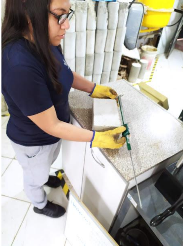
Figura 34: Ensayo de variación dimensional en ladrillo patrón 0%
