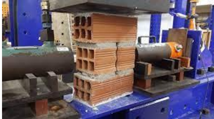
Figura 6: Ensayo de Resistencia a la compresión
