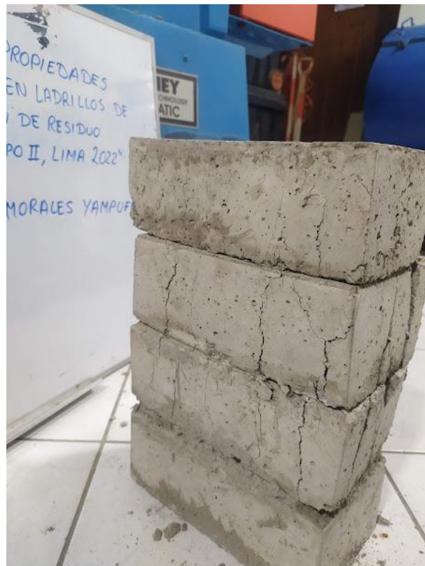
Figura 56: Falla tipo 1 para ladrillo patrón
