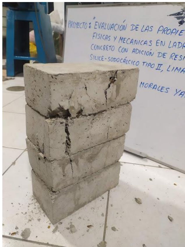
Figura 59: Falla tipo 1 para ladrillo con 2% de adición
