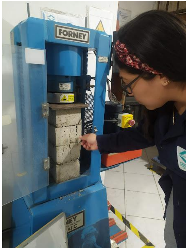
Figura 61: Fractura de pilas para ladrillo con 4% de adición
