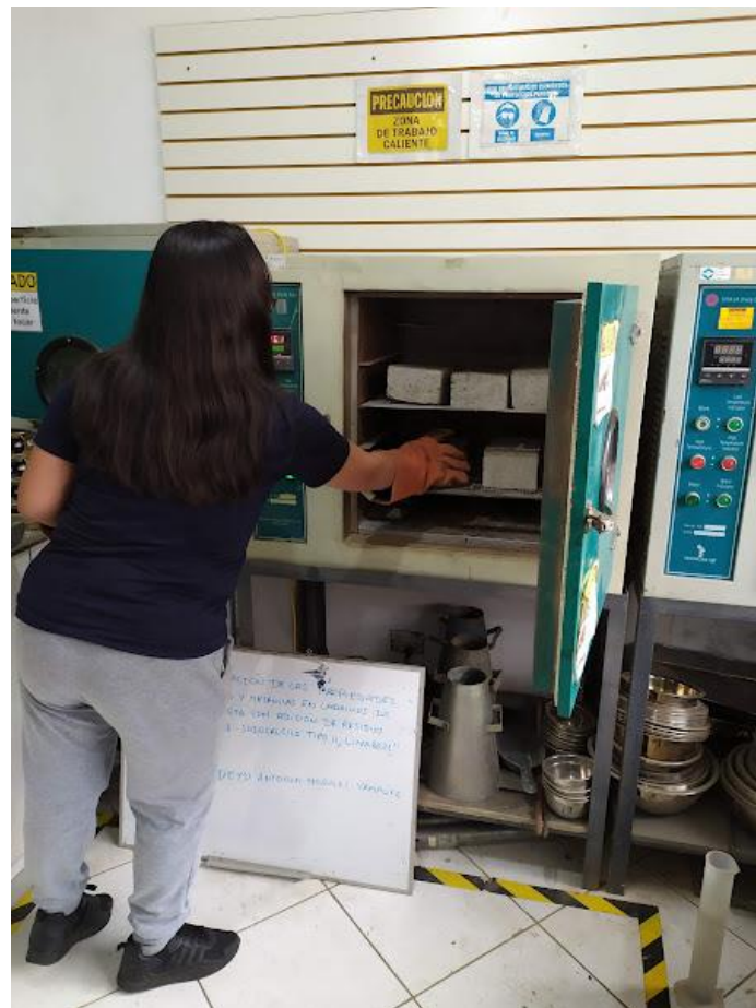
Figura 47: Secado por 24 horas de ladrillos para prueba de absorción
