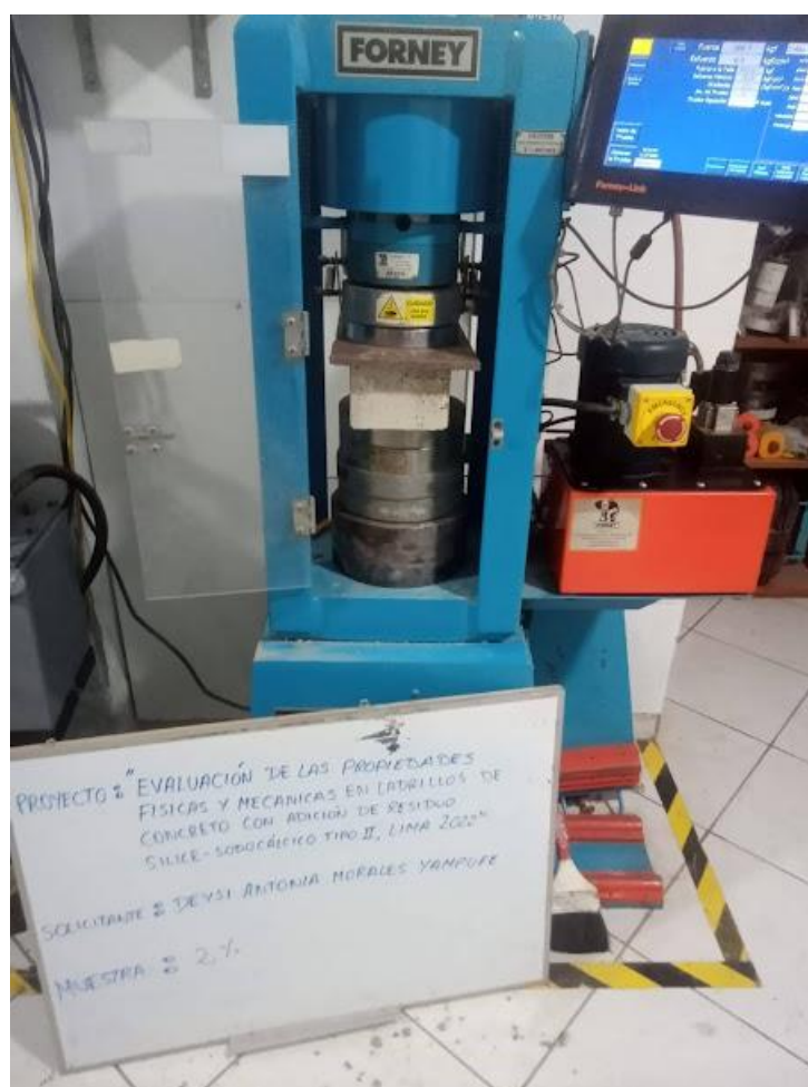
Figura 51: Ensayo de resistencia a la compresión de ladrillo con 2% de adición
