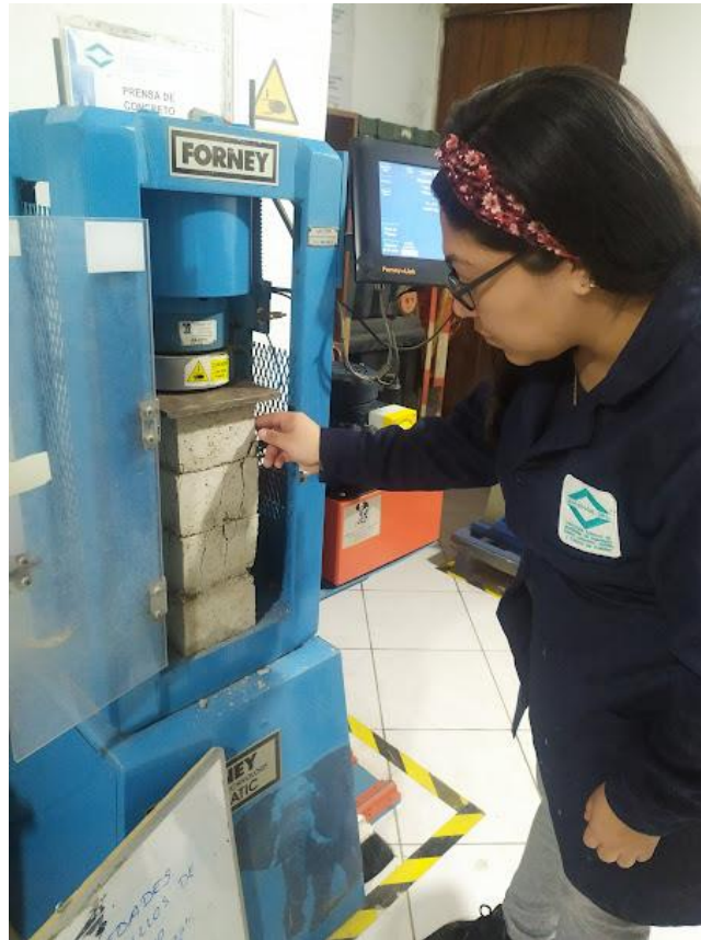
Figura 58: Fractura de pilas para ladrillo con 2% de adición
