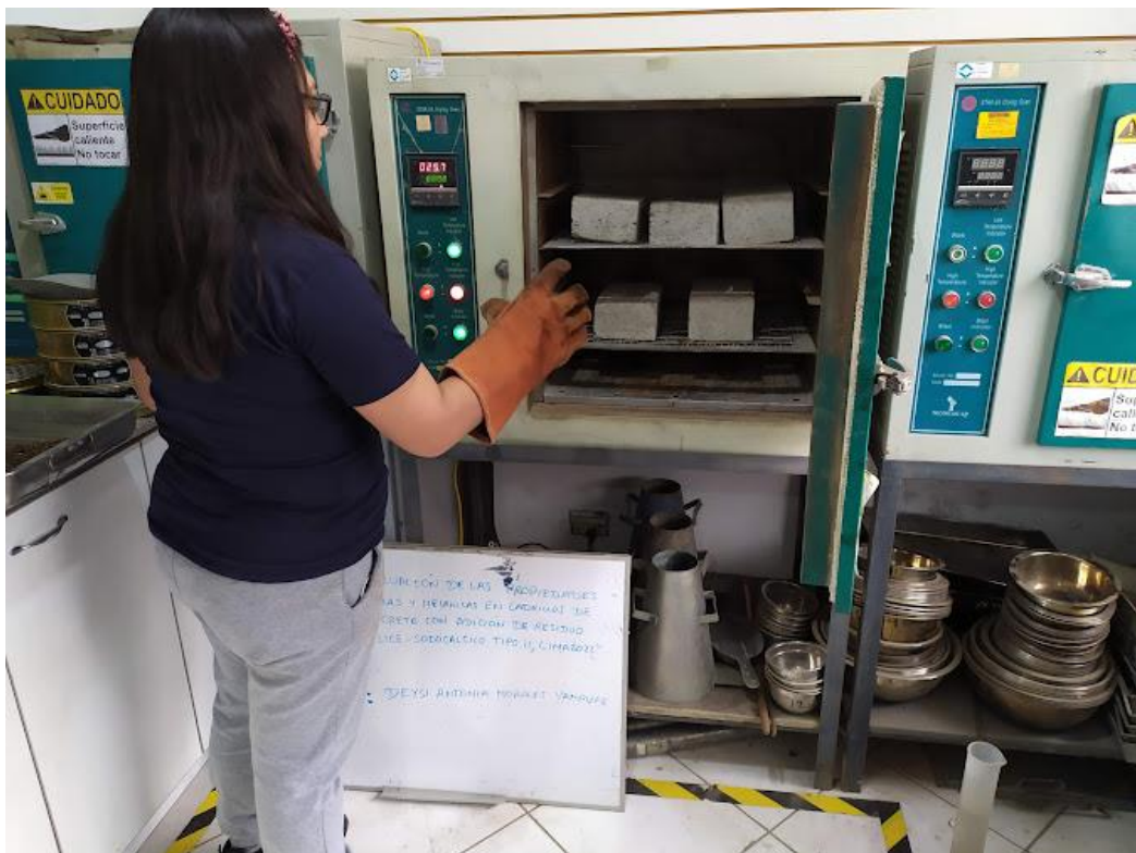
Figura 44: Secado por 24 horas de ladrillos para prueba de absorción
