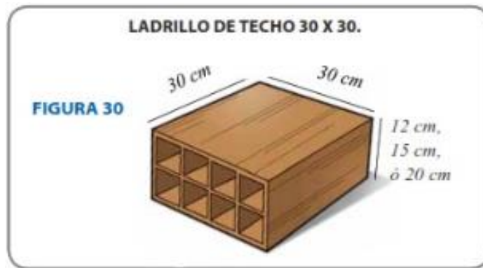
Figura 10: Dimensiones del ladrillo para losas aligeradas
