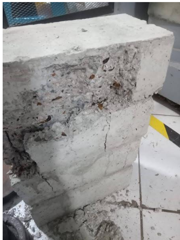
Figura 62: Falla tipo 1 para ladrillo con 4% de adición
