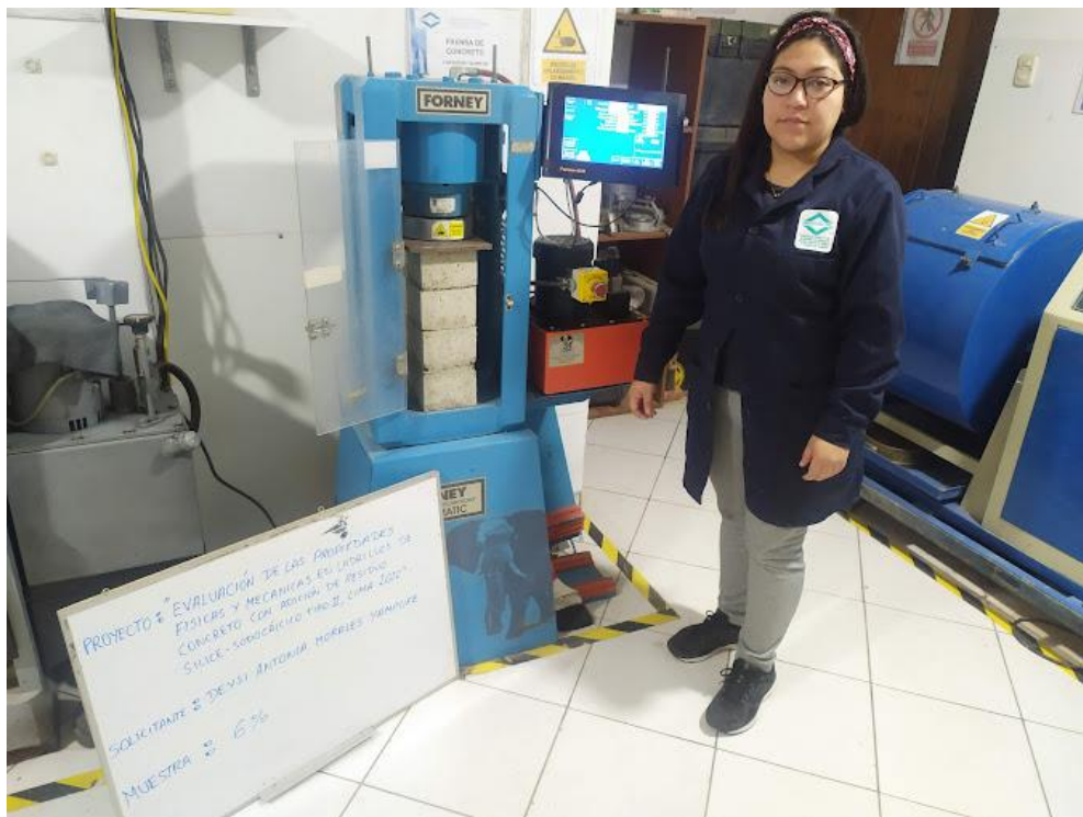
Figura 54: Ensayo de resistencia a la compresión de ladrillos en pilas con 6% de adición
