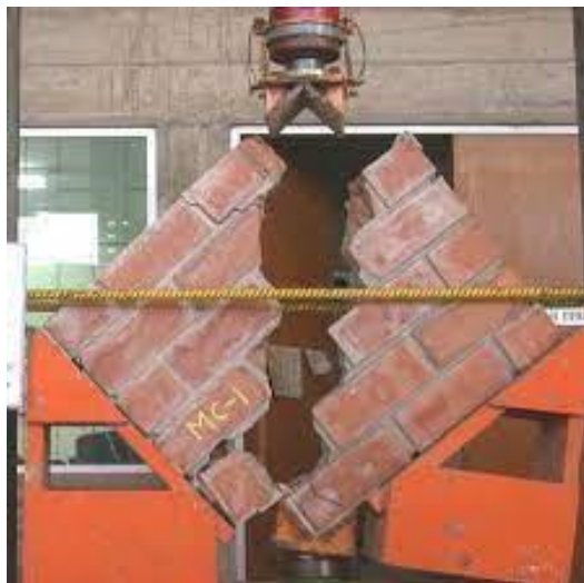
Figura 7: Ensayo de Resistencia a la compresión
