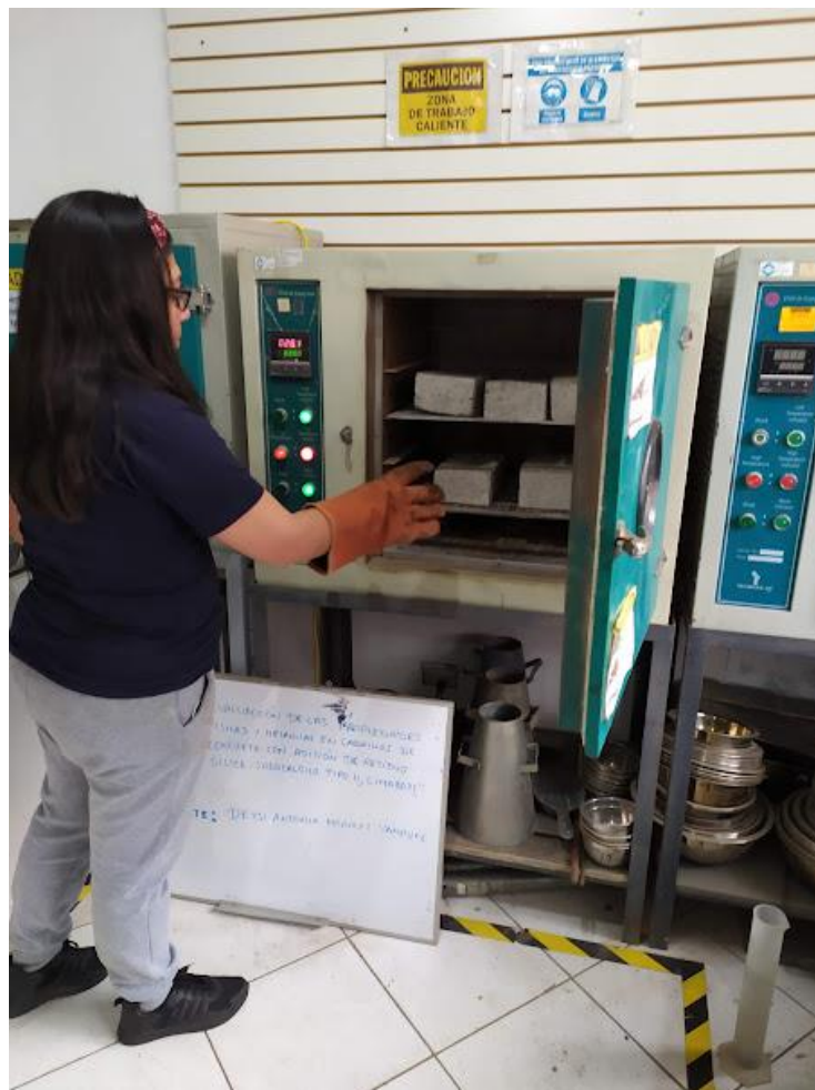
Figura 46: Secado por 24 horas de ladrillos para prueba de absorción
