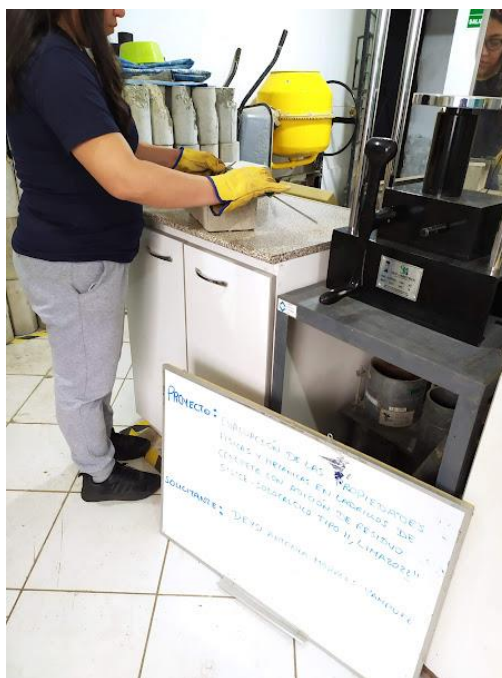
Figura 41: Ensayo de alabeo en ladrillo patrón 2, 4 y 6%
