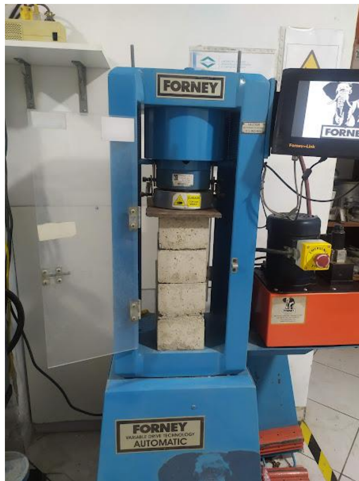
Figura 57: Ensayo de resistencia a la compresión de ladrillos en pilas con 2% de adición
