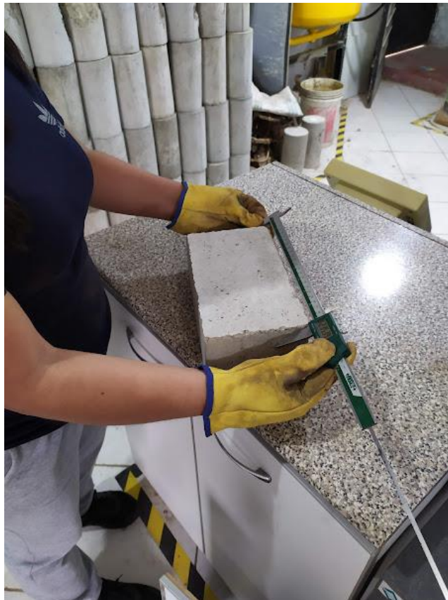
Figura 35: Ensayo de variación dimensional en ladrillo patrón 0%
