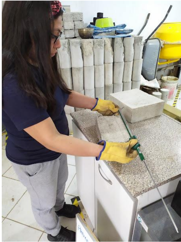
Figura 37: Ensayo de variación dimensional en ladrillo patrón 2,4 y 6%
