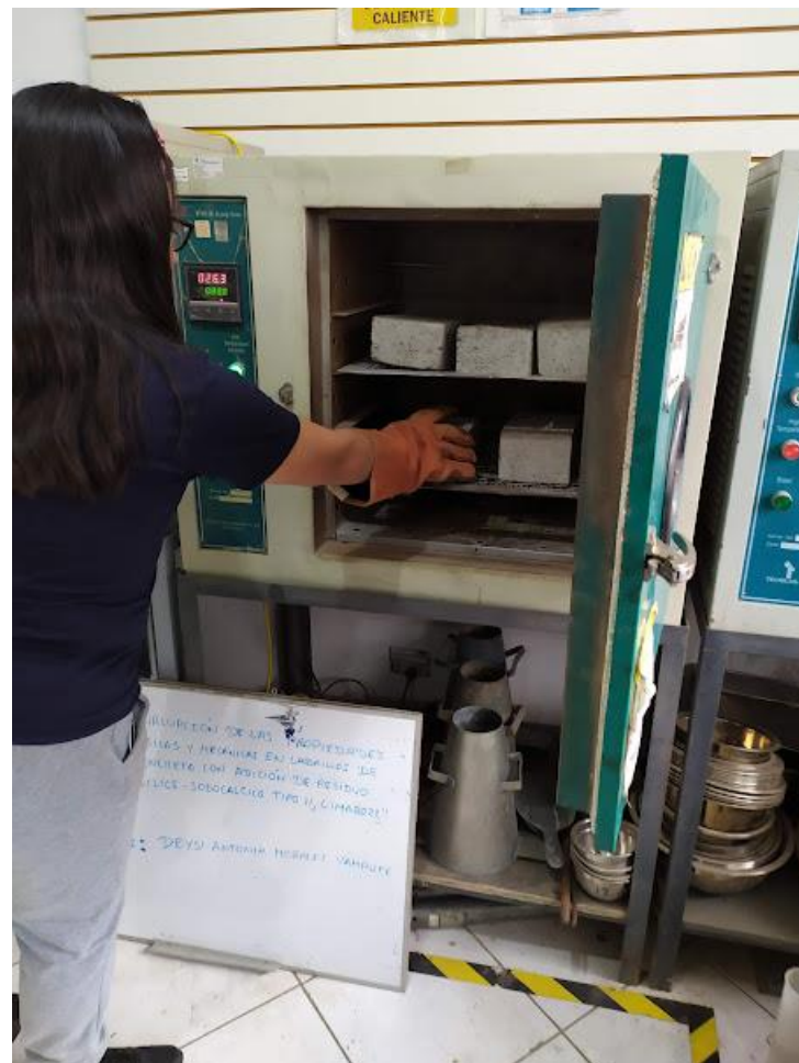
Figura 45: Secado por 24 horas de ladrillos para prueba de absorción
