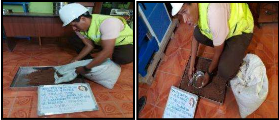
Figura 13: Extracción de muestra de suelo para realizar ensayo de contenido de humedad.
