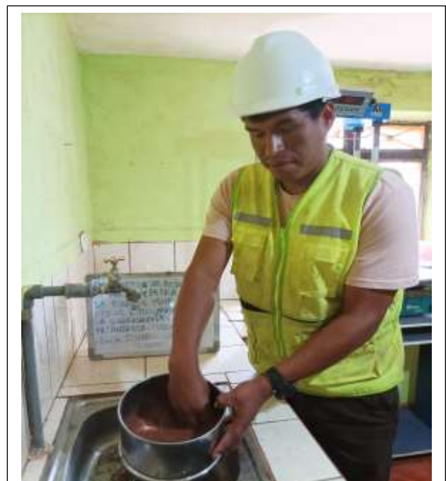
Preparación de porcentaje de muestra de suelo y posterior a esto el lavado para poder llevar al horno durante el tiempo establecido y hacer el ensayo de granulometría por tamizado.
