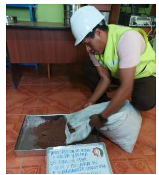
Trabajo de laboratorio - depositando material natural en envase y haciendo el cuarteo de dicho material.
