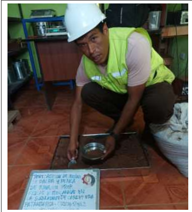
Selección de muestra natural para realizar el ensayo de contenido de humedad natural.
