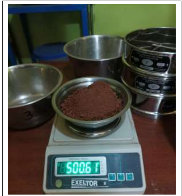
Selección de muestra natural para realizar el ensayo de contenido de humedad natural.
