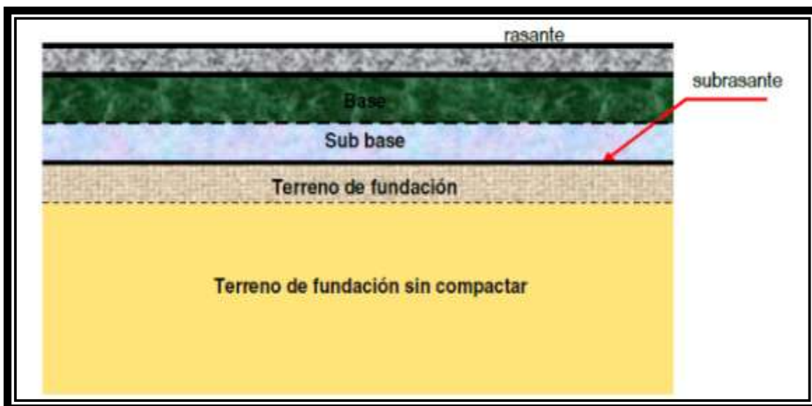
Figura 3: estructura típica de pavimento asfáltico
