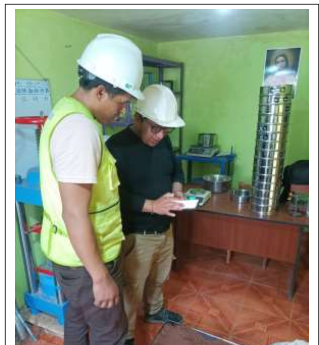
Trabajo de laboratorio - depositando material natural en envase y haciendo el cuarteo de dicho material.
