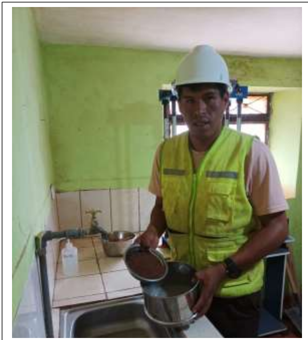
Preparación de porcentaje de muestra de suelo y posterior a esto el lavado para poder llevar al horno durante el tiempo establecido y hacer el ensayo de granulometría por tamizado.
