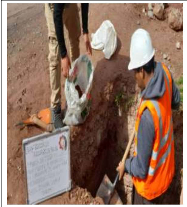
Ubicación y extracción de muestra de suelo de calicata.
