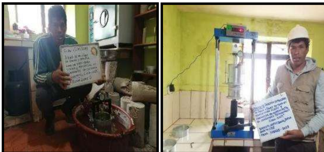
Figura 32: Ensayos de CBR en laboratorio.
