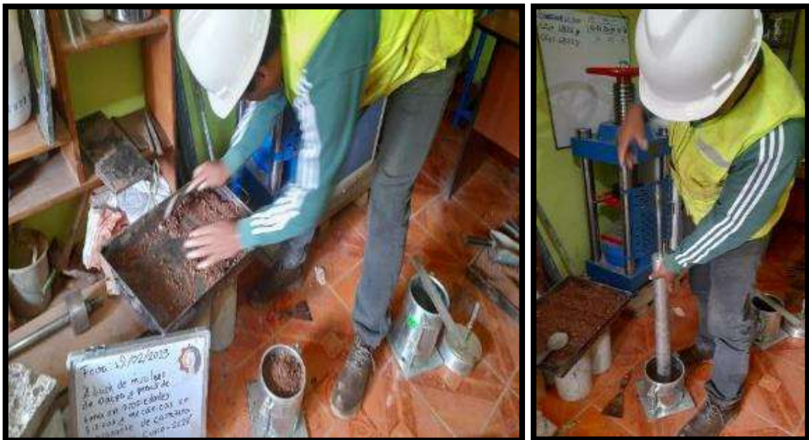
Figura 25: Compactación de muestra de suelo - ensayo Proctor Modificado.
