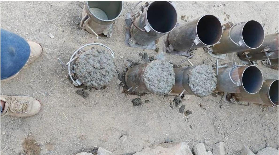
Foto 10. Elaboración de probetas de concreto  $f'c = 210 \text{ kg/cm}^2$
