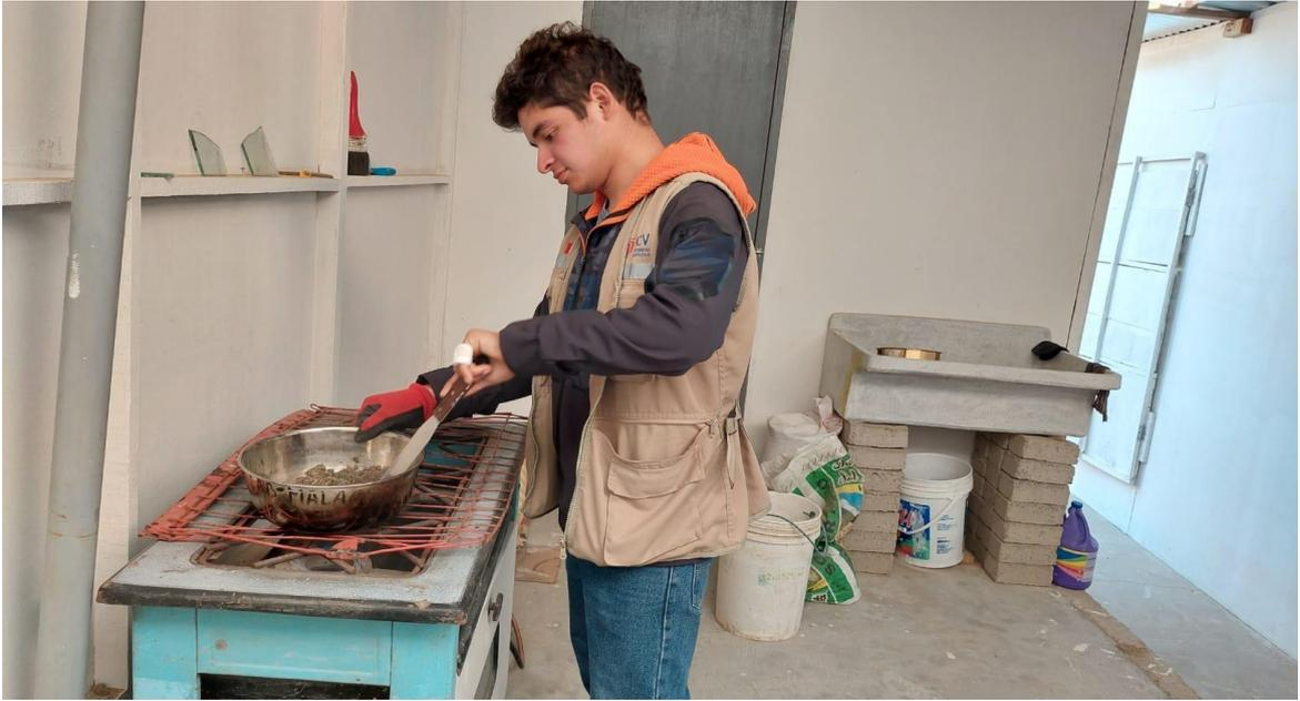
Foto 3. *Realización del ensayo de contenido de humedad*
