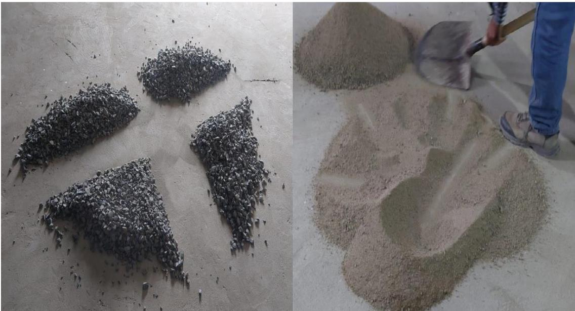
Foto 2. Cuarteo de los agregados para su caracterización
