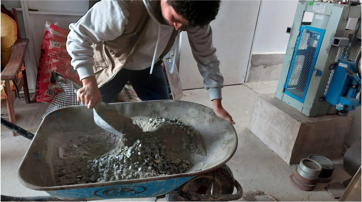
Foto 7. Mezclado manual para elaboración de concreto  $f'c = 210 \text{ kg/cm}^2$
