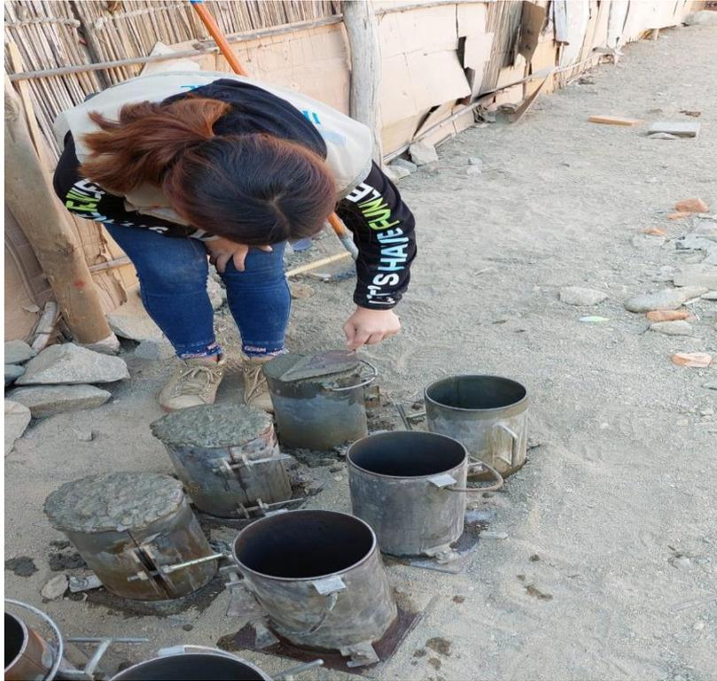
Foto 15. *Elaboración de probetas de concreto  $f'c = 210 \text{ kg/cm}^2$  con aditivo de 0.8% Sikament TM-120*
