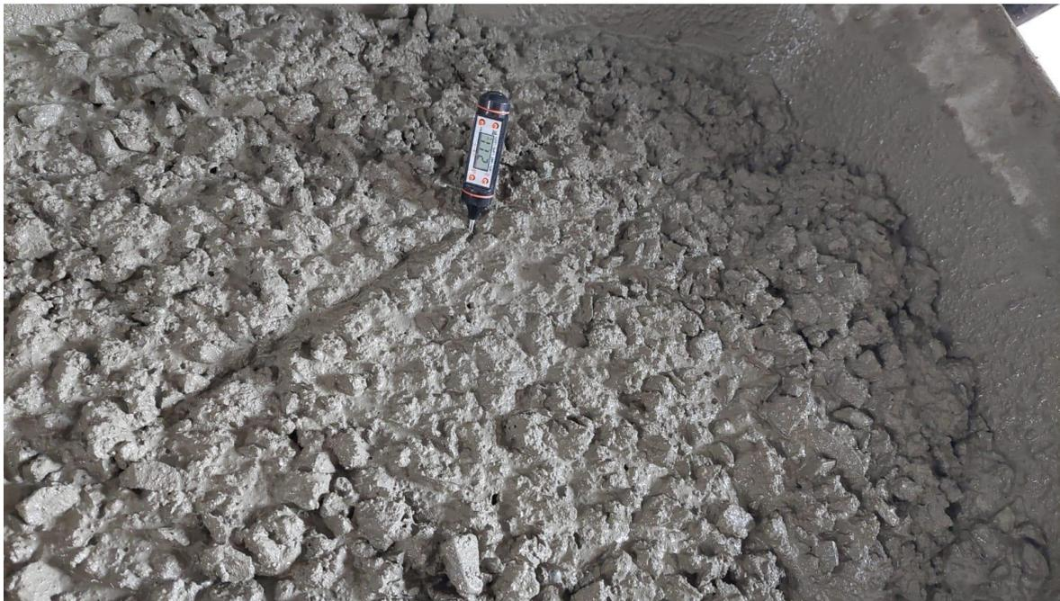
Foto 14. Toma de temperatura del concreto con aditivo de 0.8% Sikament TM-120
