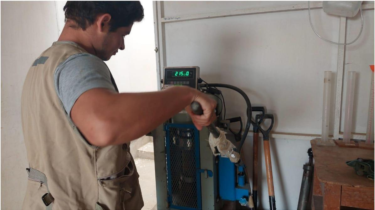
Foto 21. *Ensayo de resistencia a compresión de probetas de concreto  $f'c = 210$  kg/cm<sup>2</sup> con aditivo de 0.8% Euco 537*
