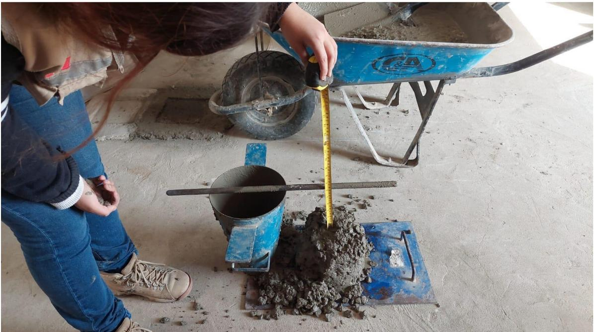
Foto 8. Slump para concreto de  $f'c = 210 \text{ kg/cm}^2$
