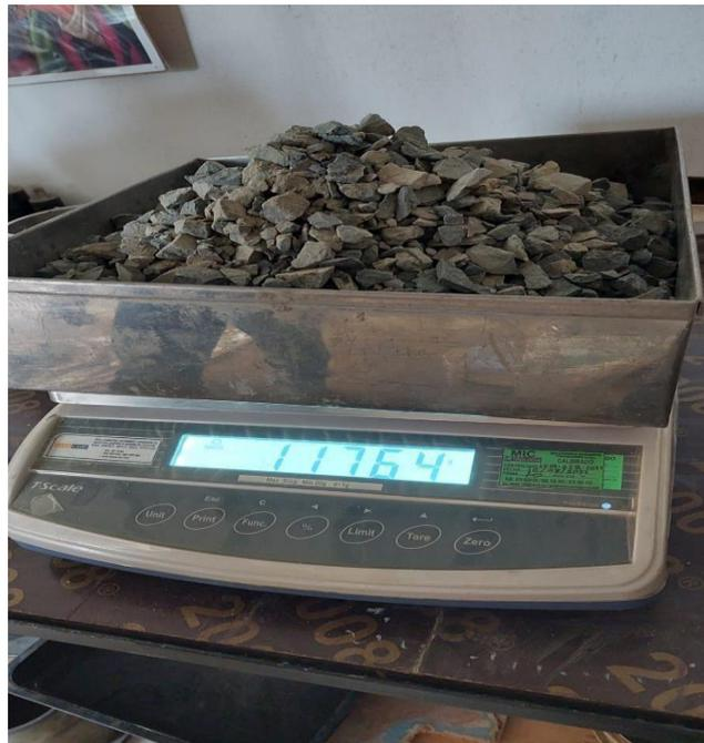
Foto 6. Registro del peso del agregado grueso
