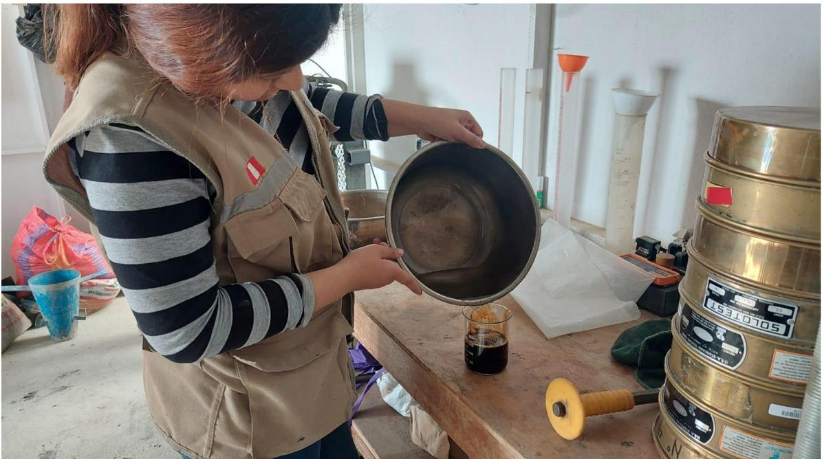
Foto 16. *Preparación de muestra aditivo súper plastificante Euco 537*
