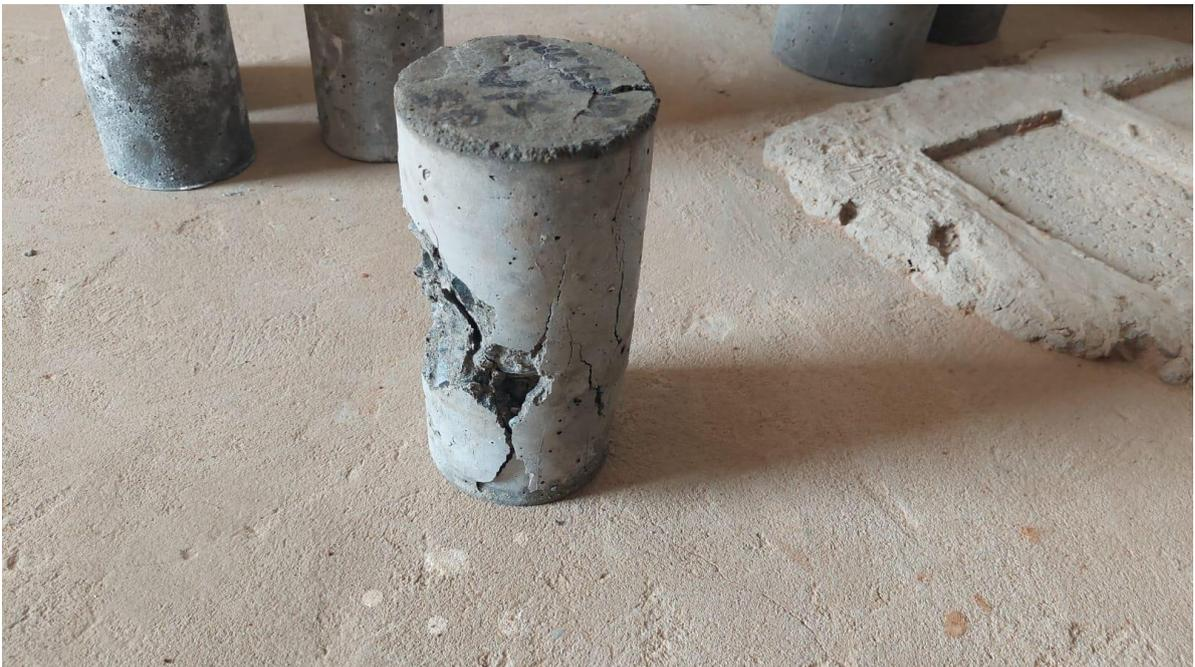
Foto 21. *Falla de la probeta de concreto  $f'c = 210$  kg/cm<sup>2</sup> con aditivo de 0.8% Euco 537*
