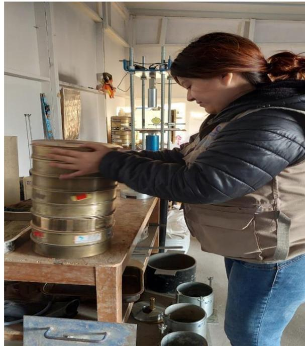
Foto 4. *Realización del ensayo granulométrico por tamizado*
