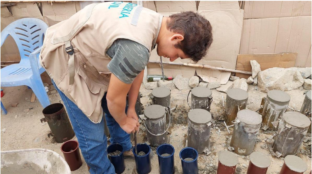
Foto 20. Elaboración de probetas de concreto  $f'c = 210 \text{ kg/cm}^2$  con aditivo de 0.8% Euco 537
