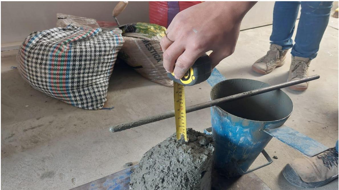
Foto 18. Slump para concreto  $f'c = 210 \text{ kg/cm}^2$  con la adición de A.S.P. Euco 537
