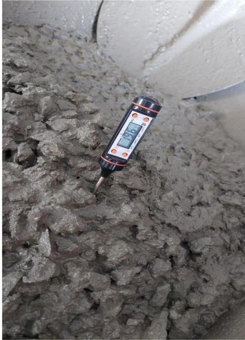
Foto 9. Toma de temperatura del concreto patrón relación  $a/c = 0.50$
