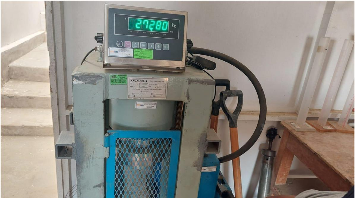
Foto 11. Ensayo de resistencia a compresión de concreto  $f'_c = 210 \text{ kg/cm}^2$
