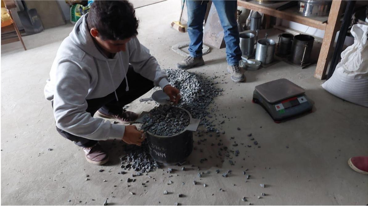
Foto 5. Realización del ensayo de peso unitario del agregado grueso
