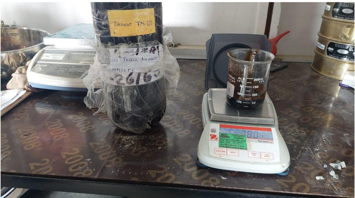
Foto 12. Pesado del super plastificante Sikament TM-120
