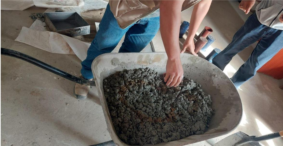
Foto 13. Adición del A.S.P. Sikament TM-120 al mezclado manual para elaboración de concreto  $f'c = 210 \text{ kg/cm}^2$
