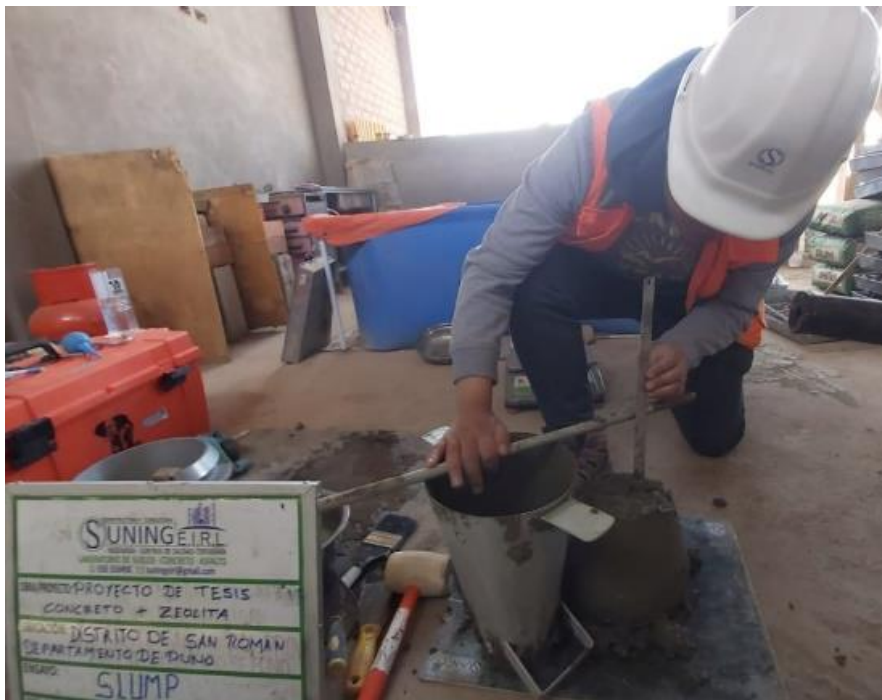
Fotografía 8 Prueba de asentamiento
