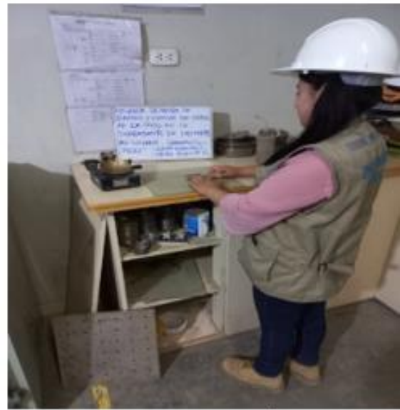
Figura N°22: Calculo del límite Plástico.
