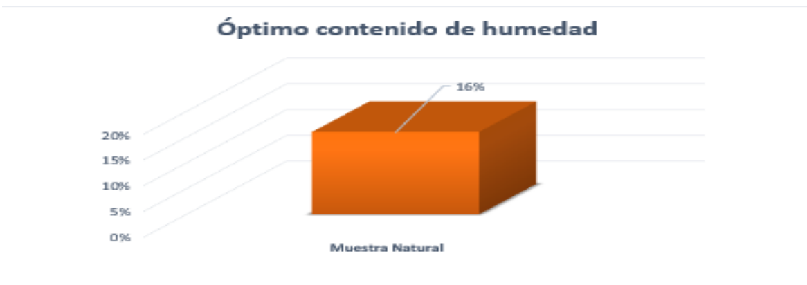
Figura N°18: Óptimo Contenido de Humedad de la muestra natural.
