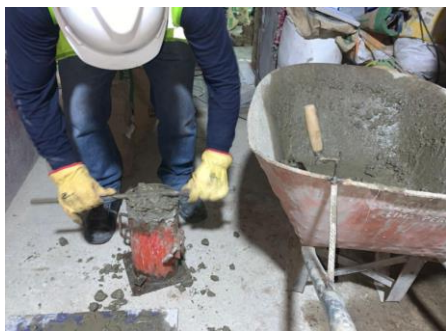
Figura 11. Elaboración de probeta. Figura 12. Ensayo compresión.
