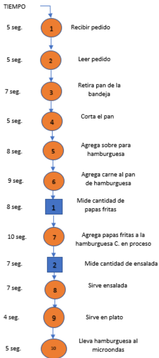
Figura 11. Diagrama de operaciones de un pedido de hamburguesa clásica en la empresa D'TODITO&+ (propuesta).
