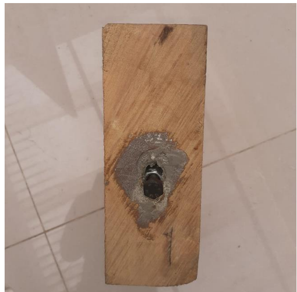
Figura. Durante el ensayo de resistencia al corte, se deflexa frente al esfuerzo, sin embargo el angulo que se forma es de 15°.
