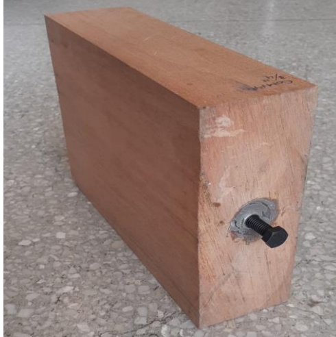
Figura 12. Muestra - 4: Longitud de anclaje de perno 3/4"
