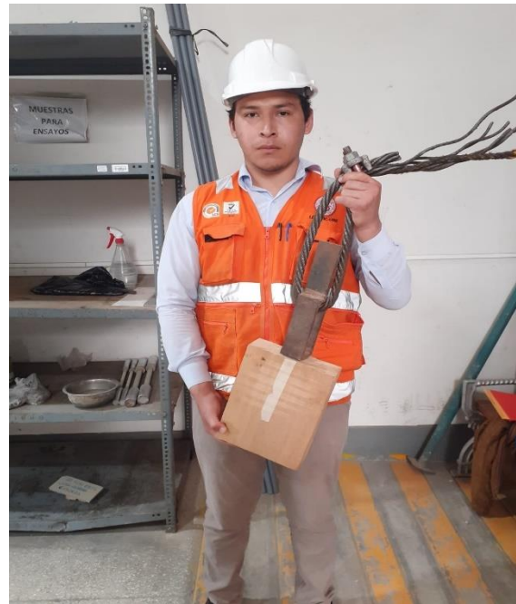
Figura 19. Muestra con dispositivo de ensayo de extracción
