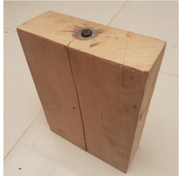
Figura. Durante el ensayo de cizallamiento por compresion la tuerca de acople se unde dentro de la muestras, produciendo cizalla en su interior.
