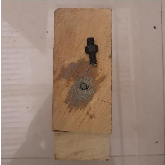
Figura. Rotura en la varilla roscada durante el ensayo de resistencia a la extracción.
