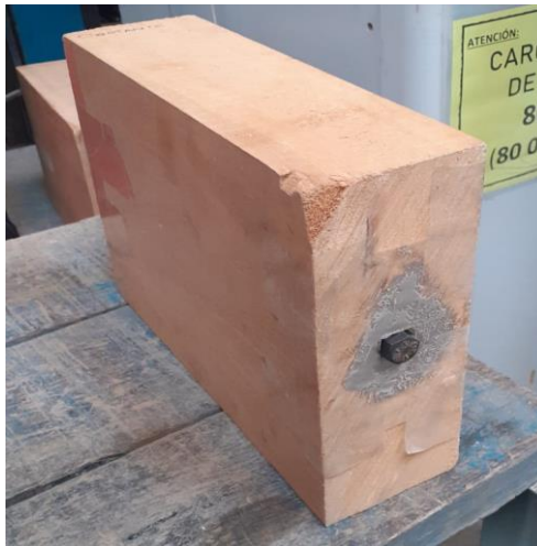
Figura 11. Muestra - 3: Longitud de anclaje de perno 1"
