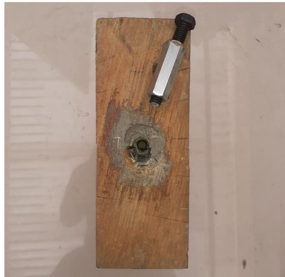
Figura. Rotura en la varilla roscada antes de la tuerca de acople durante el ensayo de resistencia a la extracción. La tuerca de acople no se adhiere con el epoxico a la madera.
