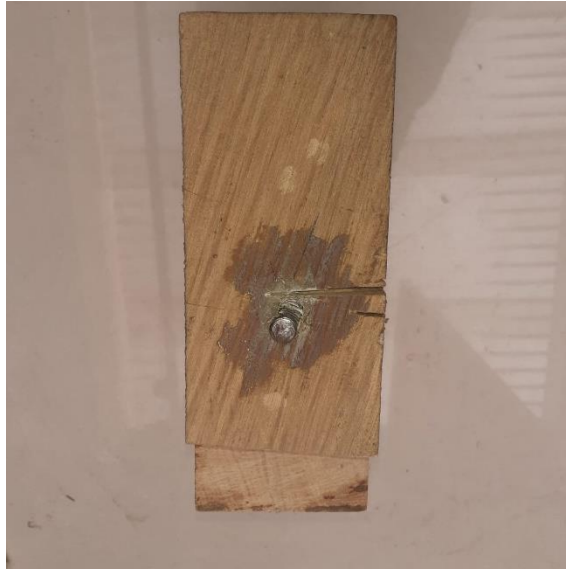
Figura. Durante el ensayo de cizallamiento por compresion la verilla roscada se se unde dentro de la muestras, mas no cizalla la muestra sino que comienza a curvarse en el interior.
