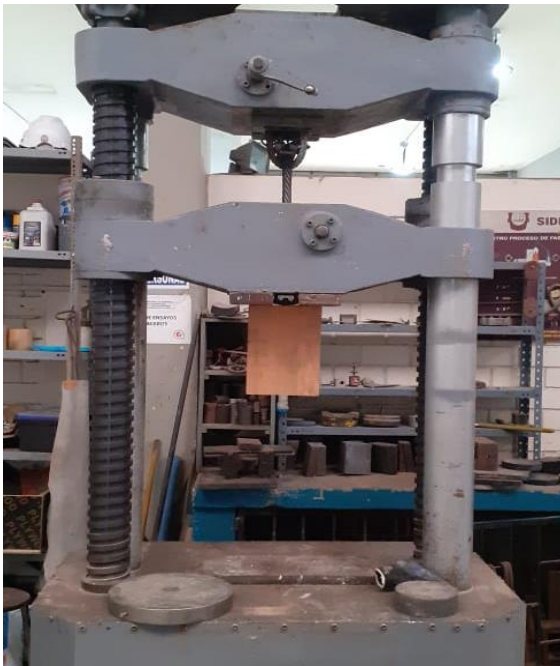
Figura 18. Muestra instalada para ensayo de extracción
