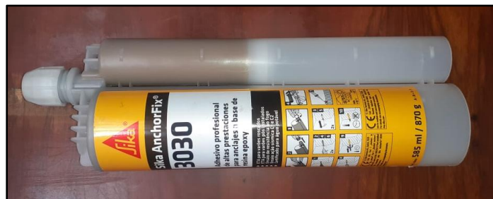
Figura 4. Cartucho de resina Anchorfix 3030 marca Sika empleado para el anclado del acople en las muestras de madera.
