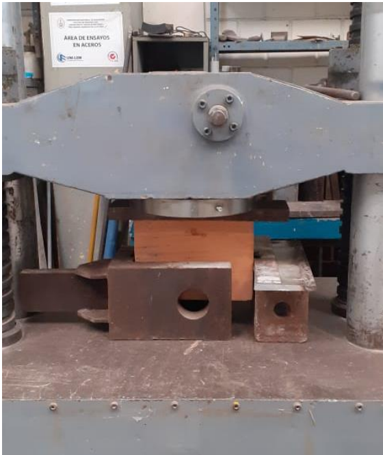
Figura 21. Ensayo de resistencia al corte en el acople
