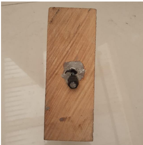
Figura. Durante el ensayo de resistencia a l corte la varilla roscada se deflexa creando un angulo de aproximadamente 30°.
