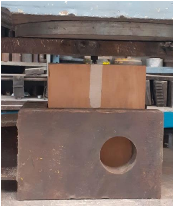
Figura 24. Ensayo de resistencia al cizallamiento por compresión Fuente: Elaboración propia
