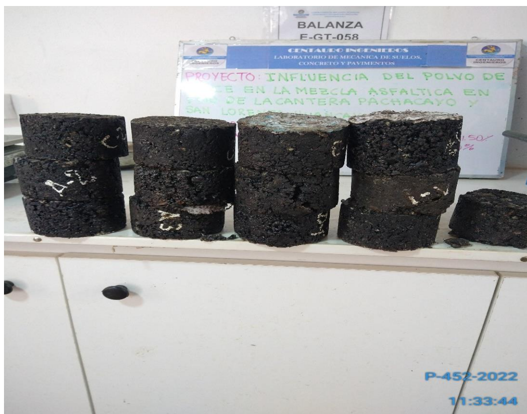
Fotografía N°14: Briquetas analizadas para la estabilidad, flujo y densidad
