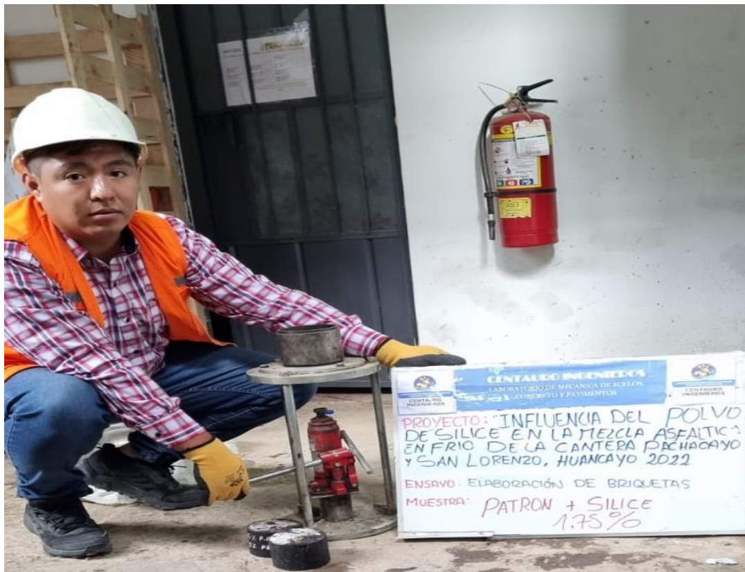
Fotografía N°12: Extracción de briquetas
