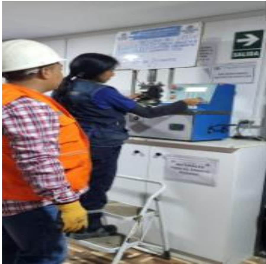
Fotografía N°15: Rotura de briquetas
