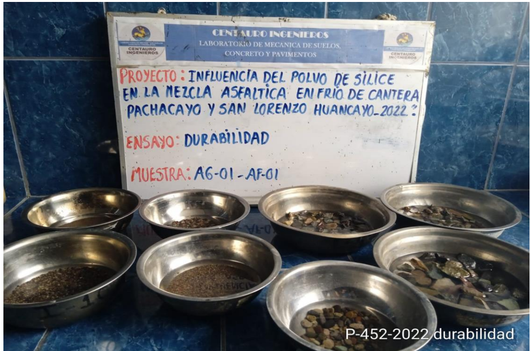
Fotografía N°08: Ensayo de durabilidad al sulfato de magnesio de agregados
